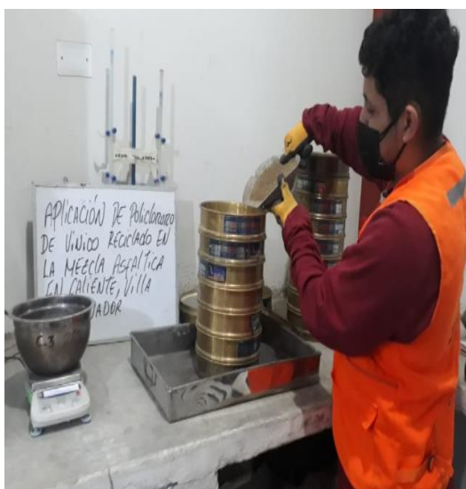
Figura 6. Tamizado del agregado fino
