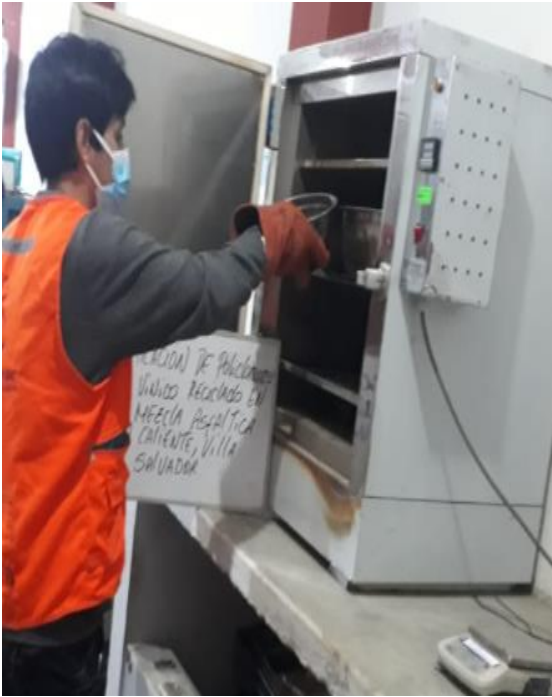
Figura 16. Muestra del agregado grueso en el horno
