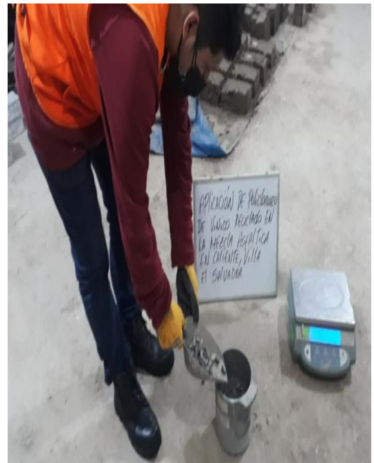
Figura 8. Preparación del agregado grueso
