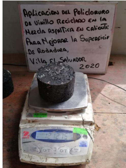
Figura 16. Peso específico de la briqueta
