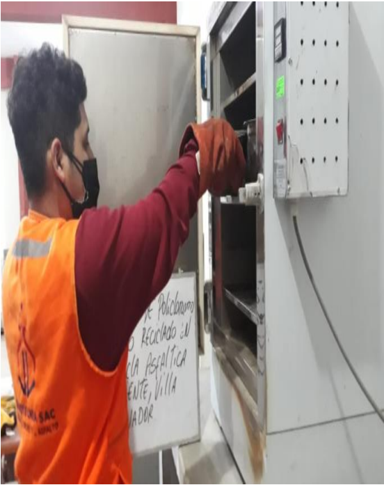
Figura 15. Muestra del agregado fino en el horno
