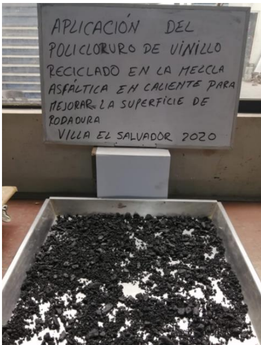
Figura 25. Muestra suelta para gravedad Específica
