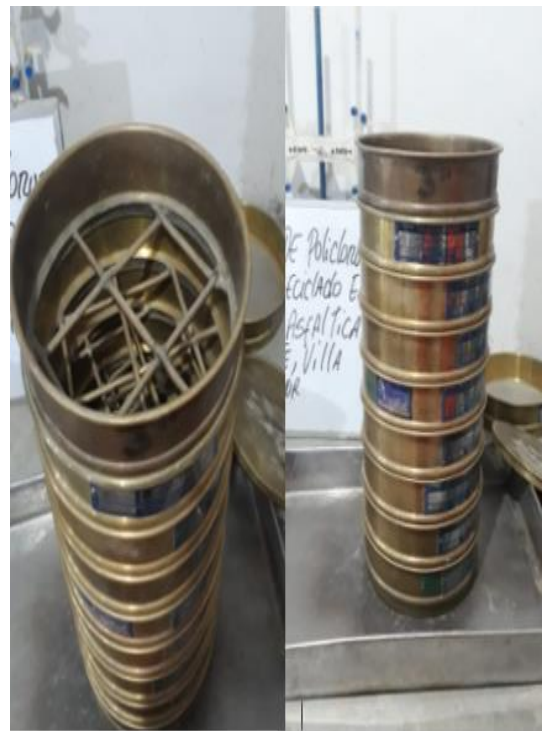
Figura 12. Tamiz del agregado grueso
