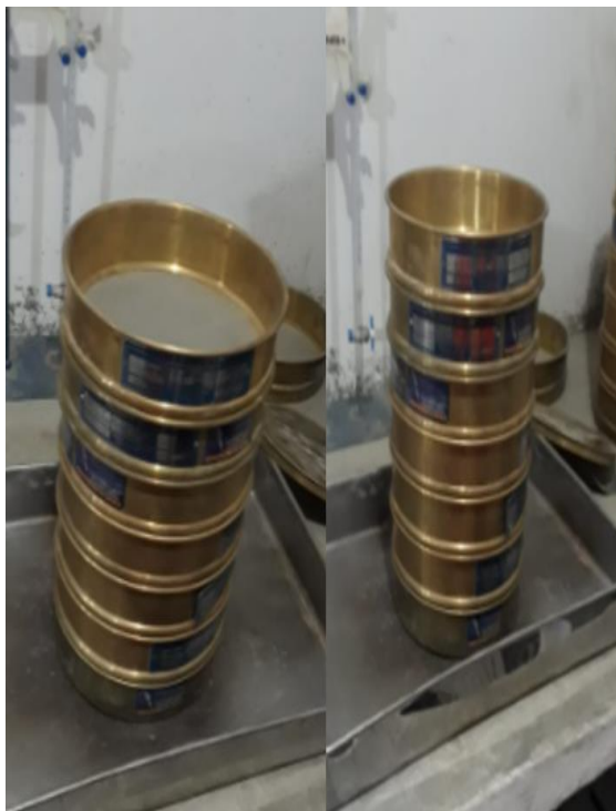
Figura 11. Tamiz del agregado fino
