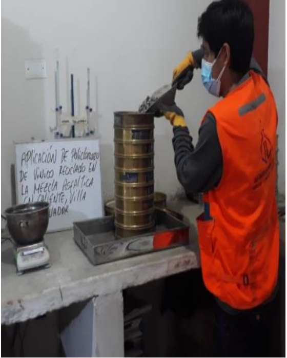
Figura 14. Tamizado del agregado grueso
