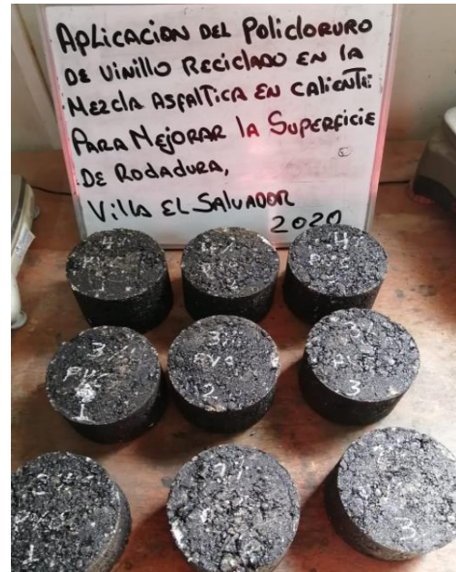
Figura 9. Agregados con adición de pvc Figura 10. Briquetas con adición de pvc
