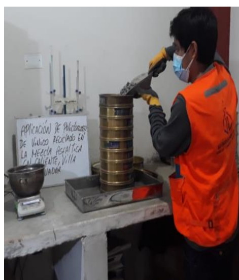
Figura 7. Tamizado del agregado grueso
