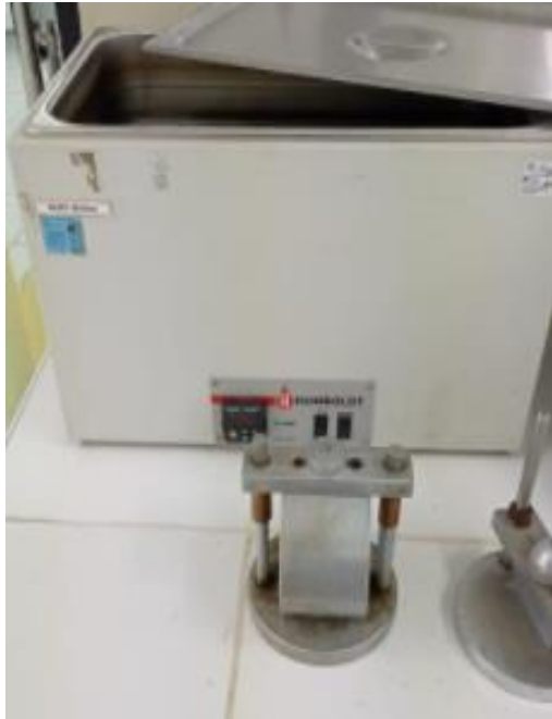
Figura 15. Recipiente de vacío sumergido
