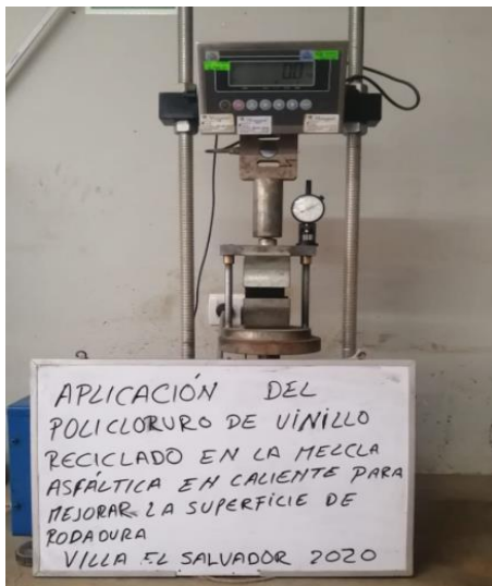
Figura 18. Prensa Marshall para Prueba de fluencia
