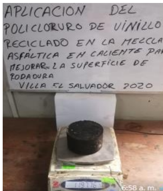
Figura 8. Briqueta para diseño convencional
