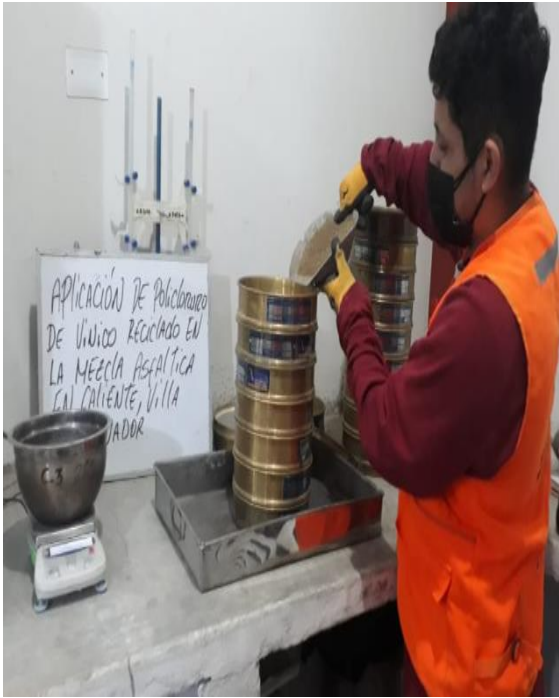
Figura 13. Tamizado del agregado fino
