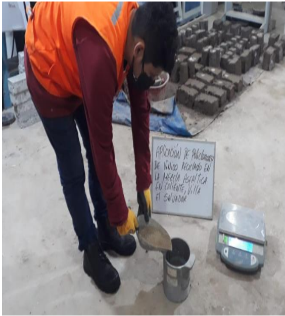
Figura 9. Preparación del agregado fino
