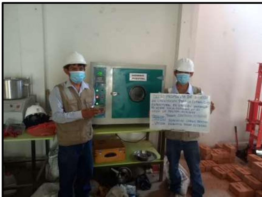
**ENSAYO DE CONTENIDO DE HUMEDAD**
