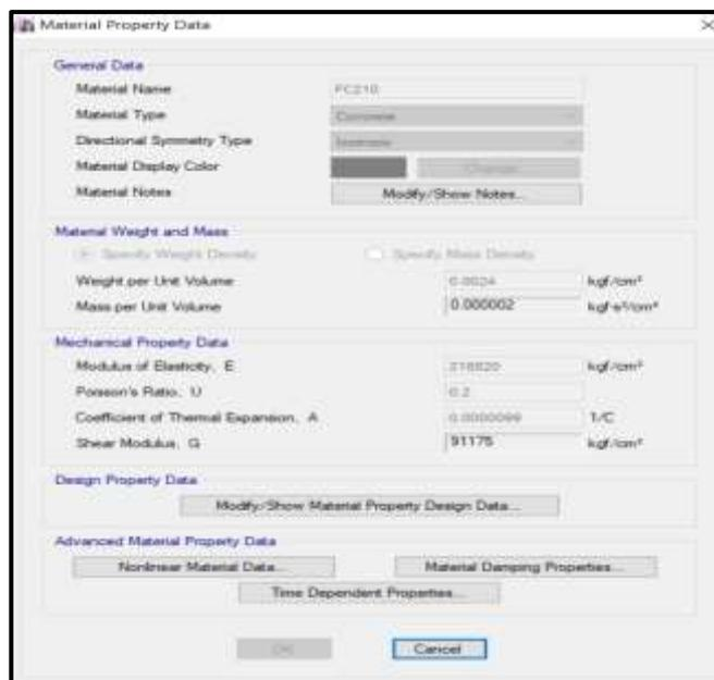
**Figura 21.** Resistencia del concreto a compresión, Para Columnas y Vigas
