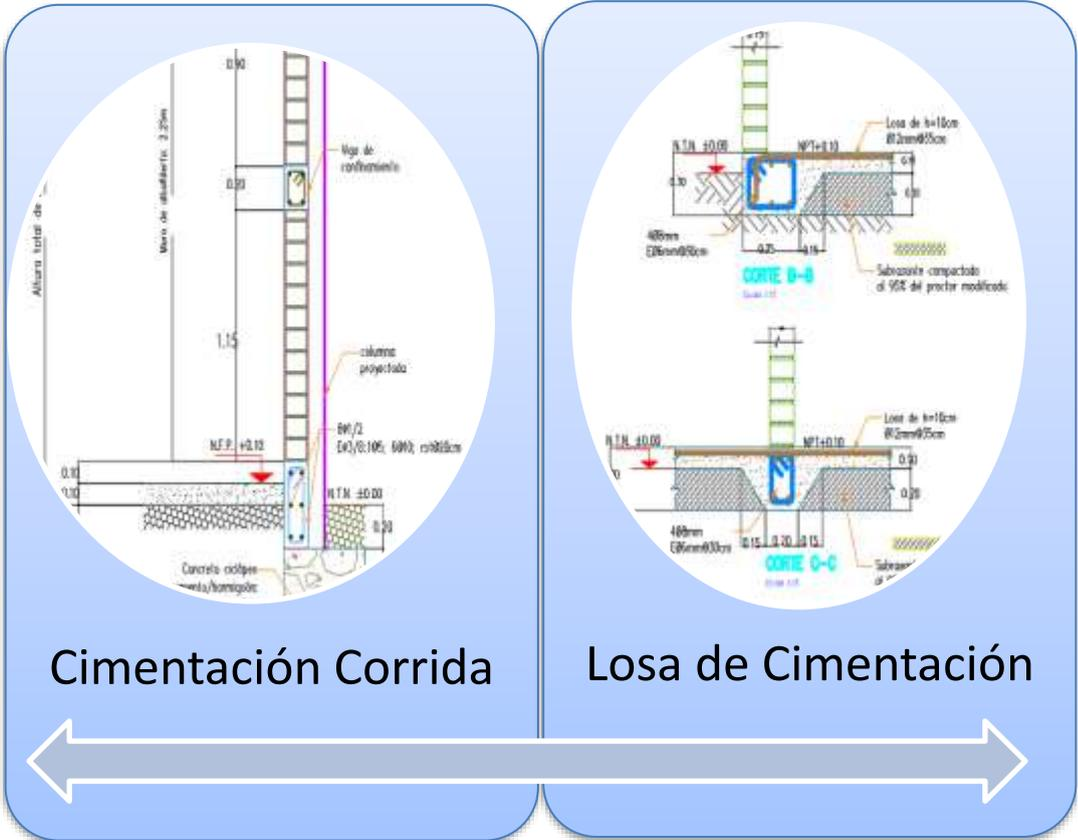
**Figura 18.** Cimentación Corrida y Losa de Cimentación.
