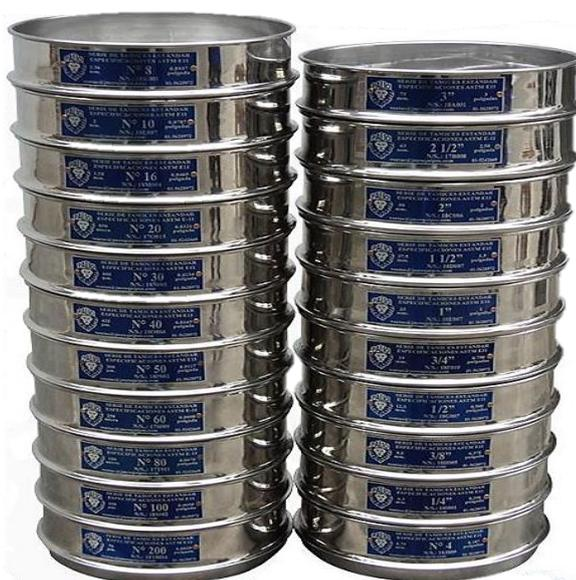
Figura 7. Serie de tamices según norma ASTM D422.
