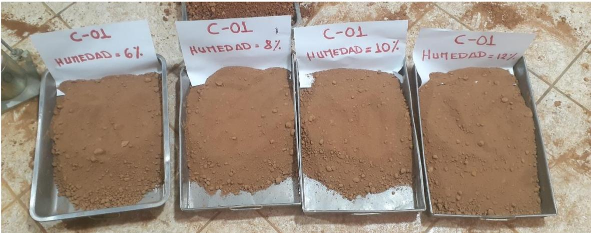
Figura 89. Muestras de suelo para ensayo de Proctor modificado C-01.
