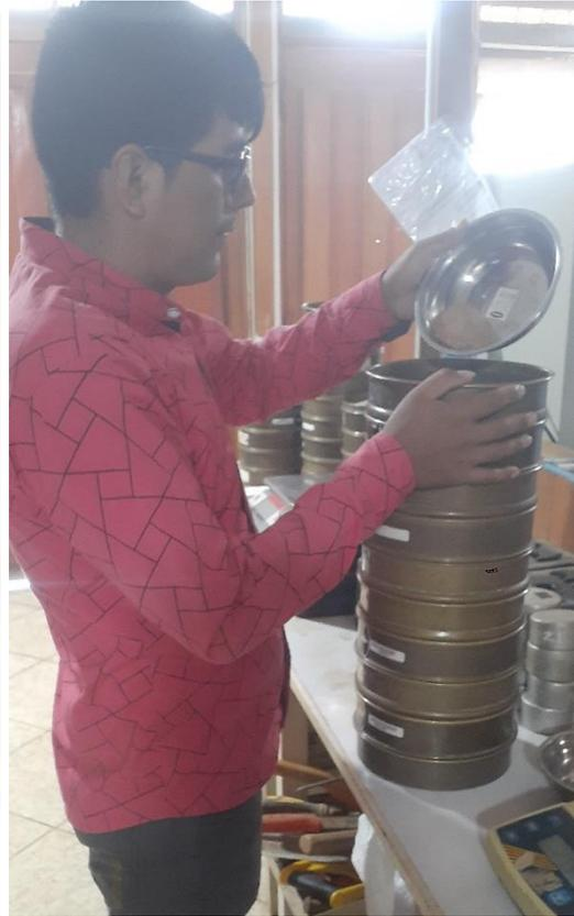
Figura 85. Equipos y vertido de la muestra lavada en tamices.
