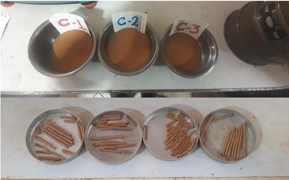
Figura 87. Muestra tamizado y ensayo de límite plástico.
