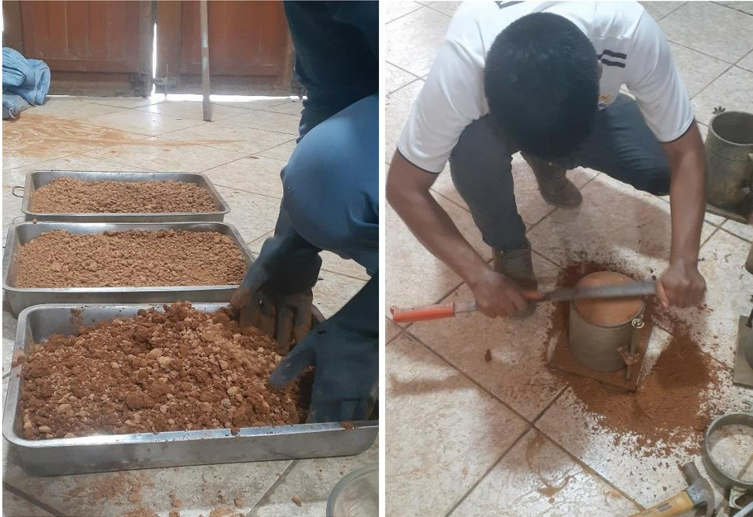
*Figura 97.* Mezclado y compactado en molde CBR – suelo natural.
