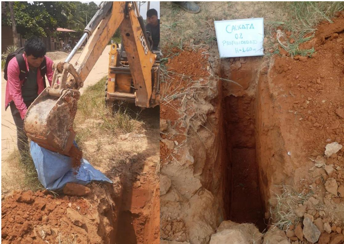
*Figura 80. Extracción de muestra, profundidad de 1.60 m. (Calicata – 02).*
