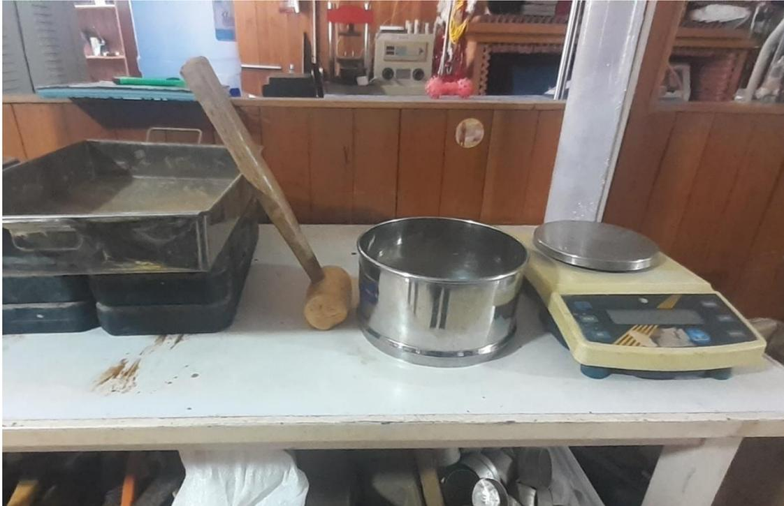
*Figura 83. Materiales y equipos para el análisis granulométrico.*
