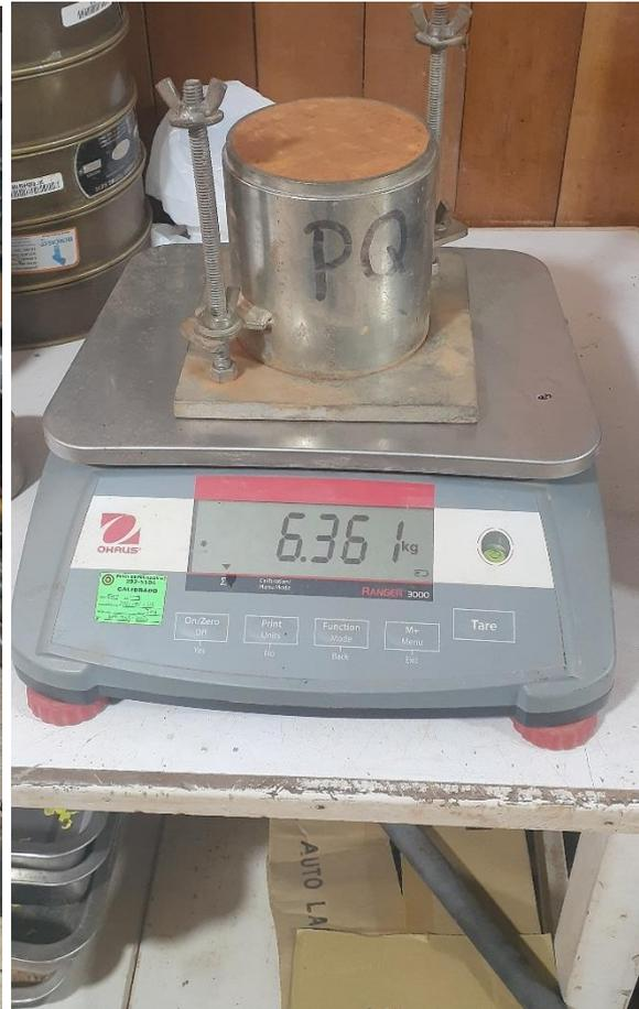
Figura 93. Compactado y pesado del ensayo de Proctor modificado.
