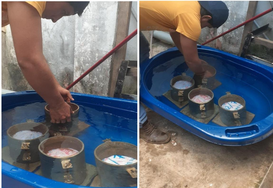
*Figura 98.* Sumergido respectivo de moldes de CBR.
