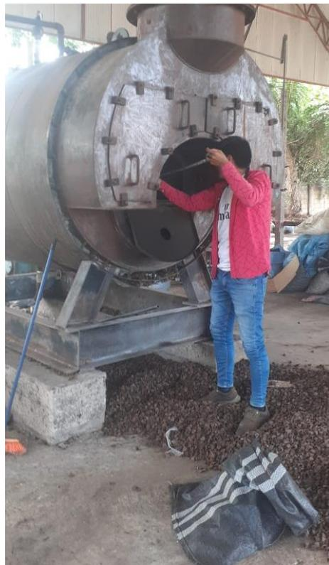
*Figura 76.* Extracción de ceniza de cascara de castaña.
