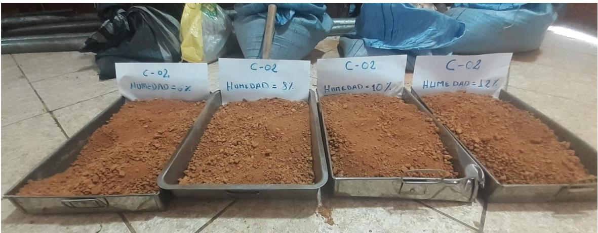
Figura 90. Muestras de suelo para ensayo de Proctor modificado C-02.
