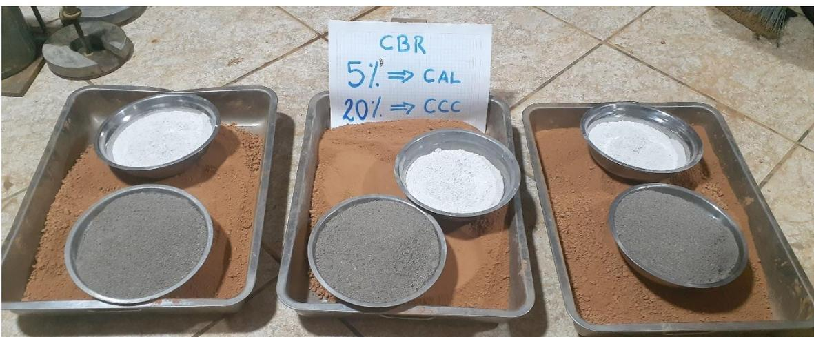
Figura 105. Muestra de suelo 5% cal y 20% CCC para ensayo de CBR.
