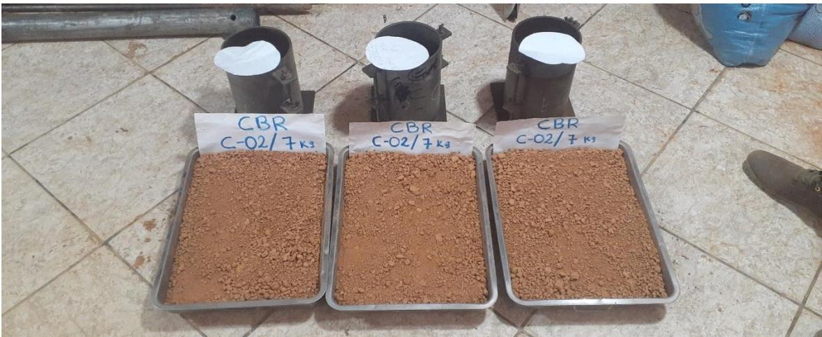
Figura 95. Muestras de suelo para ensayo de CBR C-03.
