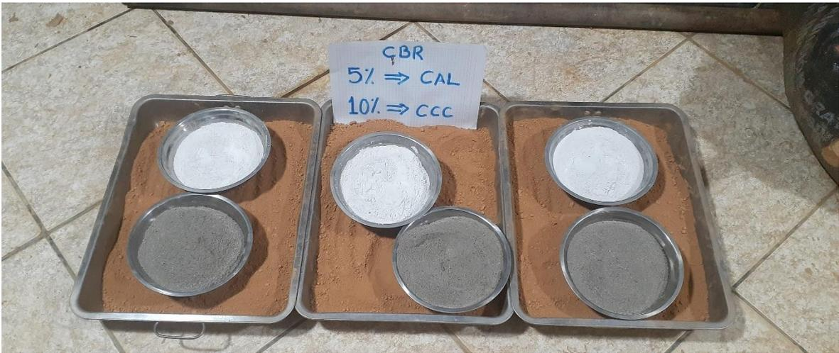
Figura 103. Muestra de suelo 5% cal y 10% CCC para ensayo de CBR.
