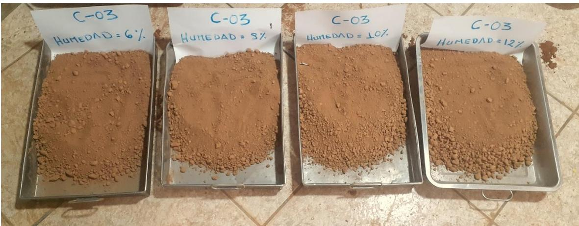
Figura 91. Muestras de suelo para ensayo de Proctor modificado C-03.
