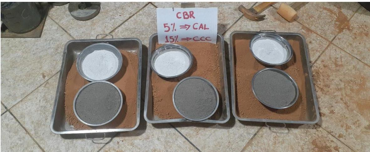
Figura 104. Muestra de suelo 5% cal y 15% CCC para ensayo de CBR.
