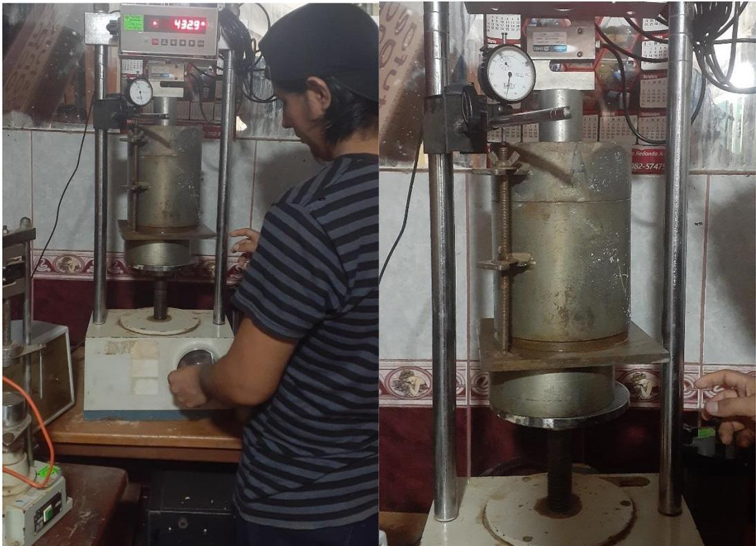
*Figura 109.* Penetración de los Moldes de CBR con Cal y CCC.
