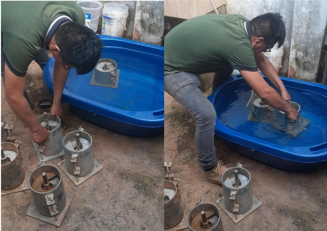
*Figura 108.* Sumergido de los Moldes de CBR con Cal y CCC.
