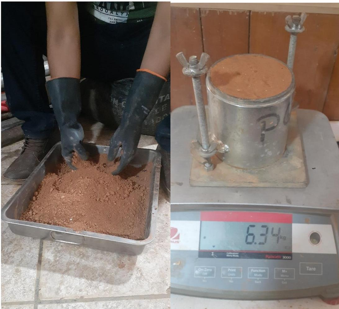
Figura 102. Mezclado y pesado de suelo con cal y ceniza.
