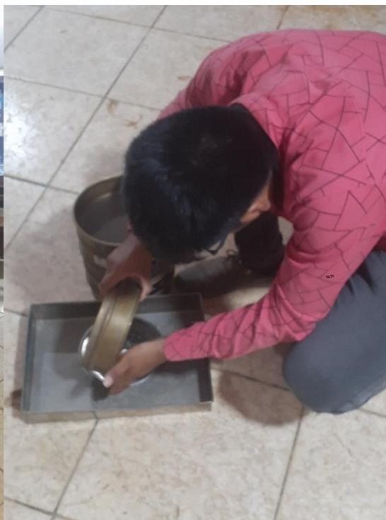
Figura 86. Tamizado y pesado de la muestra por cada # de malla pasante.
