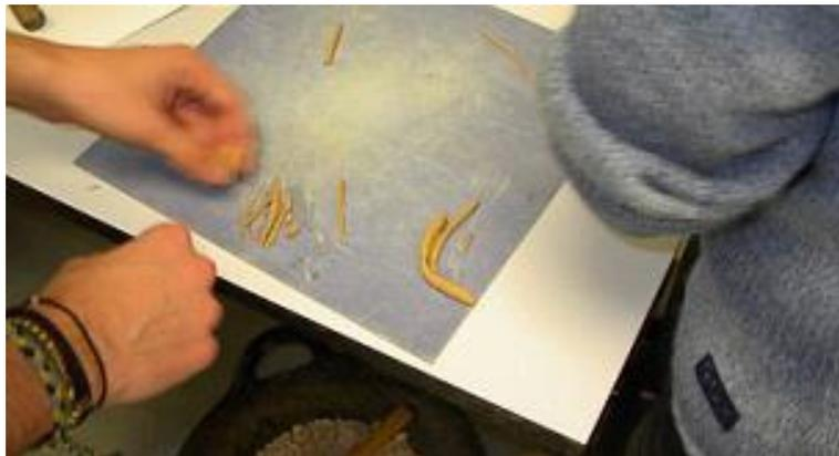
Figura 11. Ensayo del límite plástico en laboratorio.
