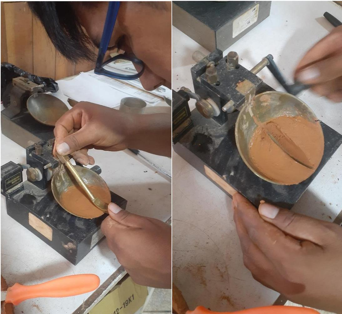
Figura 111. Ensayo de límite líquido del suelo con cal y ceniza.
