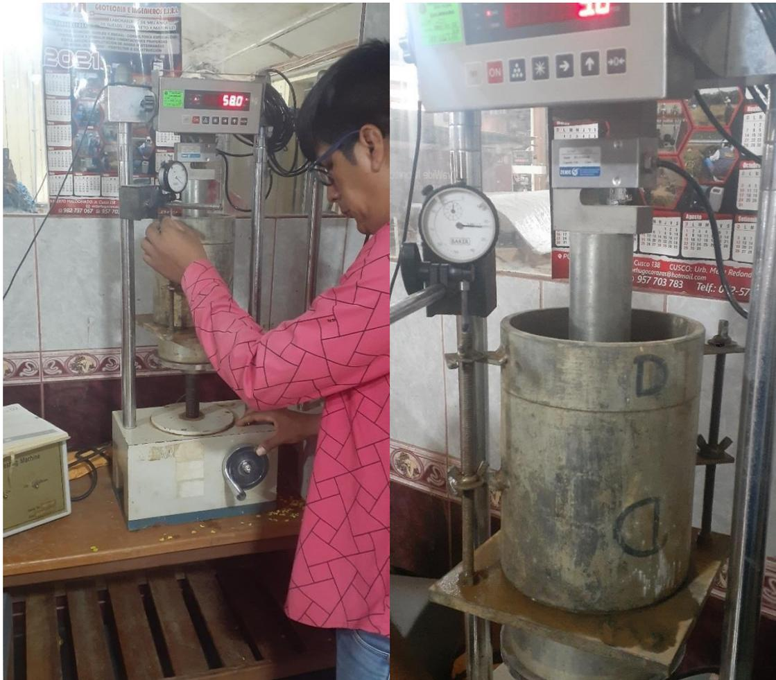
Figura 100. Precisos momentos de la penetración de molde CBR.
