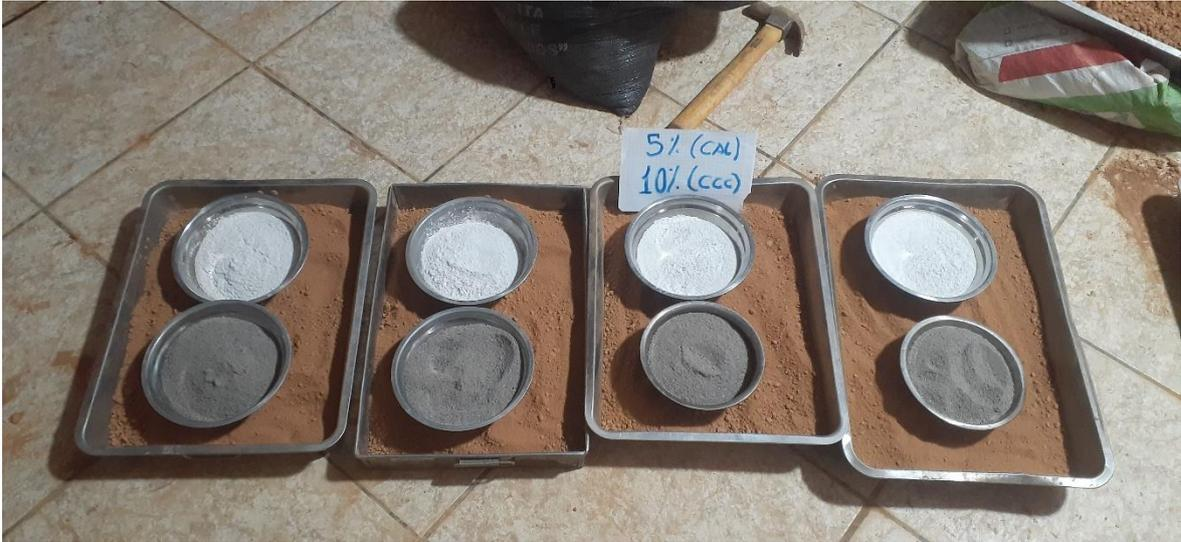
Figura 101. Muestras de suelo con cal y CCC para Proctor modificado.
