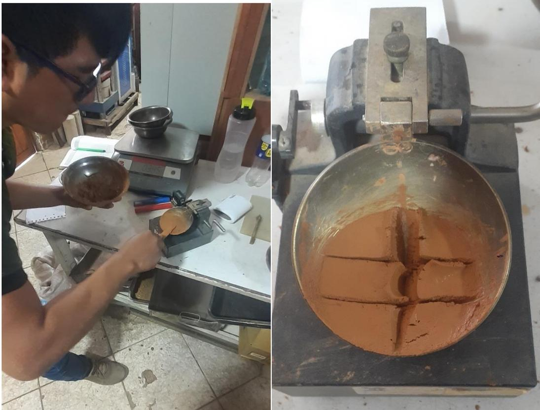
Figura 88. Ensayo de límite plástico – casa grande.
