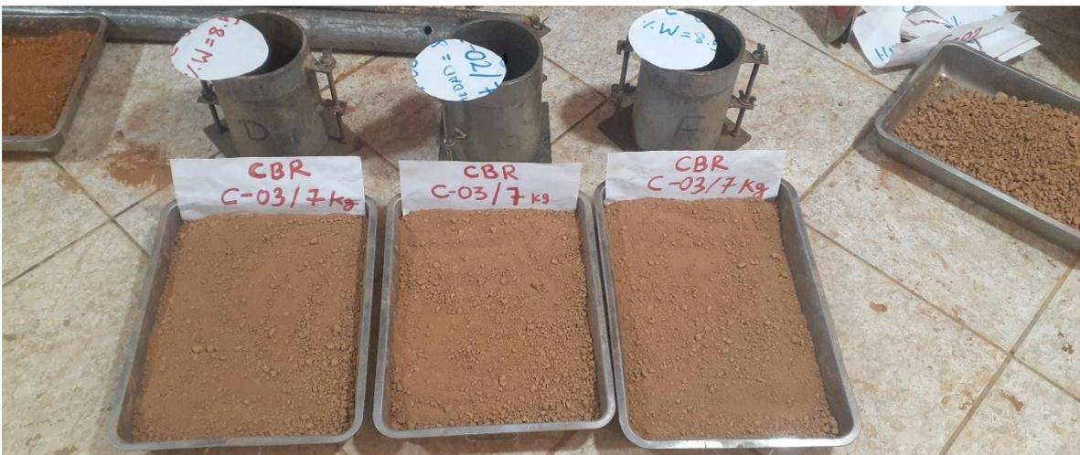
Figura 96. Muestras de suelo para ensayo de CBR C-03.
