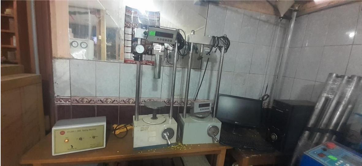
Figura 99. Equipo para la lectura de penetración de CBR.
