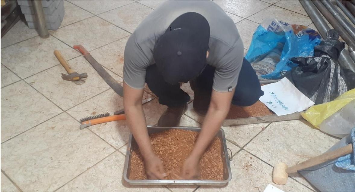
Figura 92. Mesclado de agua + suelo para el ensayo de Proctor modificado.
