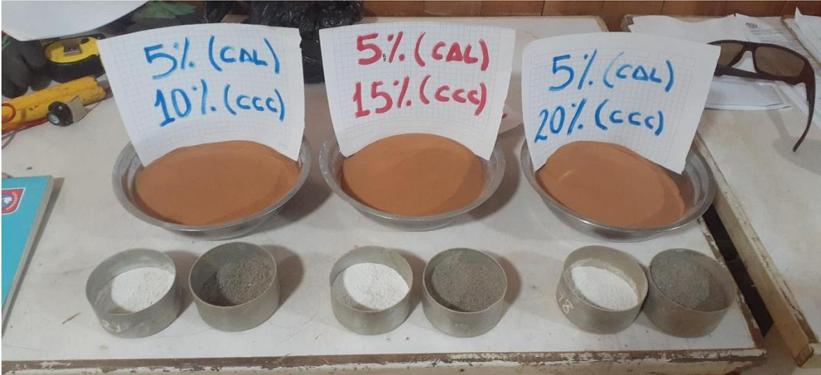
Figura 110. Muestra para límites de consistencia del suelo con cal y ceniza.
