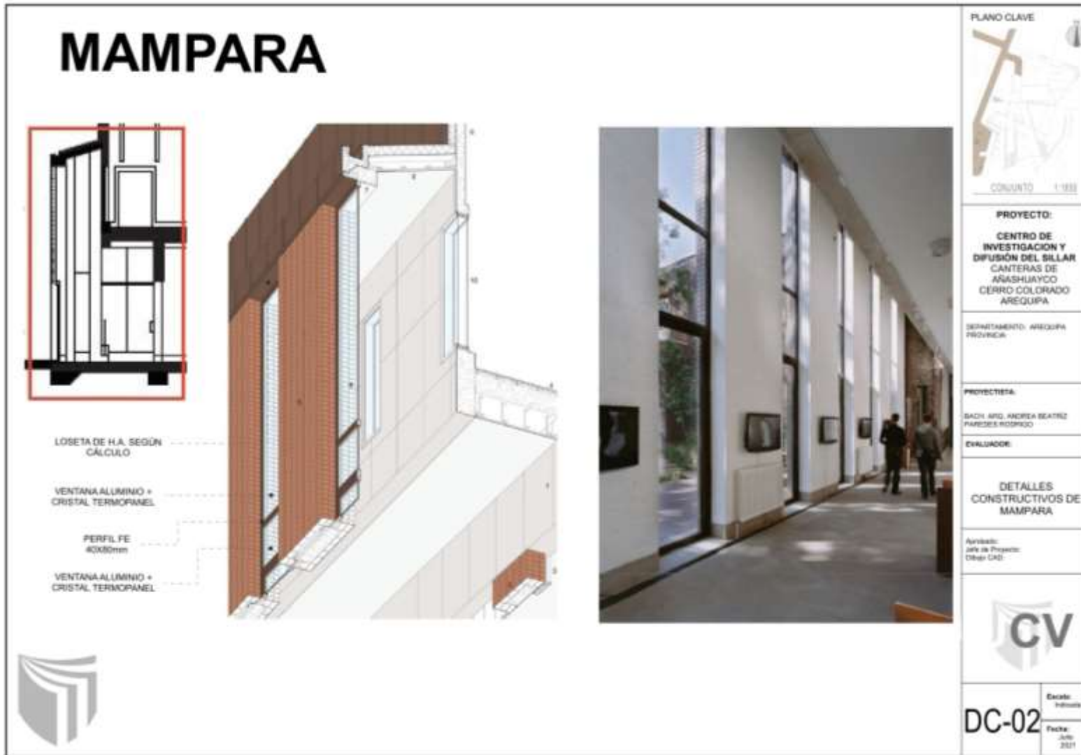
Figura 106 Plano de Detalles de mampara sector- DA 02
