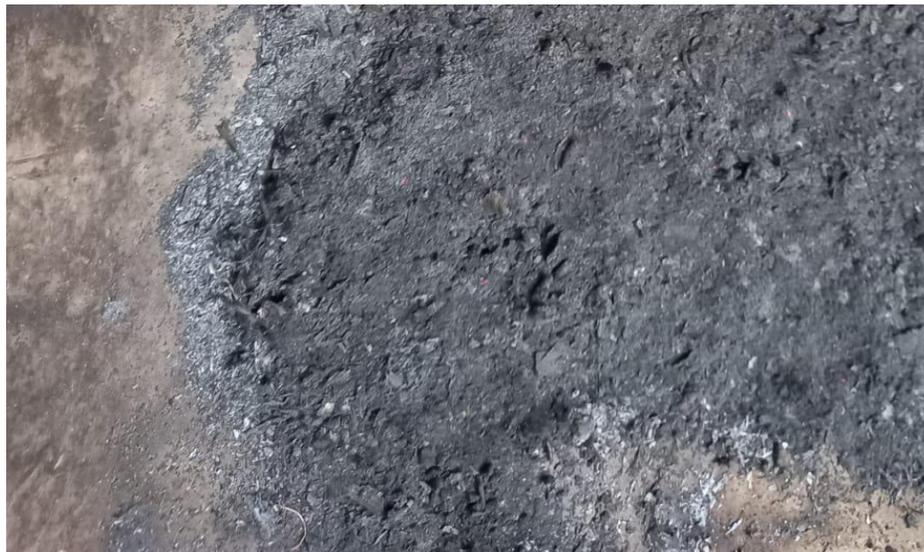
**Figura 11** Obtención de ceniza de BCA y panca de maíz
