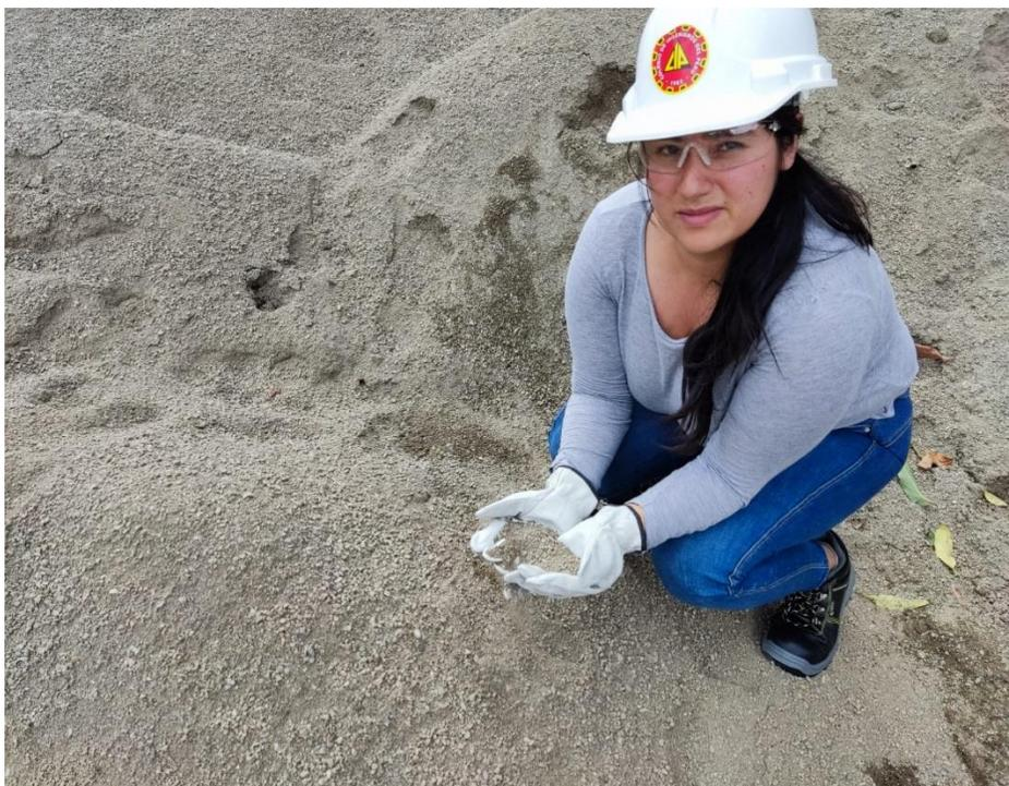
**Figura 14** Fotografía del muestreo del agregado fino
