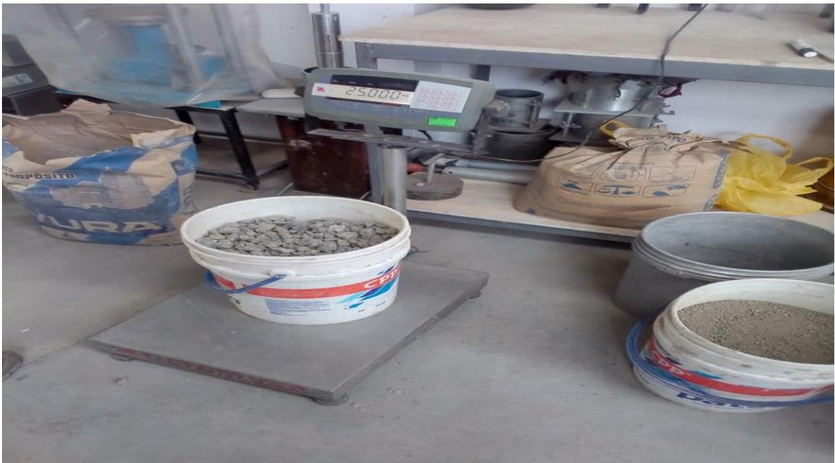
**Figura 17** Pesado de los agregados
