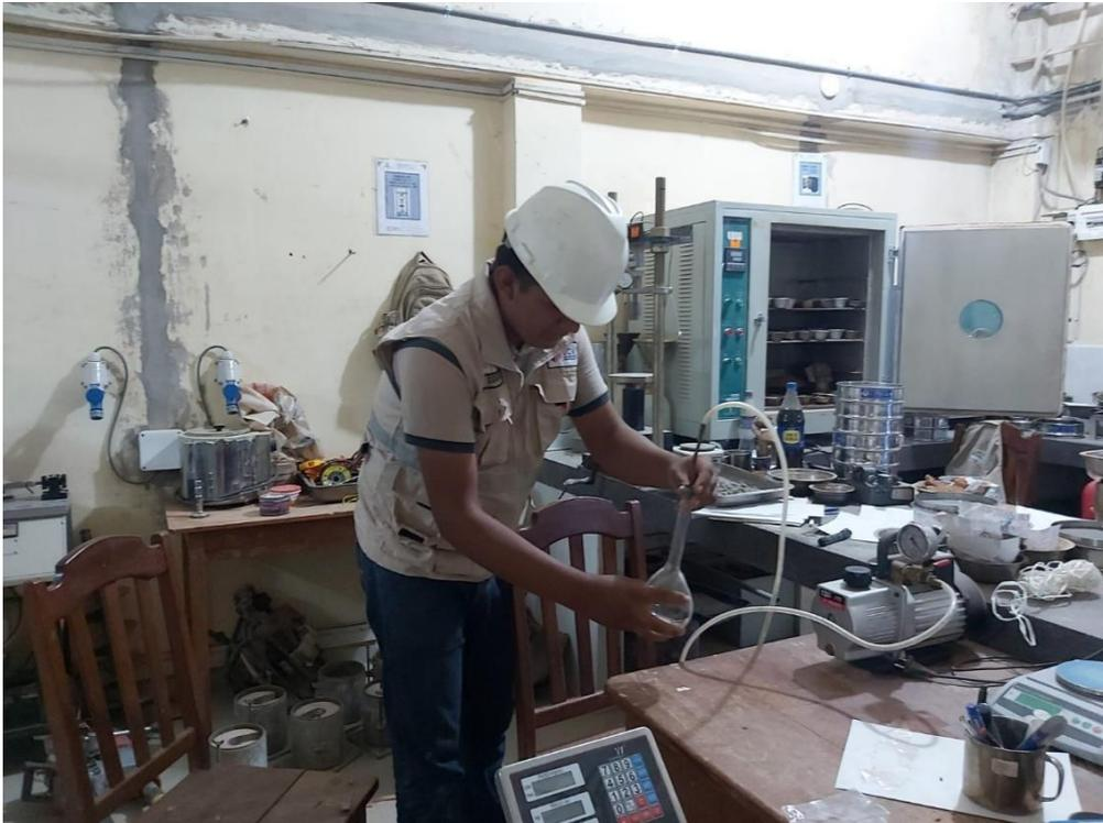
Fotografía N° 08. Determinación del peso superficialmente seco del agregado
