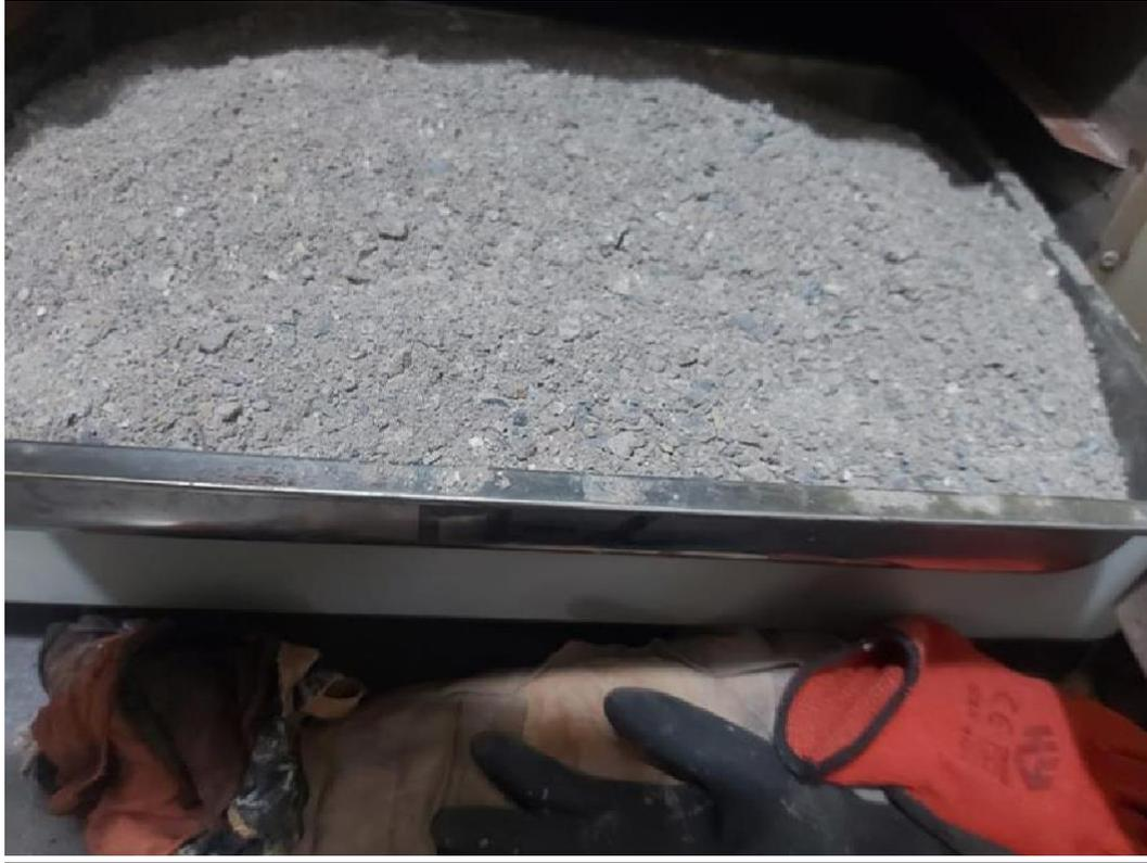
Fotografía N° 02. Secado del material al horno de 110+-5° C
