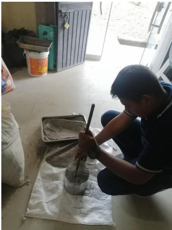
Fotografía N° 06. Prueba para humedad superficial AF. (SSS)
