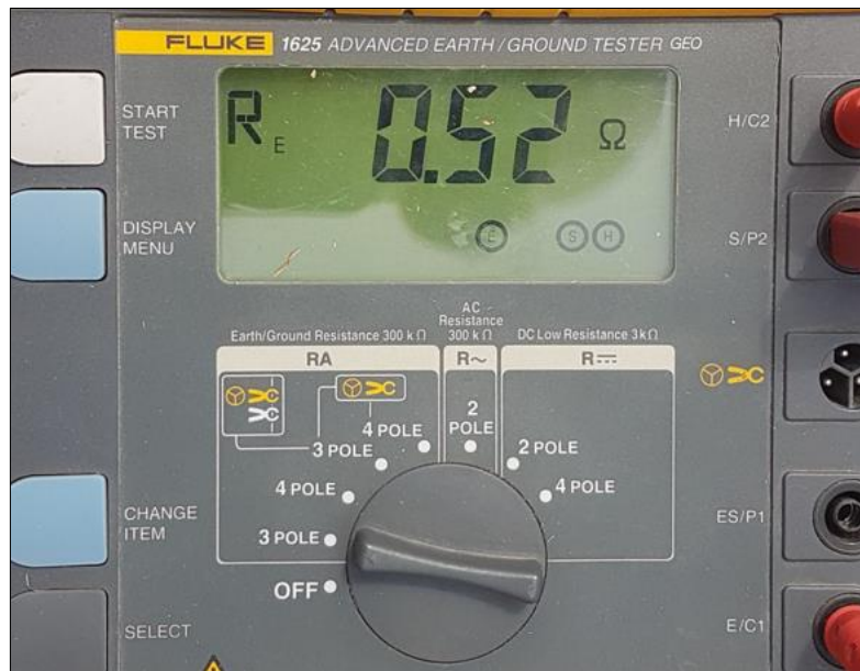
Foto 03. Medición realizada a 9m para C=90m por método alternativo en SPAT1.
