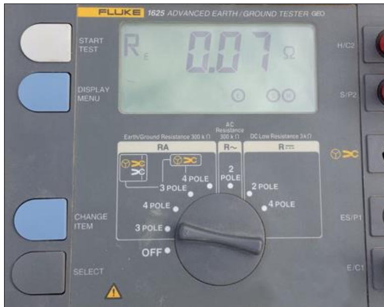
Foto 09. Medición realizada a 45m para C=150m por método alternativo en SPAT2.
