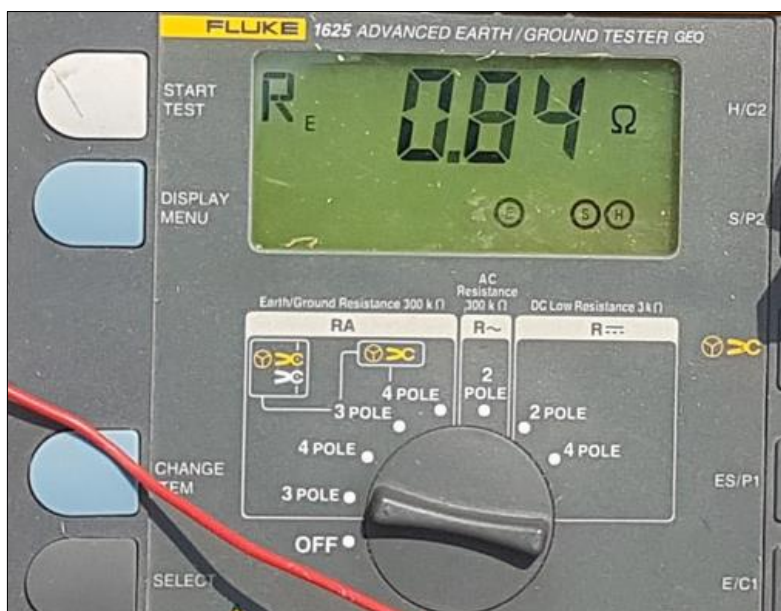
Foto 02. Medición realizada al 62% con C=150m por método convencional en SPAT1.
