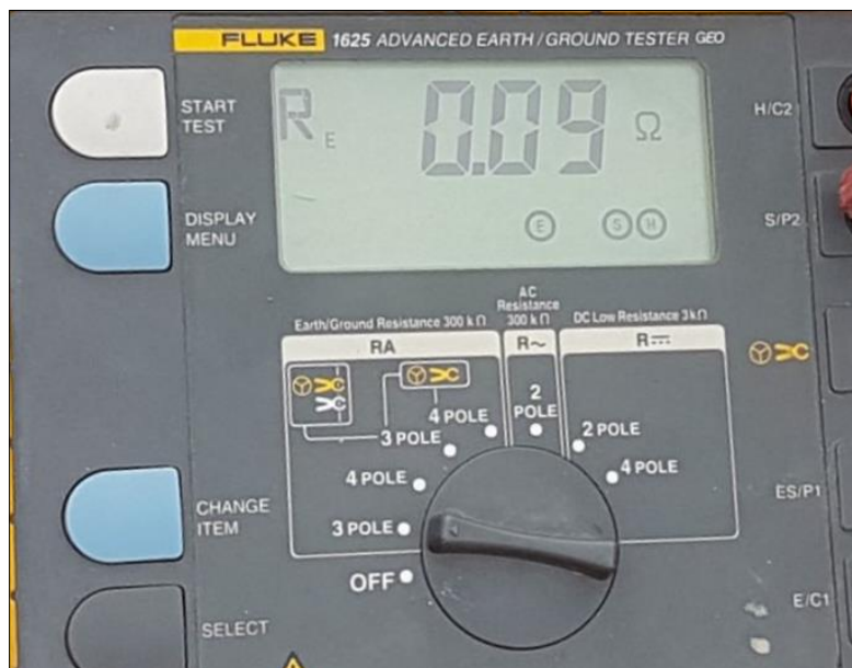
Foto 10. Medición realizada a 48m para C=120m por método alternativo en SPAT2.
