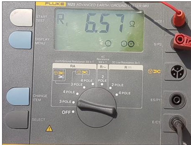
Foto 05. Resistencia medida en pozo auxiliar.
