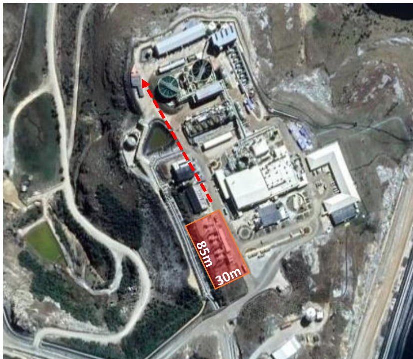
Figura 7. Dimensiones del sistema de puesta a tierra SPAT1. Fuente: Google Maps – Octubre, 2021.
