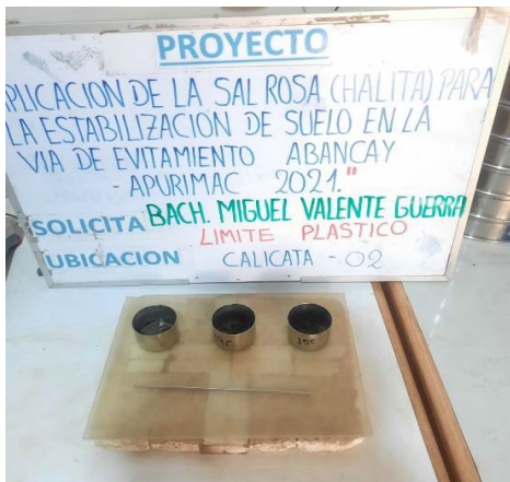
Figura 52. Ensayo para determinar el límite plástico
