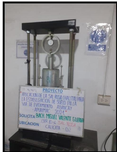
Imagen 12: CBR calicata 02 + 10% halita.
