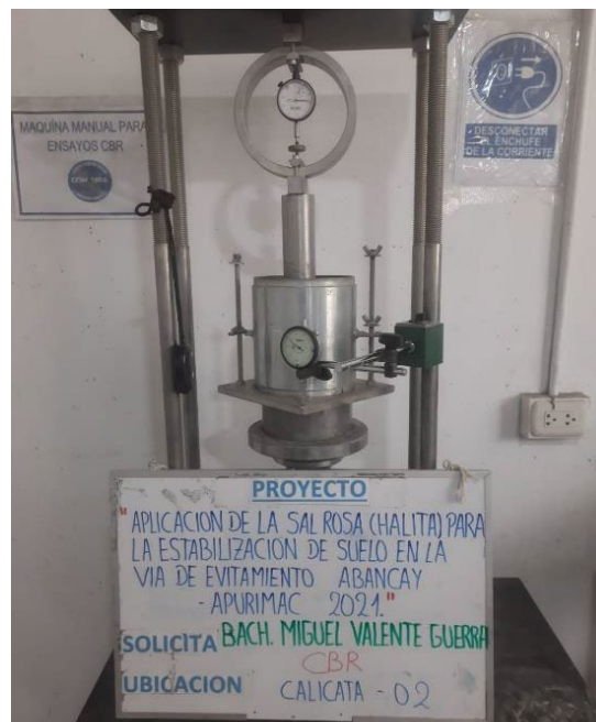
Figura 24. Ensayo CBR con la adición de la sal rosada (halita).
