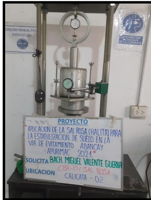
Imagen 13: CBR calicata 02 + 15% halita.
