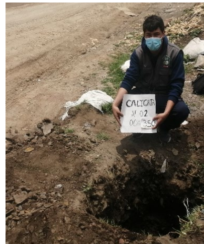
Figura 49. Zona de extracción de muestra C-2 00+350 KM
