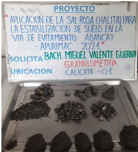
Figura 52. Ensayo de análisis granulométrico
