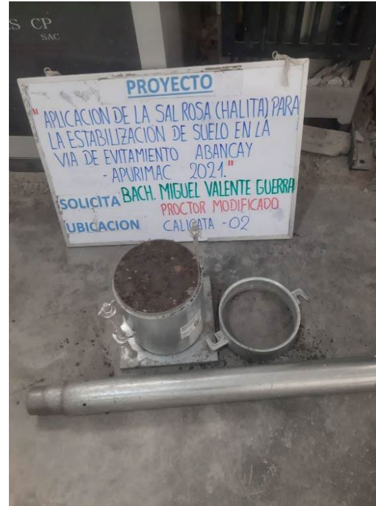
Figura 20. Ensayo Proctor modificado con la adición de sal rosada (halita)
