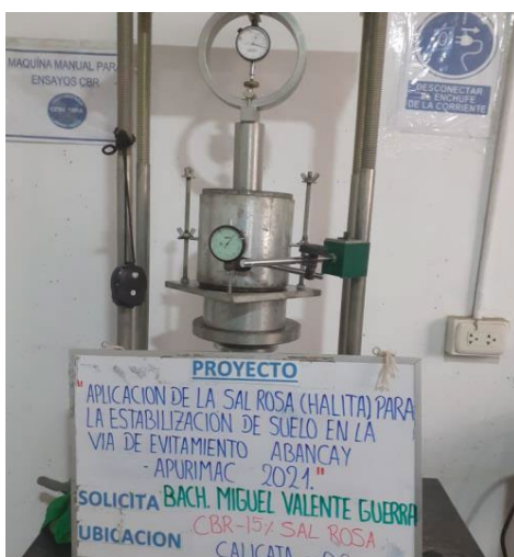
Figura 52. Ensayo de CBR
