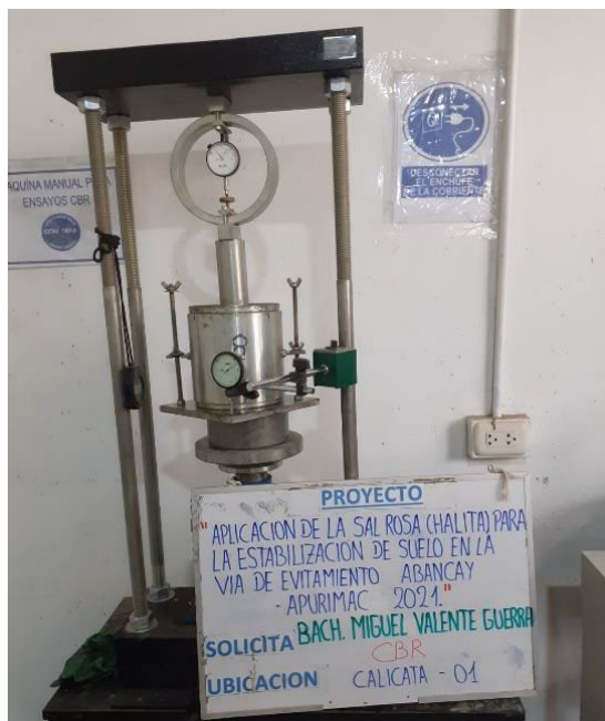
Figura 23. Ensayo CBR con la adición de la sal rosada (halita).
