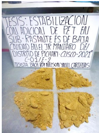
Imagen 19. Vista de cuarteo de la calicata C-01.
