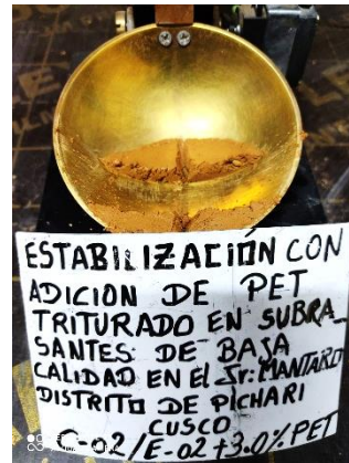
Imagen 32. Vista del ensayo de limite liquido con adición de 3.0% de PET triturado.
