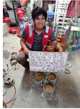
Imagen 44. Vista del ensayo de C.B.R. en laboratorio INGEOMAX S.A.C..
