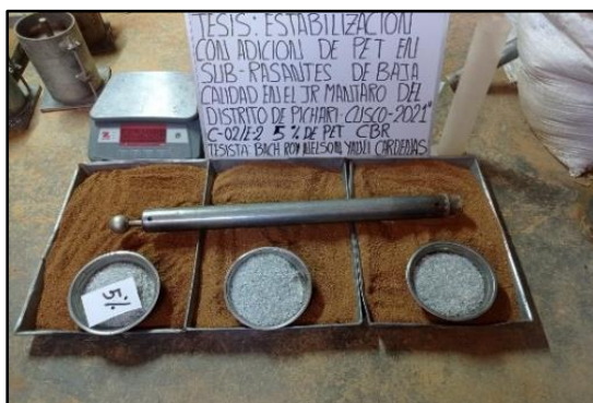
Figura 30. Ensayo de C.B.R. con adición de PET triturado.
