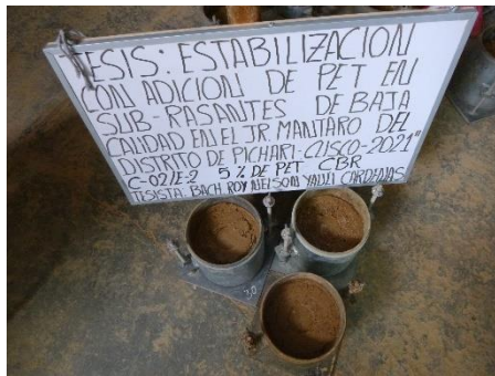
Imagen 47. Vista de las muestras después del ensayo de C.B.R. en laboratorio INGEOMAX S.A.C.
