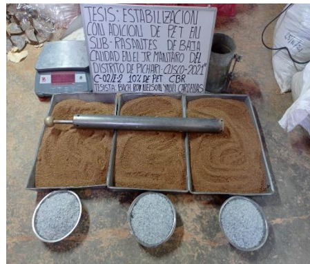
Imagen 42. Vista del ensayo de C.B.R. con adición de 10.0% de PET triturado.
