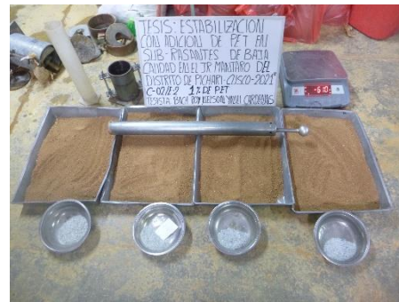
Imagen 48. Vista de las muestras para ensayo de Proctor modificado en laboratorio INGEOMAX S.A.C.
