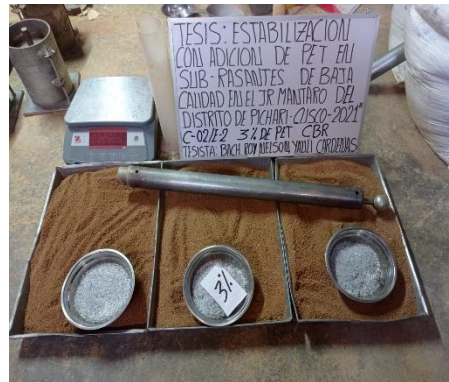
Imagen 40. Vista del ensayo de C.B.R. con adición de 3.0% de PET triturado.
