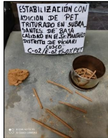
Figura 22. Ensayo con adición (1.0%, 3.0%, 5.0% y 10.0%) PET triturado ensayados.
