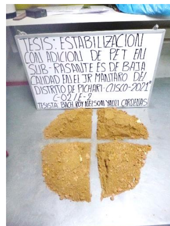
Imagen 22. Vista de cuarteo de la calicata C-02.
