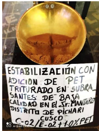
Imagen 31. Vista del ensayo de limite liquido con adición de 1.0% de PET triturado.
