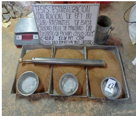
Imagen 39. Vista del ensayo de C.B.R. con adición de 1.0% de PET triturado.
