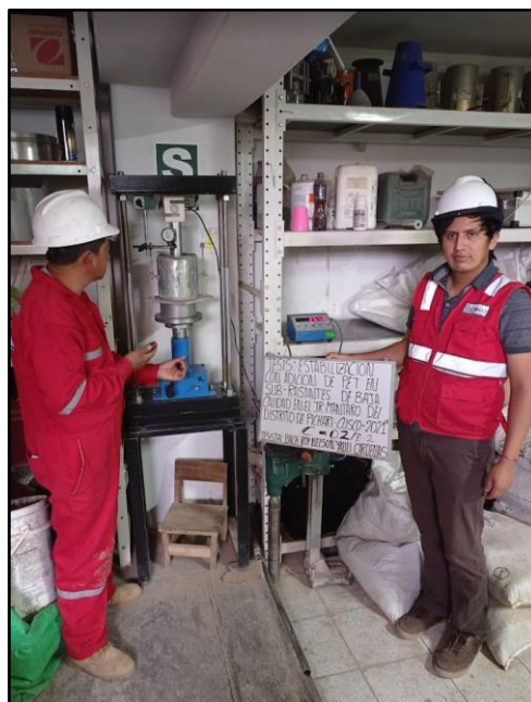
Figura 16. Ensayo de CBR en laboratorio.
