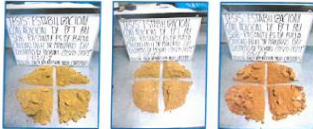
Panel N°01- Reducción de muestra representativa por cuarteo.
