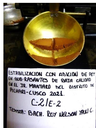
Imagen 24. Vista del ensayo de limite liquido de la calicata C-02.
