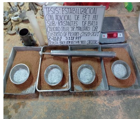
Imagen 36. Vista del ensayo de Proctor modificado con adición de 3.0% de PET triturado.
