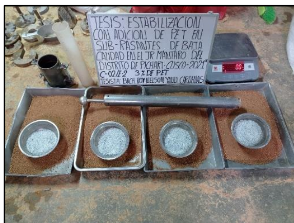
Figura 24. Ensayo de Proctor modificado (O.C.H y M.D.S).
