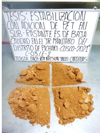
Imagen 25. Vista de cuarteo de la calicata C-03.
