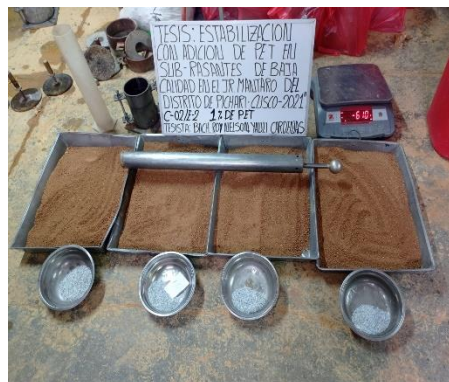
Imagen 35. Vista del ensayo de Proctor modificado con adición de 1.0% de PET triturado.
