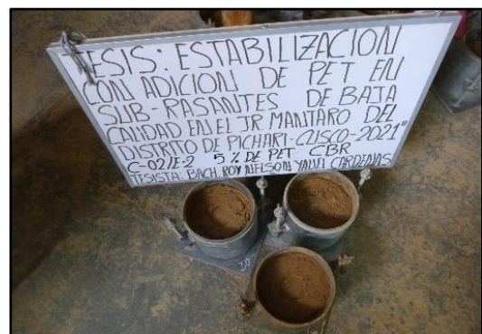
Figura 31. Moldes C.B.R con adición (1.0%, 3.0%, 5.0% y 10.0%) PET triturado ensayados.
