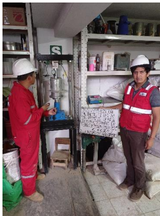
Imagen 45. Vista del ensayo de C.B.R. en laboratorio INGEOMAX S.A.C.
