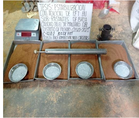
Imagen 38. Vista del ensayo de Proctor modificado con adición de 10.0% de PET triturado.
