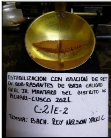
Figura 21. Ensayo de limite liquido en suelo natural.
