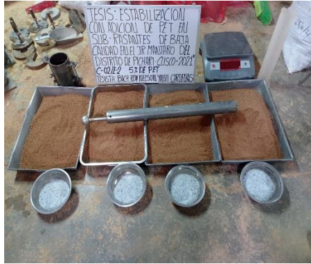
Imagen 37. Vista del ensayo de Proctor modificado con adición de 5.0% de PET triturado.
