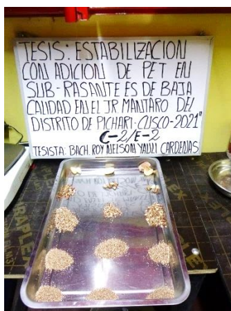
Imagen 23. Vista del ensayo de granulometría por tamizado de la calicata C-02.
