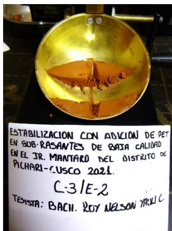
Imagen 27. Vista del ensayo de limite liquido de la calicata C-03.
