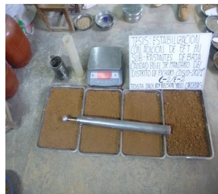
Imagen 28. Vista del ensayo de Proctor modificado en suelo natural de la calicata C-02.
