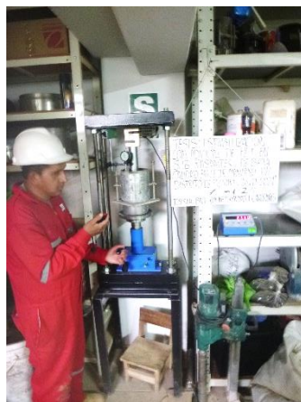
Imagen 29. Vista del ensayo de C.B.R. en suelo natural de la calicata C-02.
