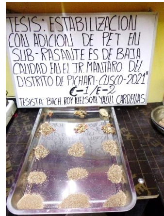
Imagen 20. Vista del ensayo de granulometría por tamizado de la calicata C-01.
