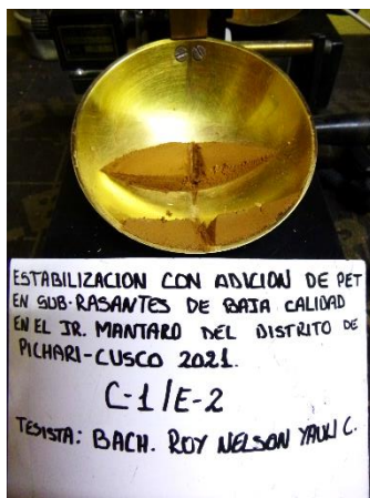
Imagen 21. Vista del ensayo de limite liquido de la calicata C-01.
