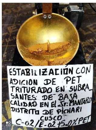
Imagen 33. Vista del ensayo de limite liquido con adición de 5.0% de PET triturado.
