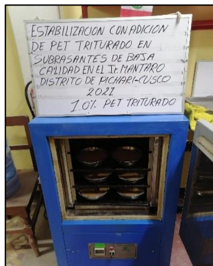
Figura 25. Secado en horno, O.C.H. (1.0%, 3.0%, 5.0% y 10.0%) PET triturado.
