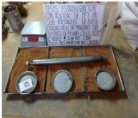
Imagen 41. Vista del ensayo de C.B.R. con adición de 5.0% de PET triturado.
