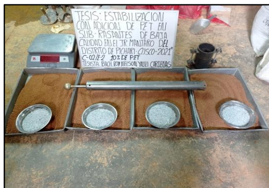
Figura 28. Determinación de M.D.S (1.0%, 3.0%, 5.0% y 10.0%) PET triturado.
