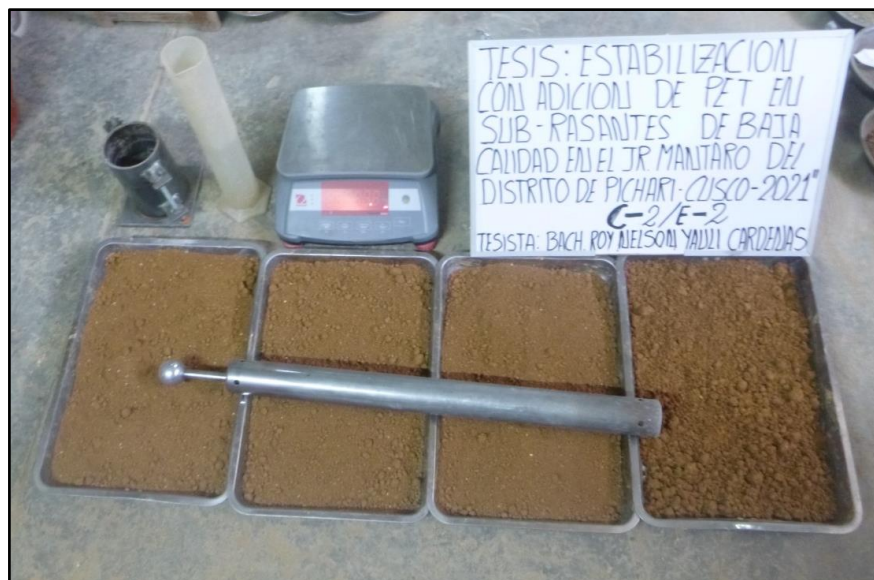
Figura 14. Ensayo de Proctor modificado.
