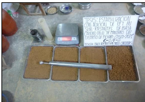
Figura 27. Ensayo de Proctor modificado (O.C.H y M.D.S).
