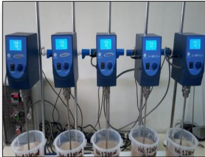
Figura 25. Extracción de plomo del agua a 150 rpm
