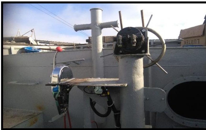
Figura 1. Servomotor de una embarcación auxiliar.
