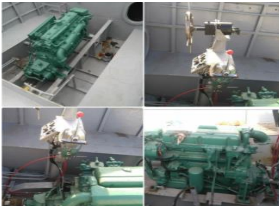
Figura 10. Motor Diésel y servomotor acoplado al sistema hidráulico.
