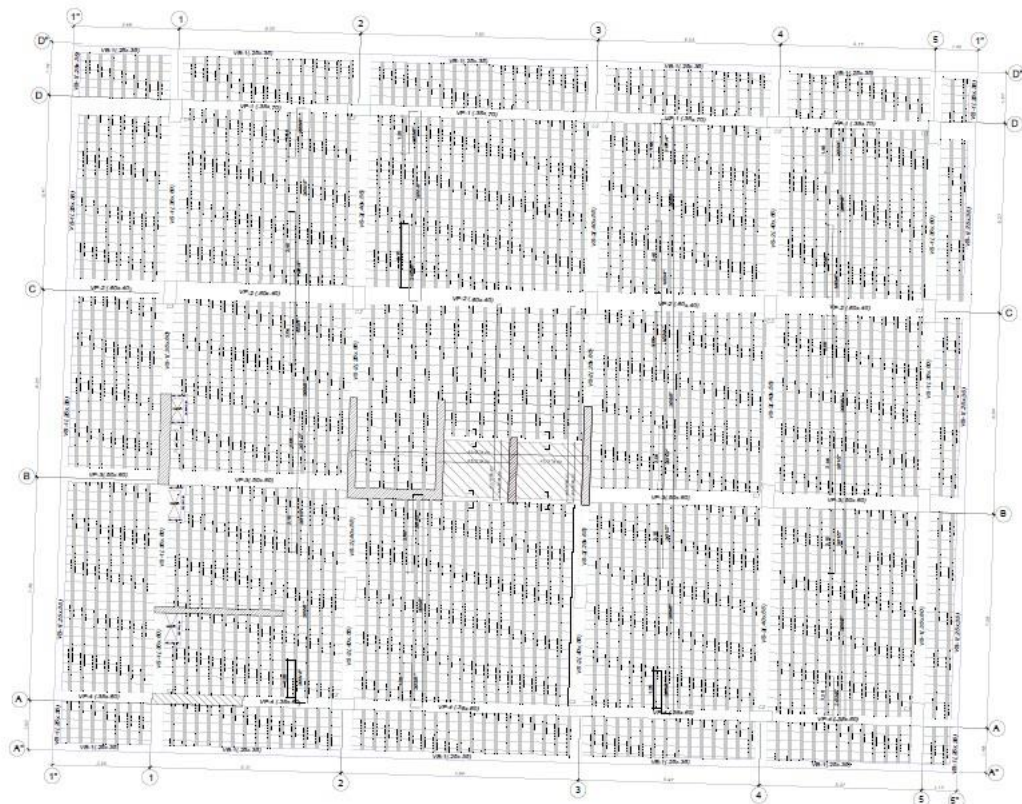
LOSA NERVADA-BIBLIOTECA TERCERA PLANTA
