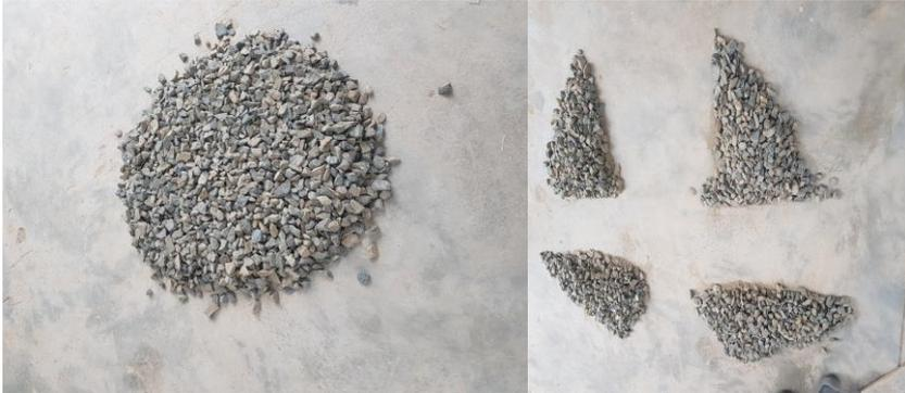
**Figura 7** Cuarteo de agregado grueso 1/2"
