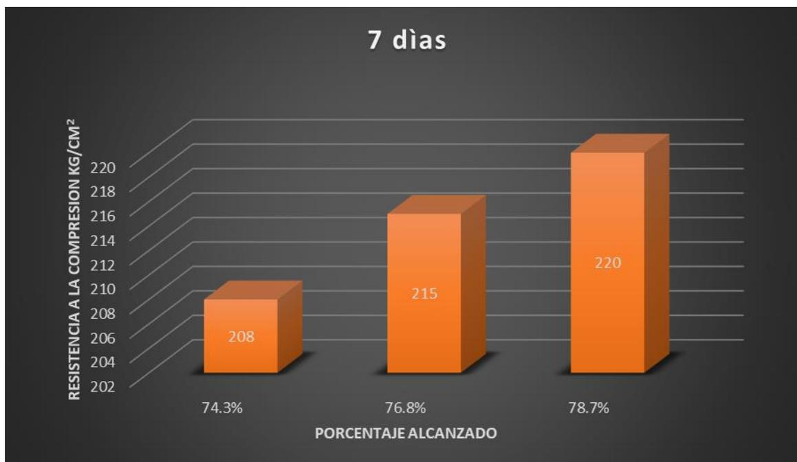
**Figura 18** Resistencia a la compresión del concreto permeable ½” a los 7 días de curado.
