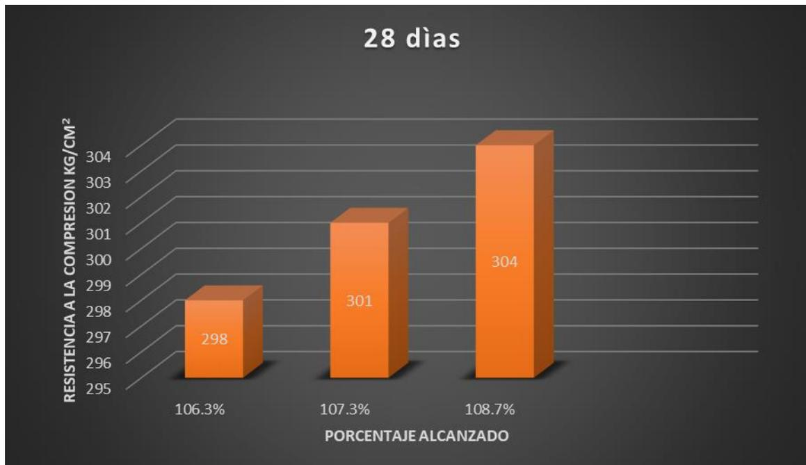
**Figura 20** Resistencia a la compresión del concreto permeable 1/2" a los 28 días de curado.
