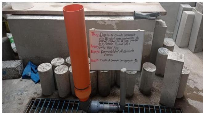
**Figura 36** Ensayo de permeabilidad ½”
