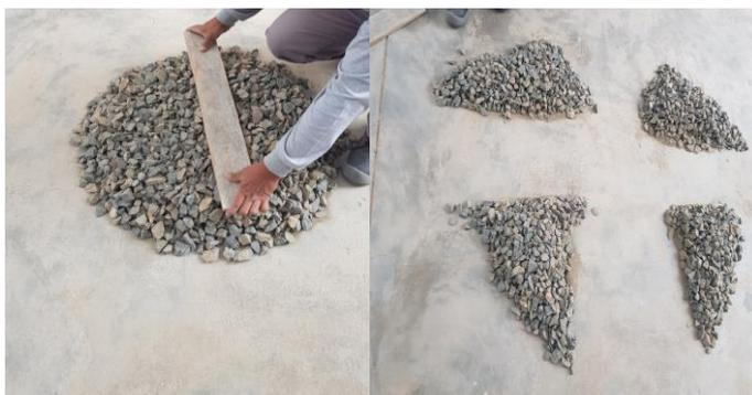
**Figura 11** Cuarteo de agregado grueso ¾".
