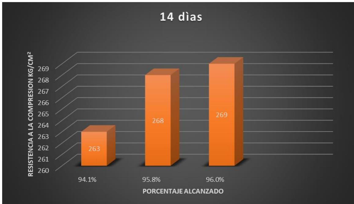
**Figura 19** Resistencia a la compresión del concreto permeable 1/2" a los 14 días de curado.
