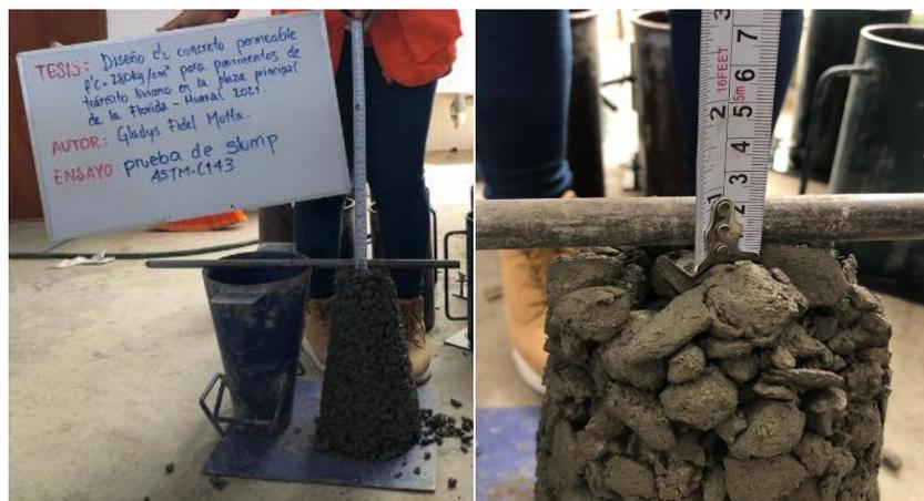
**Figura 15** Prueba de slump
