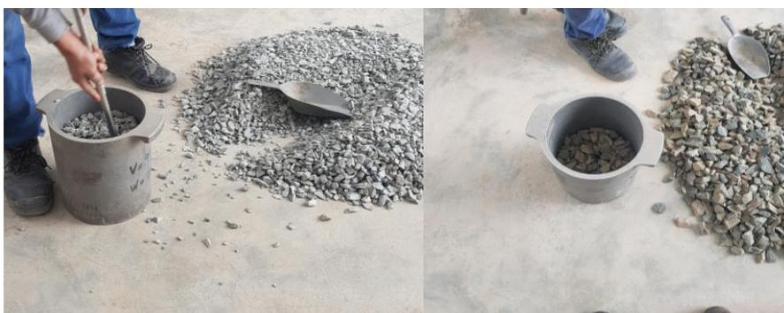
**Figura 10** *Peso unitario suelto y compactado de la piedra chancada*
