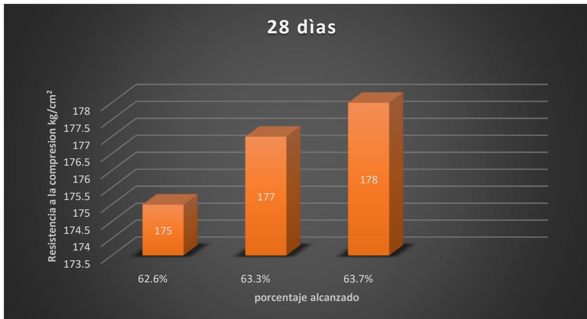
**Figura 23** Resistencia a la compresión del concreto permeable ¾" a los 28 días de curado.
