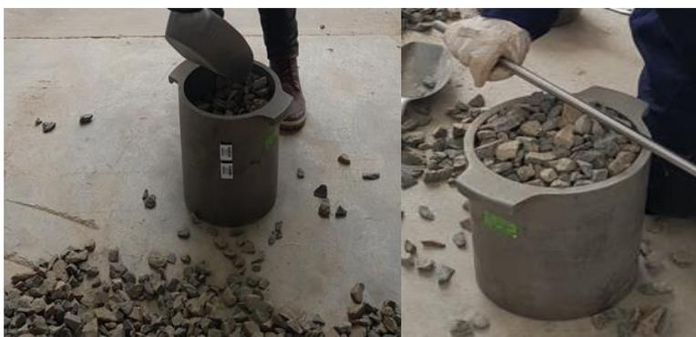
**Figura 14** Peso unitario suelto y compactado de la piedra chancada
