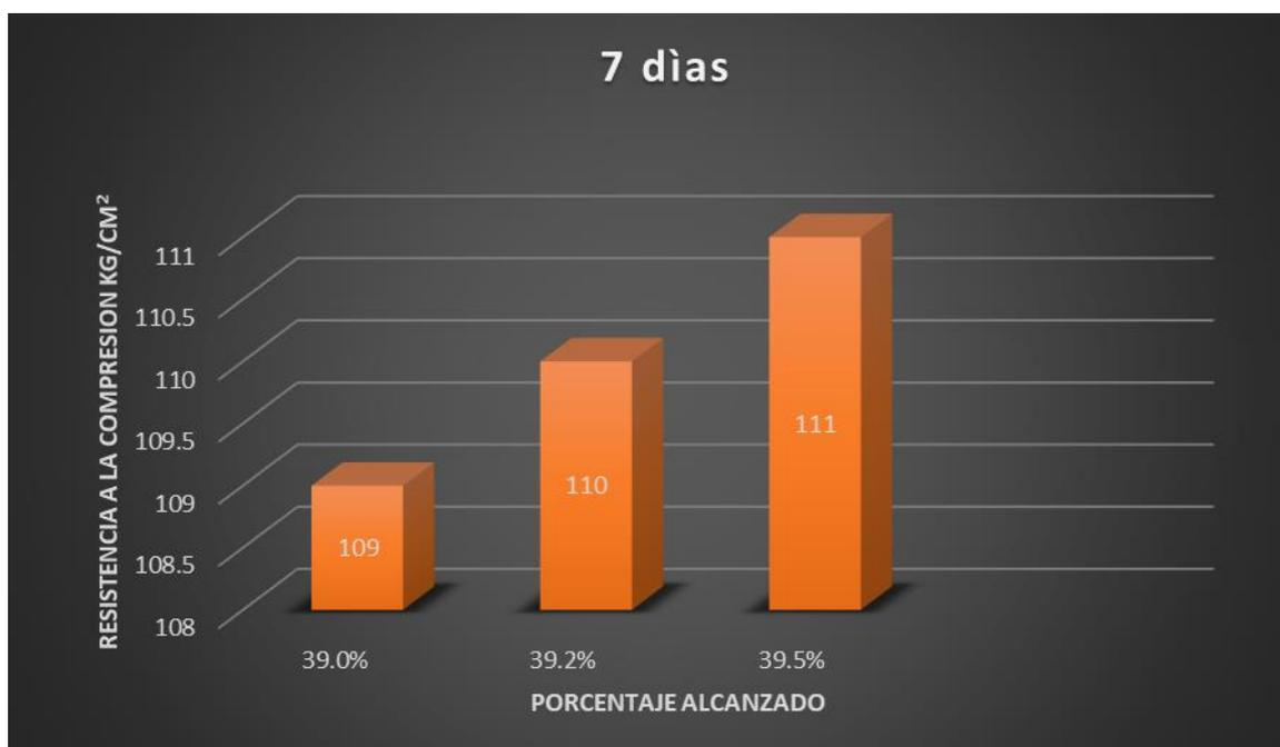
**Figura 21** Resistencia a la compresión del concreto permeable ¾" a los 7 días de curado.
