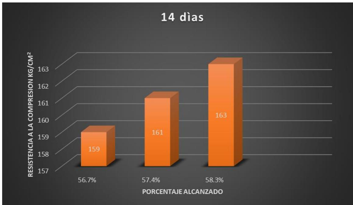
**Figura 22** Resistencia a la compresión del concreto permeable ¾" a los 14 días de curado.
