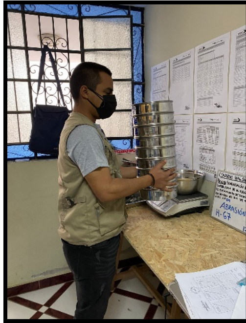
Foto N° 03: Utilización de los tamices en los agregados gruesos
