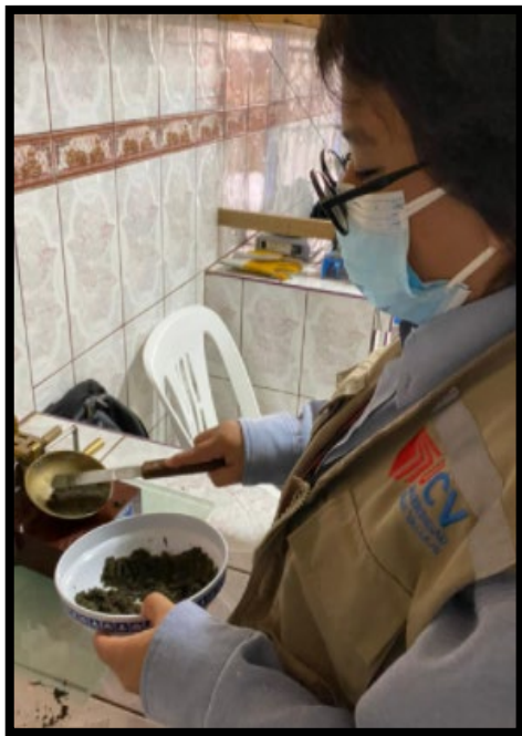
Foto N° 05: Colocación de la muestra en la Copa Casa Grande PROCTOR MODIFICADO
