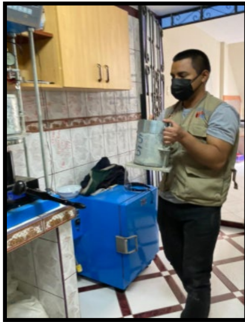
Foto N° 08: Llevando el molde con la muestra en la herramienta del CBR.
