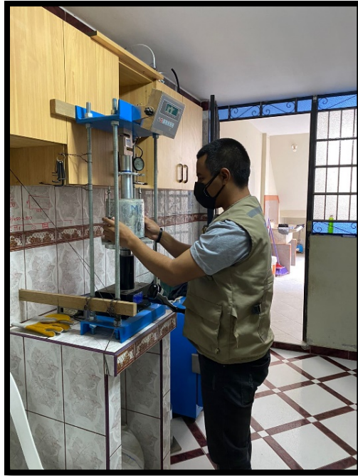
Foto N° 09: Colocación del molde con la muestra en la herramienta del CBR.
