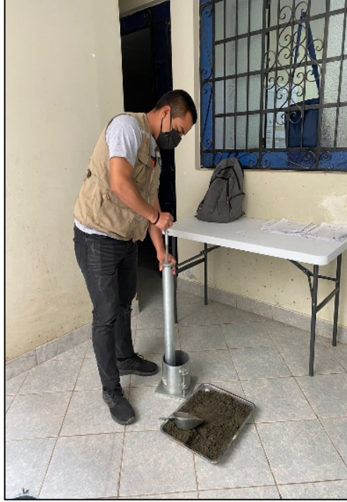
Foto N° 07: Utilización del martillo hacia el molde con 25 golpes
