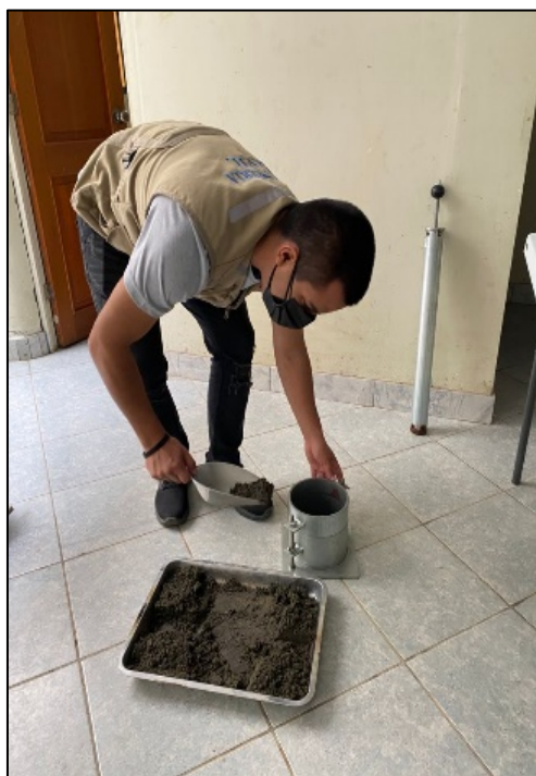
Foto N° 06: Preparación del material hacia el molde
