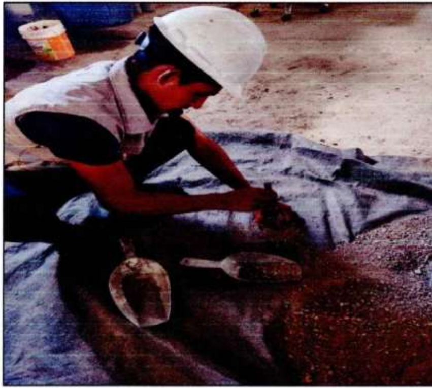
Proceso de ensayo de absorción del agregado fino – AGREGADOS, Método normalizado para peso específico y absorción del agregado grueso, NTP 400.21-2002
