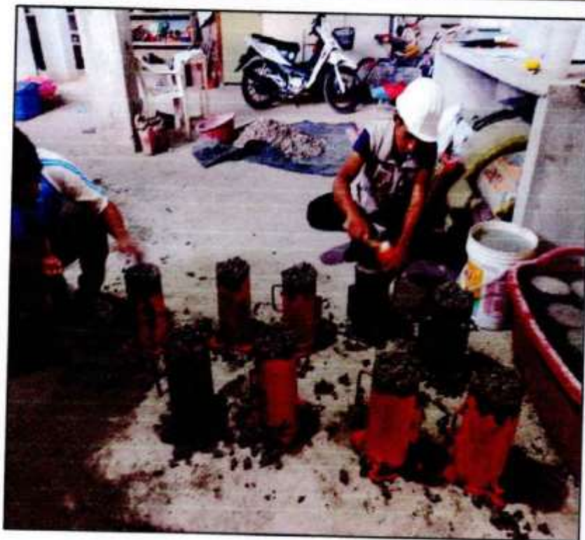
Realización de moldeo patrón de probetas de 15 x 30 cm – Hormigón concreto método de ensayo normalizado para la determinación de la resistencia a la compresión del concreto en muestras cilíndricas. NTP 339.034 - 2008
