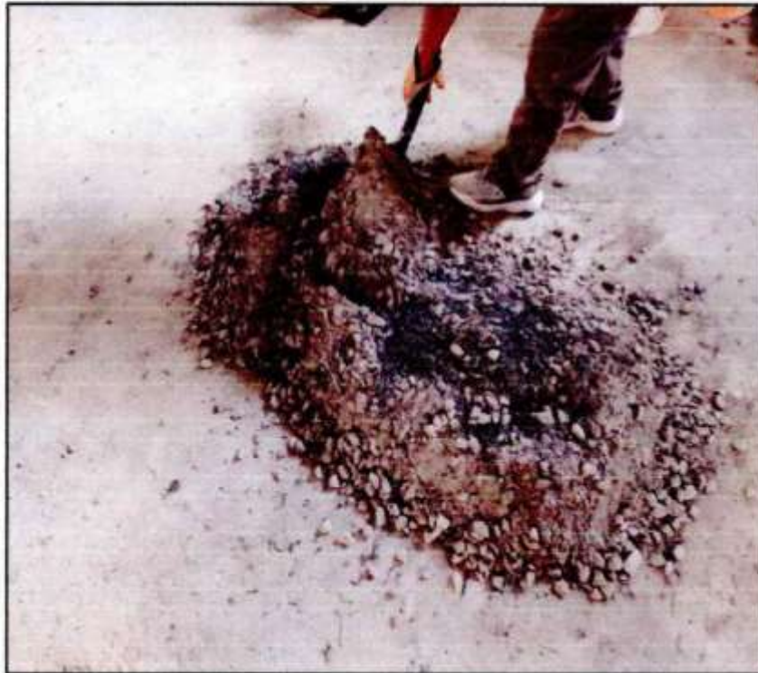
Realización de batido de concreto para la muestra con adición de fibras acero a distintas proporciones de cilindros de concreto.
