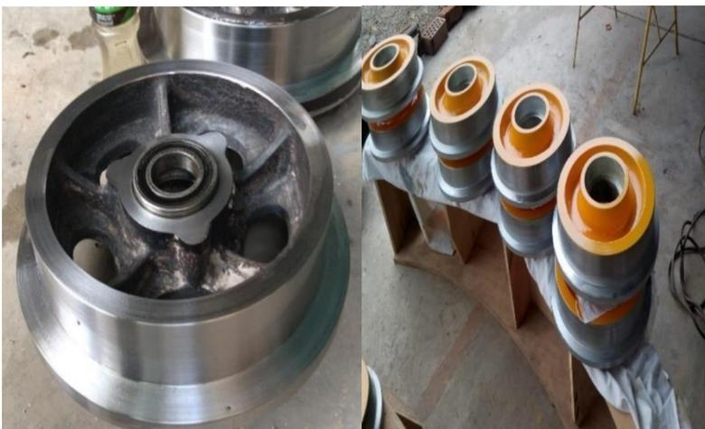
Figura 8 Rueda de carro de ladrillos
