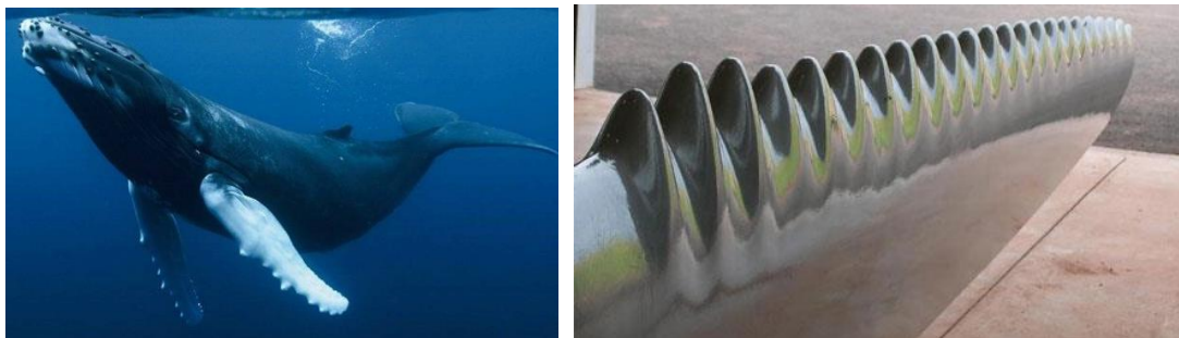
Figura 23. Molinos de viento hechos por la compañía Whale Power basados en la ballena jorobada.
