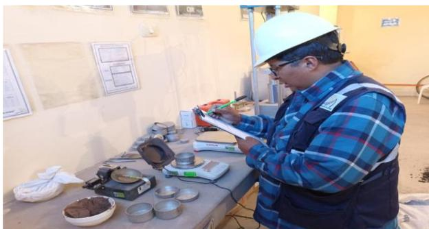
Figura 18. Ensayo de plasticidad con incorporación de ceniza de boñiga.
