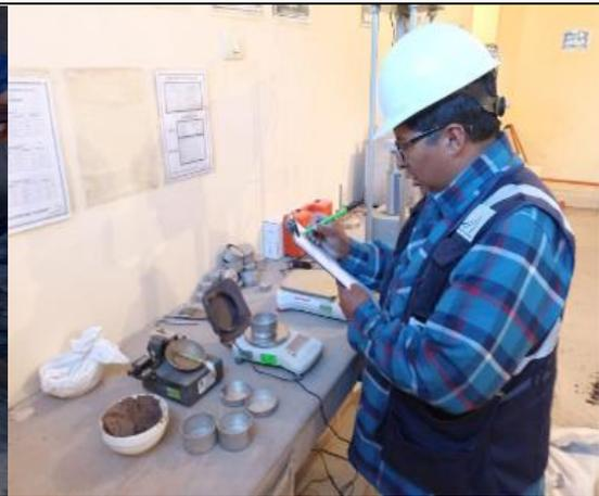
Ensayo de determinación de I.P.
