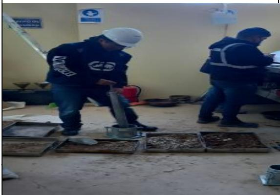
Ensayo de proctor modificado
