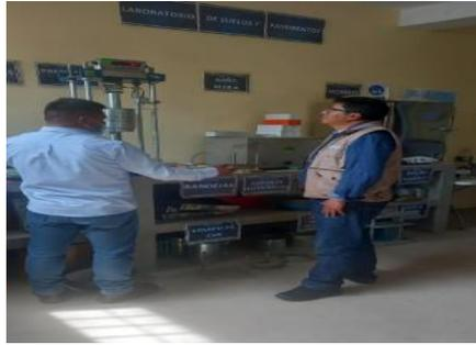
Figura 24. Ensayo de CBR con adición de ceniza de boñiga
