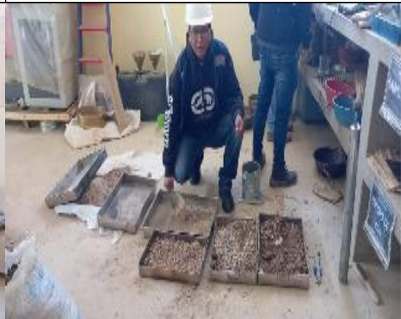
Ensayo de proctor modificado
