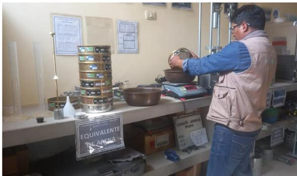
Figura 17. Ensayo granulométrico con incorporación de ceniza de boñiga.
