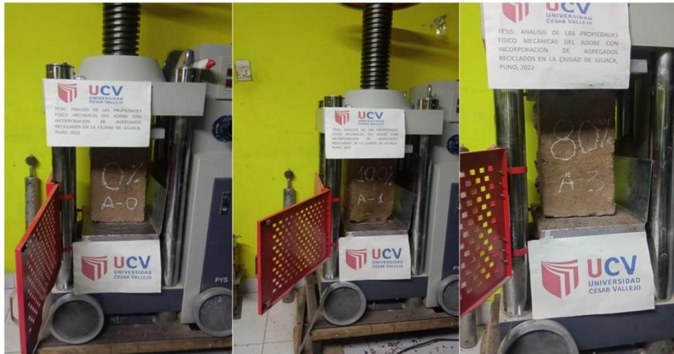
**Figura 56 Ensayo de compresión en laboratorio**
