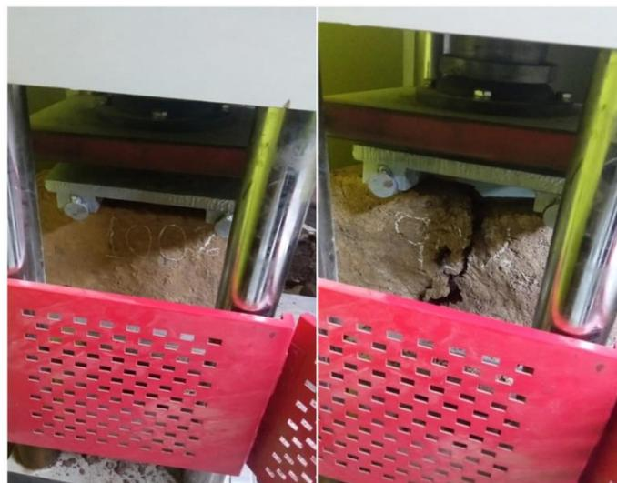
**Figura 57 Ensayo de flexión en adobes**
