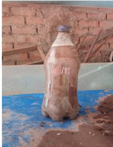
**Figura 42 Prueba de la sedimentación en la botella**
