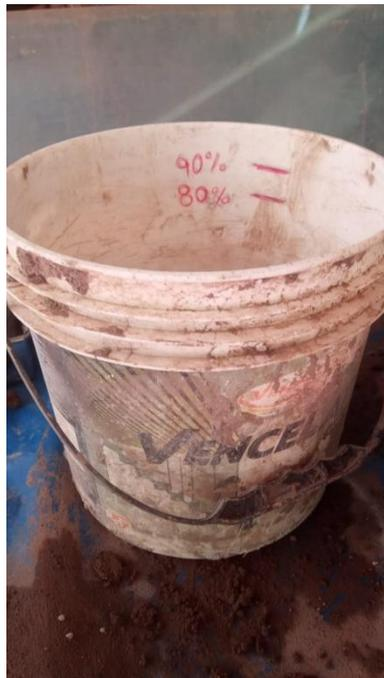
**Figura 51 Balde marcado para dosificar el agregado reciclado.**
