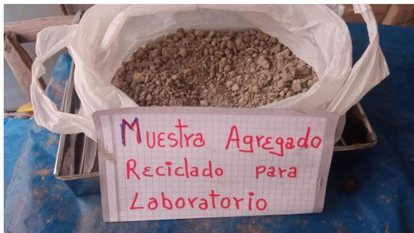
**Figura 47 Muestra de agregado reciclado enviado al laboratorio.**
