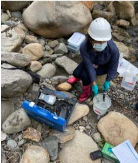
Foto N° 02-04. Prueba de multiparámetro Rio Chuyapi-03
