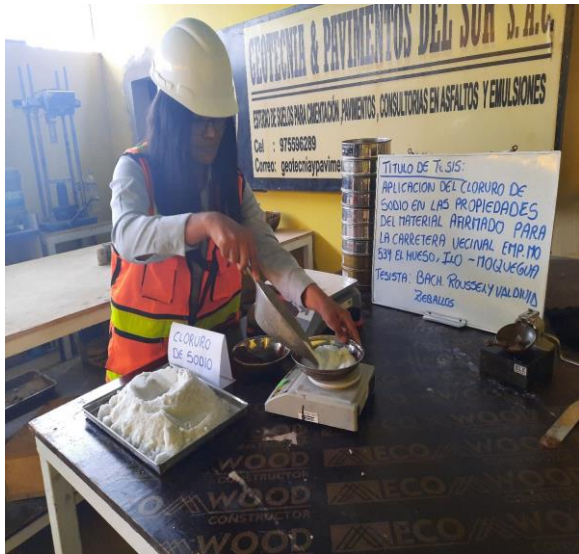
Fotografía 31: Preparación de materiales para realizar el ensayo de Límites de Atterberg en muestra natural con adición del 2% de NaCl.
