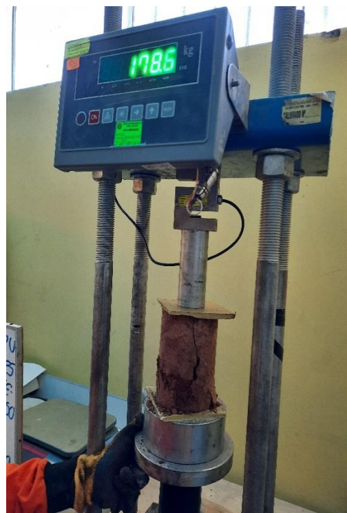
Fotografía 50: Aplicación manual de esfuerzos en espécimen uno con muestra natural sin adición de NaCl en máquina de compresión a los 7 días..
