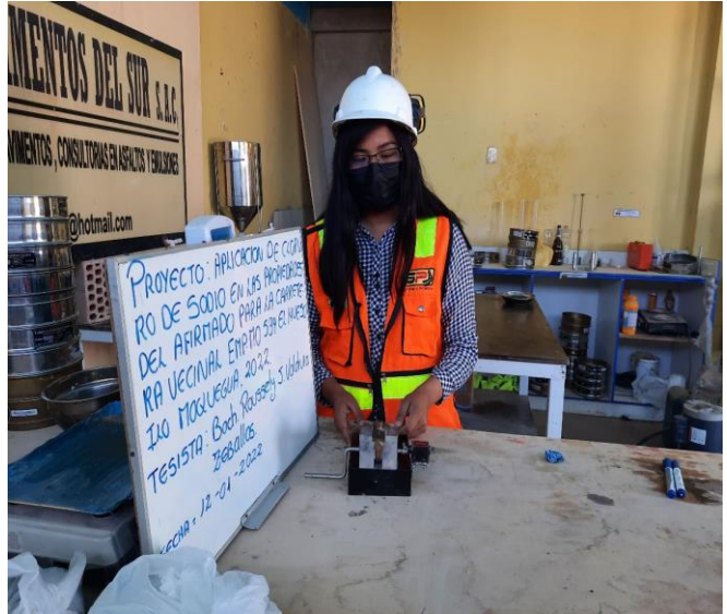
Fotografía 36: Ensayo de Límites de Atterberg en muestra natural con adición del 10% de NaCl, determinación del límite líquido y plástico.
