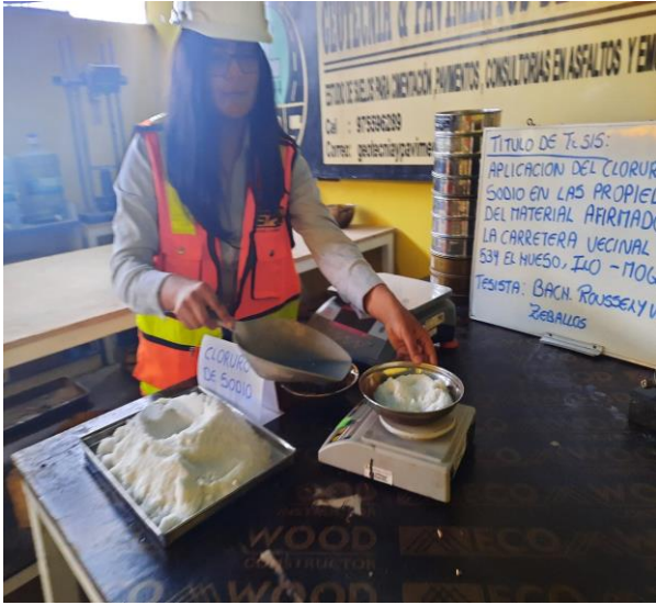
Fotografía 35: Preparación de materiales para realizar el ensayo de Límites de Atterberg en muestra natural con adición del 10% de NaCl.
