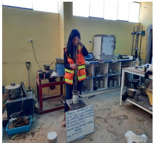
Fotografía 42: Proceso de compactación del ensayo de Proctor Modificado en muestra natural y con adición del 10% de NaCl.
