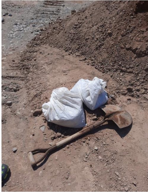
Fotografía 17: Muestra uno y dos de material granular afirmado de la para llevar a laboratorio.
