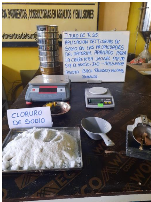
Fotografía 31: Preparación de materiales para realizar el ensayo de Limites de Atterberg en muestra natural y con dosificaciones de NaCl.
