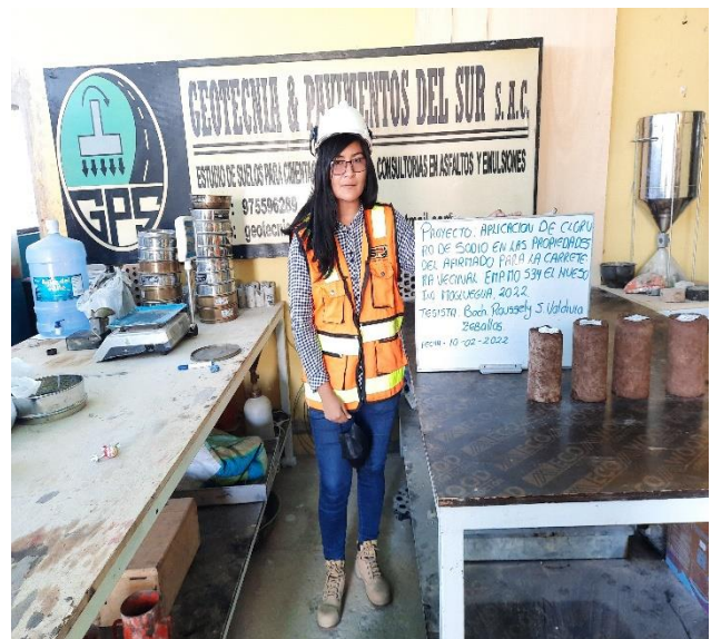
Fotografía 66: Especímenes dos de muestra natural y con adición del 2%,6% y 10% de NaCl para realizar el ensayo de Compresión Simple en muestra natural con adición del 10% de NaCl.
