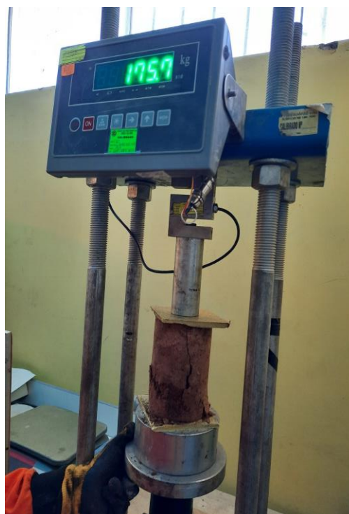
Fotografía 54: Aplicación manual de esfuerzos en espécimen uno con muestra natural con adición del 2% de NaCl en máquina de compresión a los 7 días.
