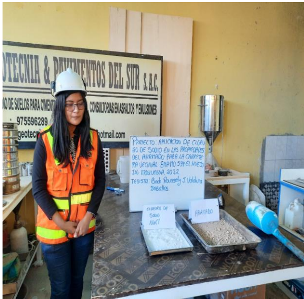
Fotografía 55: Preparación de materiales para realizar el ensayo de Compresión Simple en muestra natural con adición del 6% de NaCl.
