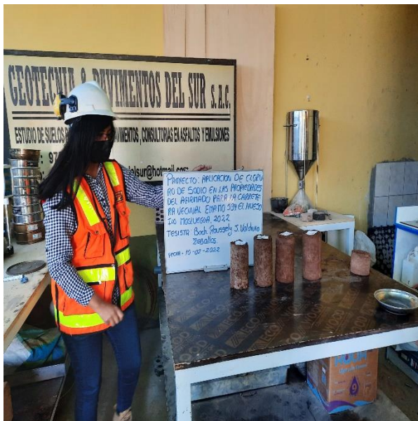
Fotografía 65: Especímenes uno de muestra natural y con adición del 2%,6% y 10% de NaCl para realizar el ensayo de Compresión Simple en muestra natural con adición del 10% de NaCl.
