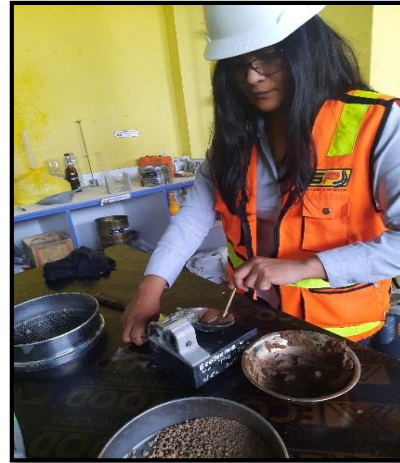
Figura 20. Ensayo para determinación de Índice de Plasticidad en Muestra patrón.
