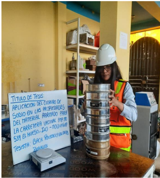
Fotografía 29: Ensayo de análisis granulométrico de muestra extraída en cantera para clasificación del tipo de
