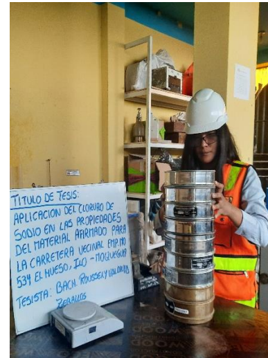
Figura 8. Ensayo granulométrico de la muestra patrón en laboratorio de suelos.
