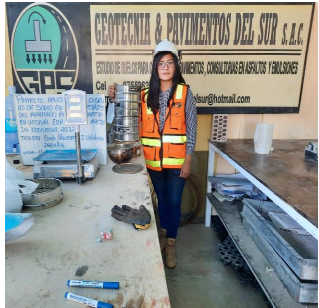
Fotografía 26: Preparación de materiales para ensayo de análisis granulométrico de muestra extraído de cantera.
