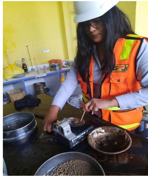
Fotografía 32: Ensayo de Límites de Atterberg en muestra natural con adición del 2% de NaCl, determinación del límite líquido y plástico.
