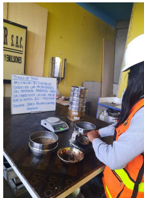
Fotografía 34: Ensayo de Límites de Atterberg en muestra natural con adición del 6% de NaCl, determinación del límite líquido y plástico.
