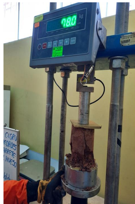
Fotografía 58: Aplicación manual de esfuerzos en espécimen uno con muestra natural con adición del 6% de NaCl en máquina de compresión a los 7 días.
