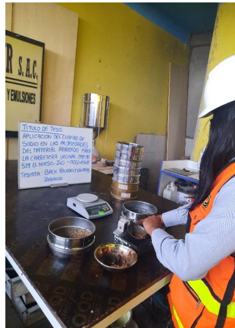
Fotografía 32: Ensayo de Limites de Atterberg en muestra natural, determinación del límite líquido y plástico.
