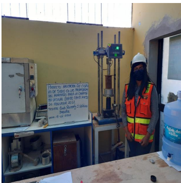
Fotografía 53: Colocación de espécimen uno con muestra natural con adición del 2% de NaCl en máquina de compresión para determinación de esfuerzos compresivos máximos.
