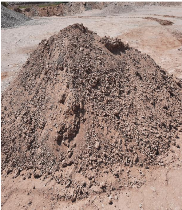
Fotografía 15: Material granular afirmado de la cantera ubicada en el tramo final de la carretera EMP.MO534 Fundo El Hueso
