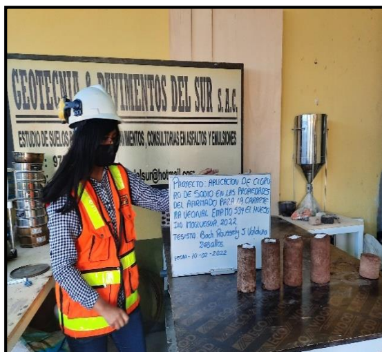
Figura 31: Espécimen de MN y muestras con adición de 2,6 y 10% de NaCl para ensayo de compresión simple.
