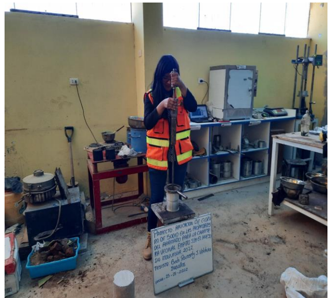
Fotografía 38: Proceso de compactación del ensayo de Proctor Modificado en muestra natural y con adición del 2% de NaCl.
