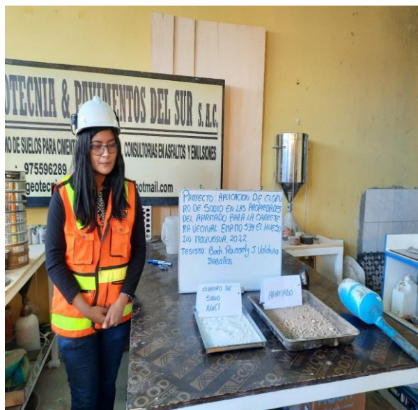
Fotografía 51: Preparación de materiales para realizar el ensayo de Compresión Simple en muestra natural con adición del 2% de NaCl.
