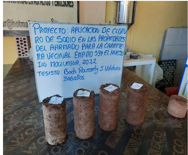
Fotografía 64: Especímenes dos de muestra natural y con adición del 2%,6% y 10% de NaCl para realizar el ensayo de Compresión Simple en muestra natural con adición del 10% de NaCl.
