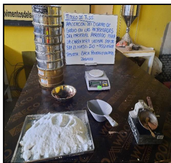
Figura 23. Preparación de dosificación para Índice de plasticidad en muestra adicionando el 2%, 6% y 10%.
