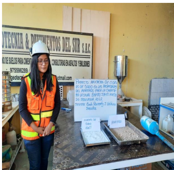
Fotografía 59: Preparación de materiales para realizar el ensayo de Compresión Simple en muestra natural con adición del 10% de NaCl.
