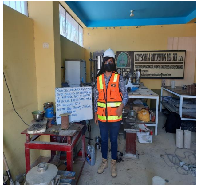
Fotografía 56: Espécimen de muestra natural con adición del 6% de NaCl lista para ensayo de Compresión Simple No Confinada.
