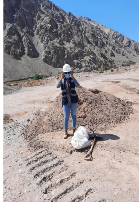
Fotografía 22: Extracción de muestra cuatro de material granular afirmado de la para llevar a laboratorio.
