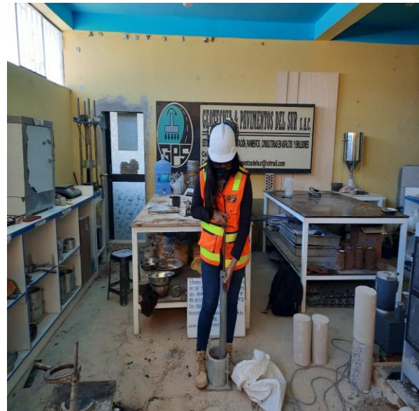
Fotografía 44: Proceso de compactación del ensayo de CBR en muestra extraída natural y con adición del 2% de NaCl.
