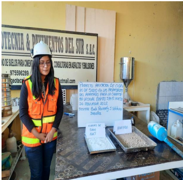
Fotografía 43: Preparación de materiales para realizar el ensayo CBR en muestra extraída natural y con adición del 2%,6% y 10% de NaCl.
