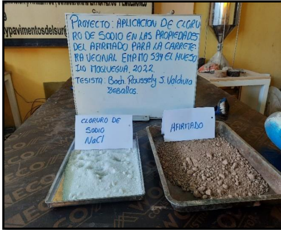
Figura 19. preparación de dosificación para Limite Plástico en muestra adicionando el 2%,6% y 10%.
