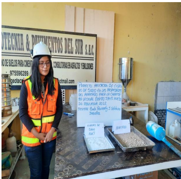
Fotografía 41: Preparación de materiales para realizar el ensayo de Proctor Modificado en muestra natural con adición del 10% de NaCl.
