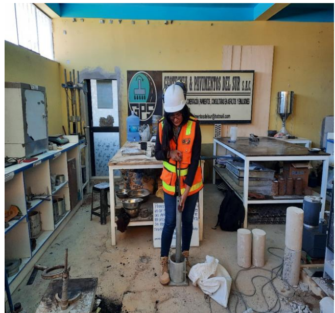
Fotografía 46: Proceso de compactación del ensayo de CBR en muestra extraída natural y con adición del 10% de NaCl.
