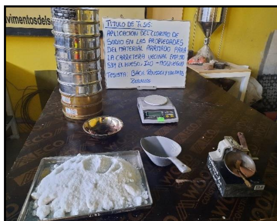
Figura 17. Preparación de dosificación para Límite Líquido en muestra + 2%, 6% y 10%.
