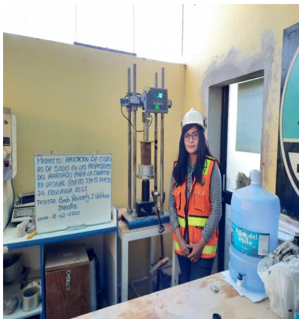
Fotografía 57: Colocación de espécimen uno con muestra natural con adición del 6% de NaCl en máquina de compresión para determinación de esfuerzos compresivos máximos.
