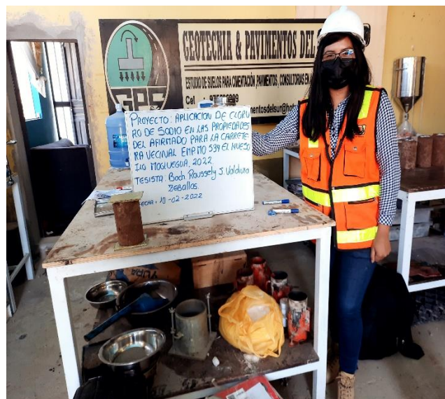
Fotografía 52: Espécimen de muestra natural con adición del 2% de NaCl lista para ensayo de Compresión Simple No Confinada.
