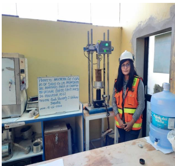
Fotografía 61: Colocación de espécimen uno con muestra natural con adición del 10% de NaCl en máquina de compresión para determinación de esfuerzos compresivos máximos.
