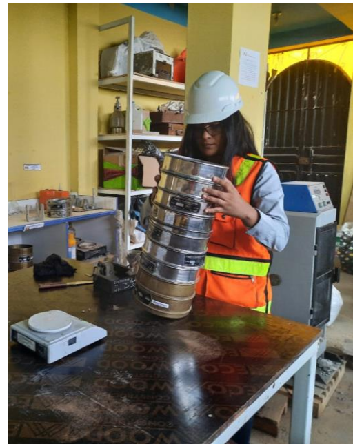
Fotografía 30: Ensayo de análisis granulométrico de muestra extraída en cantera para clasificación del tipo de material.
