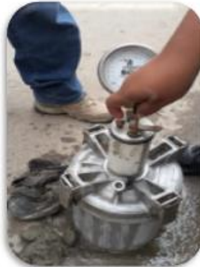
Bombeo de aire al molde
