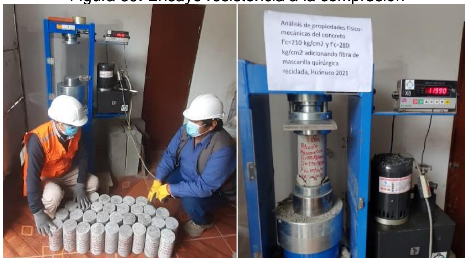
Figura 39: Ensayo resistencia a la compresión
