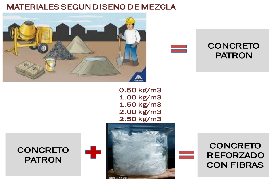
Figura 7: Concreto patrón y concreto reforzado con fibras de mascarillas quirúrgicas recicladas
