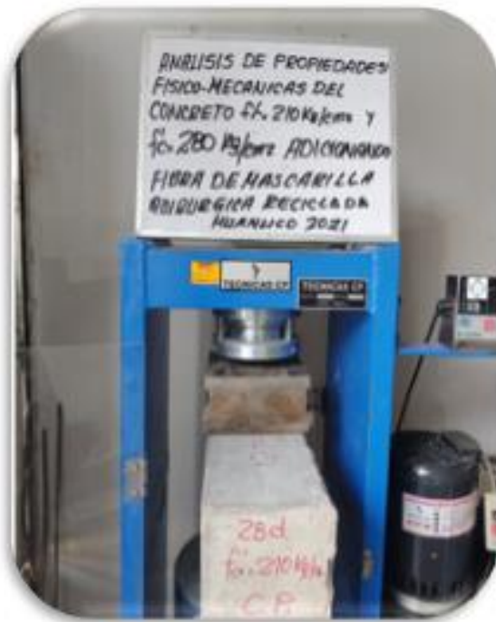
Ensayo a flexión
