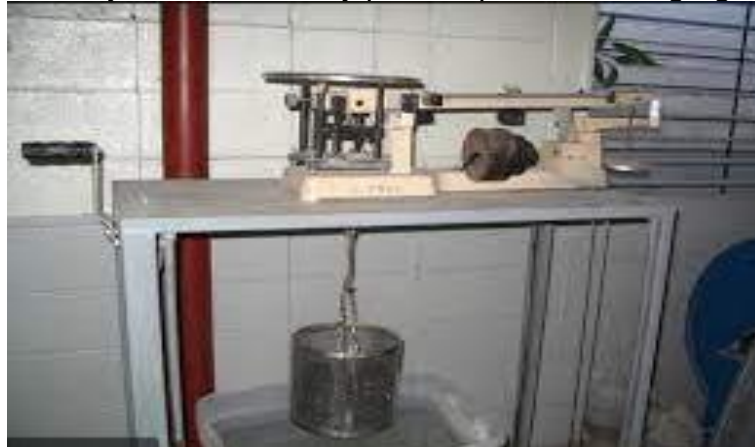
Figura 13: Ensayo de absorción y peso específico del agregado grueso
