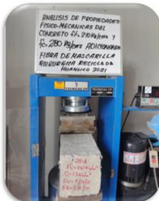
Ensayo a flexión
