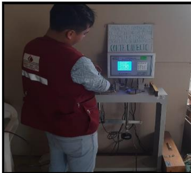
Fotografía N°04.- En la fotografía se observa al personal de laboratorio efectuando el proceso del ensayo de corte directo para la muestra de la Calicata C-01.
