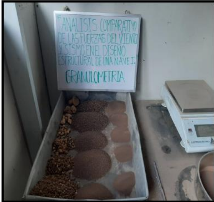
Fotografía N°03.- En la fotografía se observa el material de la calicata C-01, realizado a través del ensayo de granulometría.
