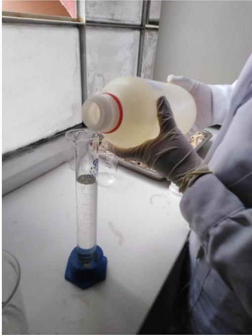
**Figura 15** Preparación de la solución de ácido fosfórico a 50 %
