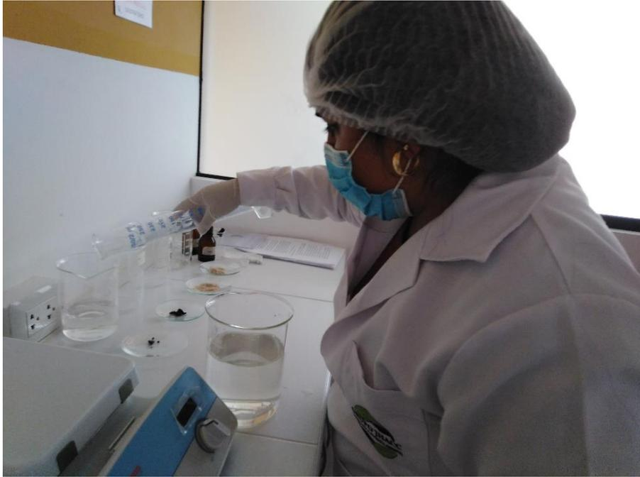
**Figura 22** mezclar 0,3 g a 1,1 g del adsorbente y carbón activado del bagazo de la caña de azúcar con 200 mL de las aguas del canal del CIMIRM
