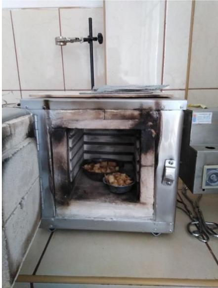
**Figura 17** Carbonización del bagazo en la mufla
