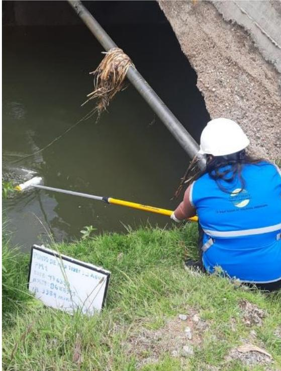
**Figura 4** Toma de muestra del canal CIMIIRM según el protocolo de DIGESA.
