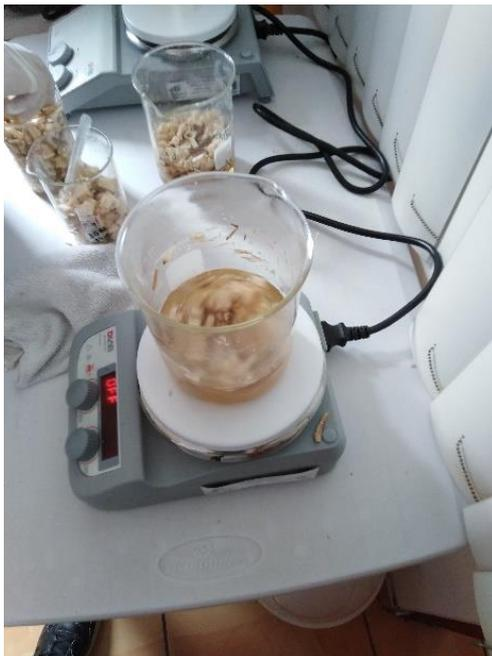
**Figura 16** Colocado del bagazo cortado en la mezcla por 30 min
