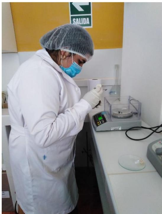
**Figura 19** Pesado del carbón en la balanza electrónica sobre la luna de reloj
