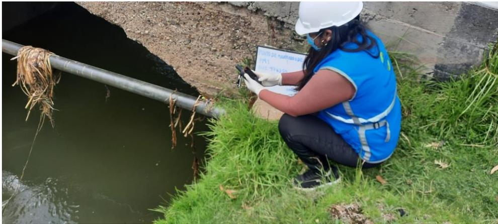
**Figura 3** Identificación de las coordenadas del punto de muestreo del Canal CIMIRM con GPS calibrado.
