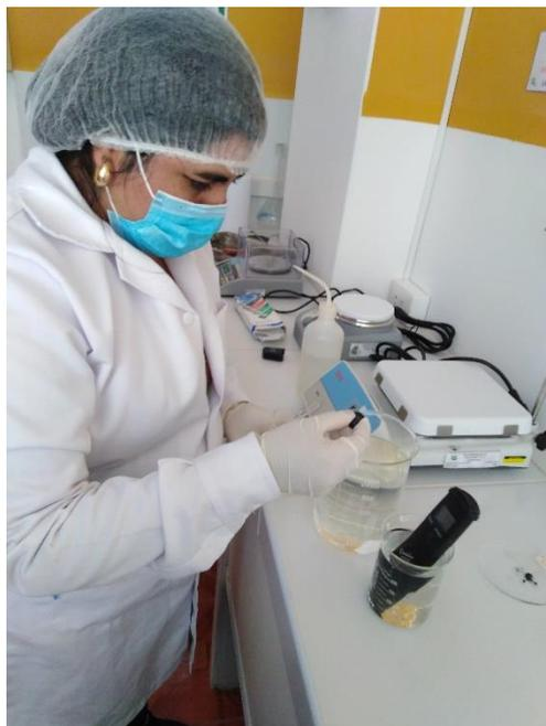
**Figura 21** Colocar el agua sin tratar en un vaso de 100 mL y ajustar el pH a 5 con ácido clorhídrico
