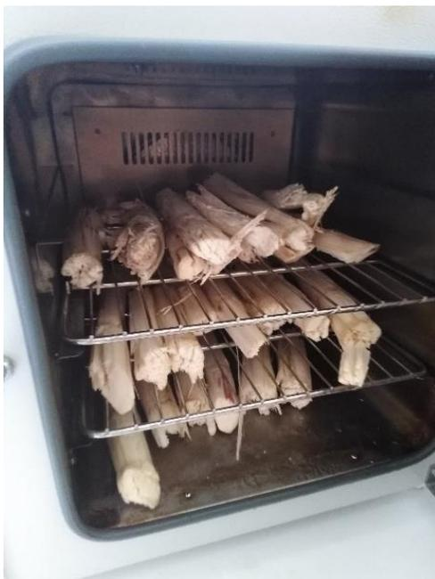
**Figura 11** Colocar el bagazo en el horno a 105 °C
