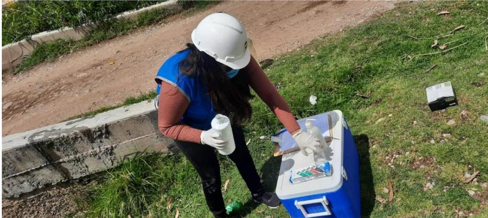
**Figura 6** Medición de los parámetros fisicoquímicos con pHmetro calibrado
