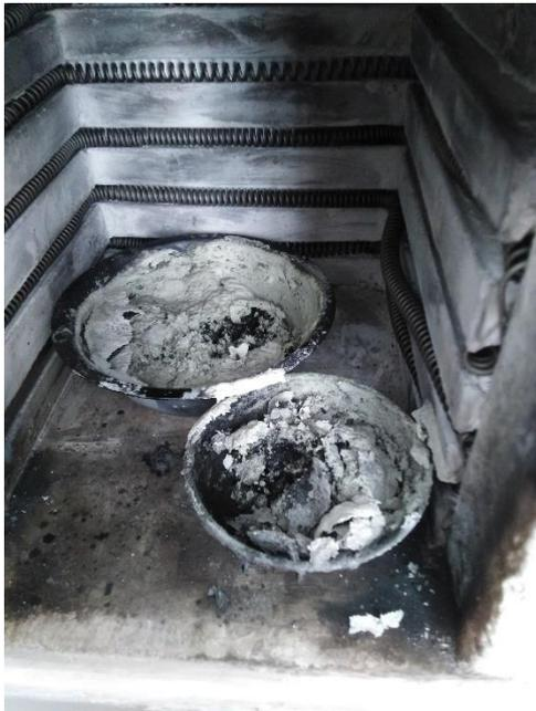
**Figura 18** Retirar el carbón después de los 2 ciclos
