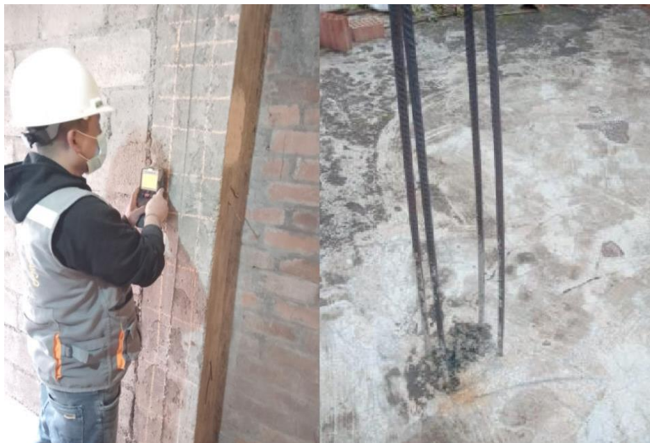
Figura 15: Ubicación de acero existente
