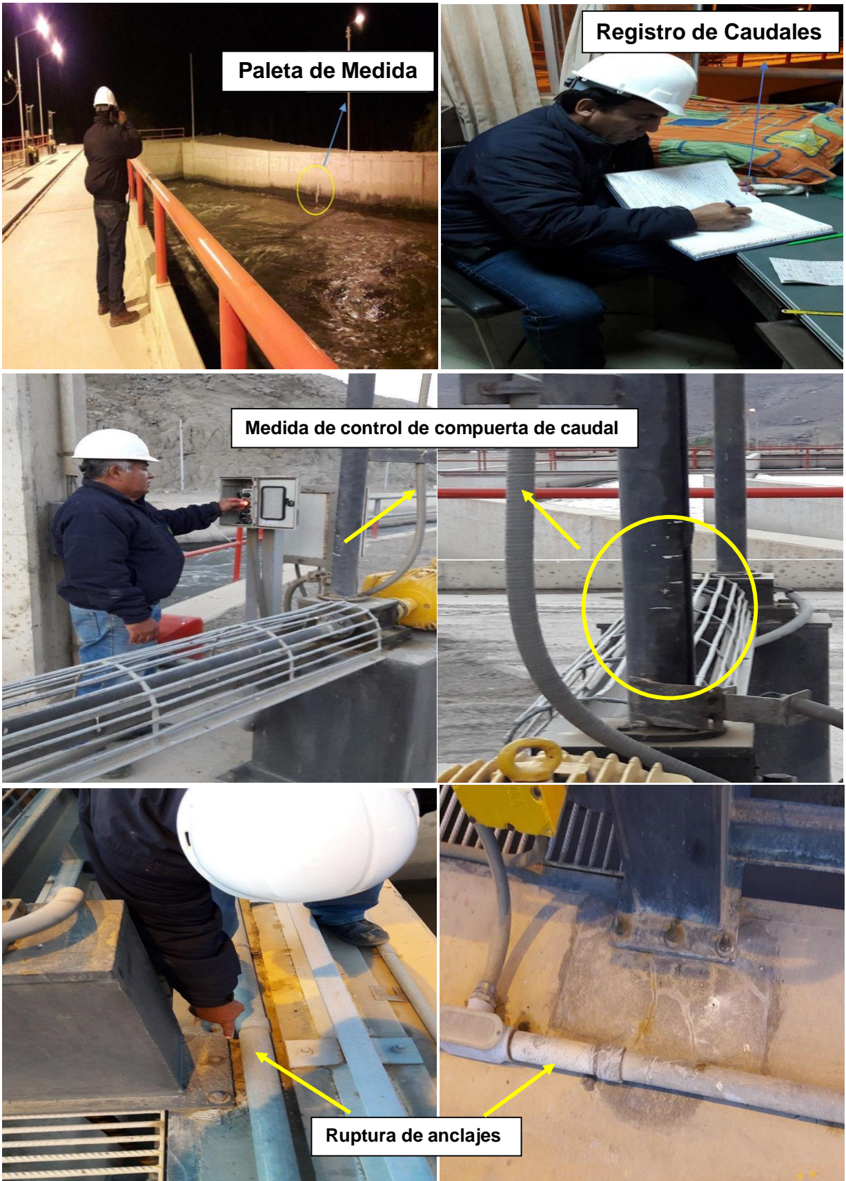
Medición de caudales, registro y ruptura de anclajes que se dan en el desarenador
