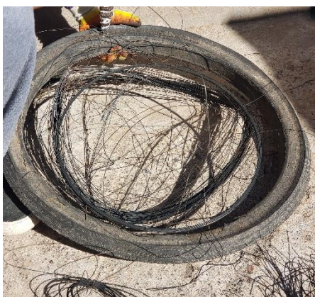
Figura 13. Proceso de extracción del acero reciclado de neumáticos
