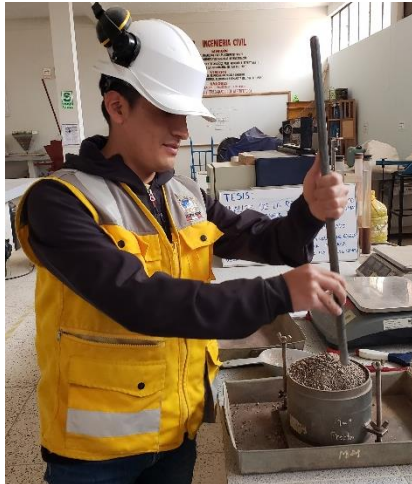
Figura 31. Ensayo de Peso Unitario agregados finos
