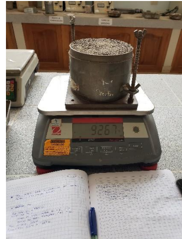
Figura 32. Ensayo de Peso Unitario suelto y varillado de los agregados finos
