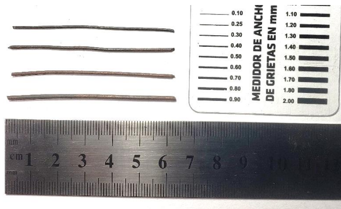
Figura 15. Propiedades físicas de alambres de acero reciclado de neumáticos
