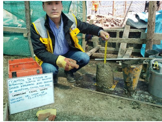
Figura 38. Toma de datos de ensayos de revenimiento
