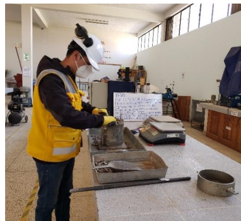
Figura 30. Ensayo de Peso Unitario suelto y varillado de los agregados gruesos
