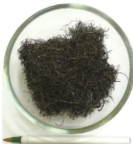
Figura 6. Fibras de acero recicladas Fuente: Martelli (21)
