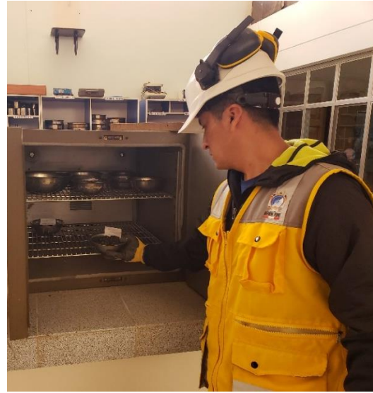
Figura 28. Ensayo de peso específico de agregados finos
