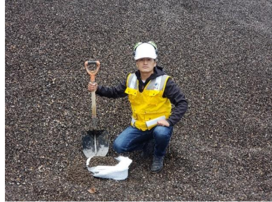
Figura 23. Muestreo de agregados finos
