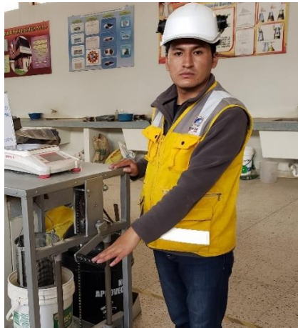
Figura 26. Ensayo de peso específico saturado de agregados gruesos
