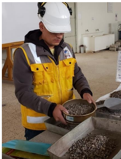
Figura 24. Análisis granulométrico de agregados finos
