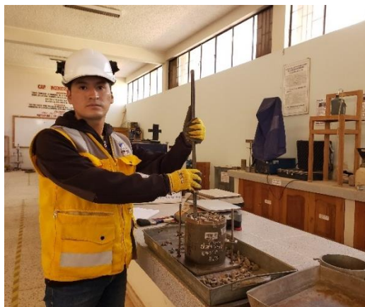
Figura 29. Ensayo de Peso Unitario agregados gruesos
