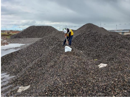
Figura 22. Muestreo de agregados gruesos
