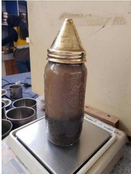
Figura 27. Ensayo de peso específico saturado de agregados finos
