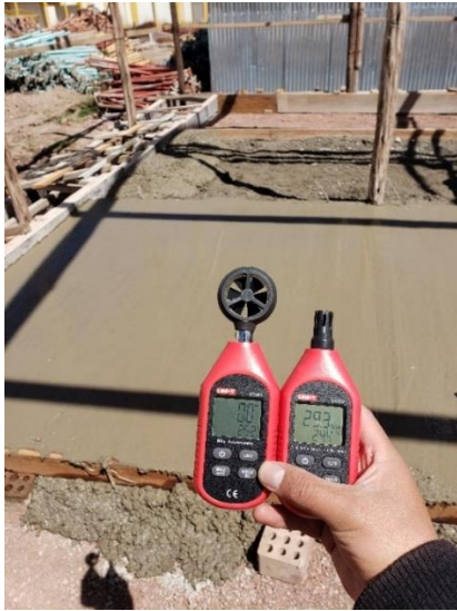
Figura 39. Toma de datos: a. temperatura ambiental, b. Velocidad del viento, c. Humedad ambiental
