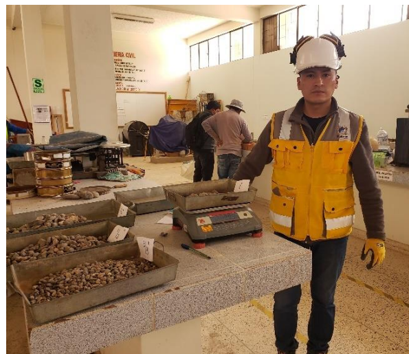
Figura 25. Análisis granulométrico de agregados gruesos
