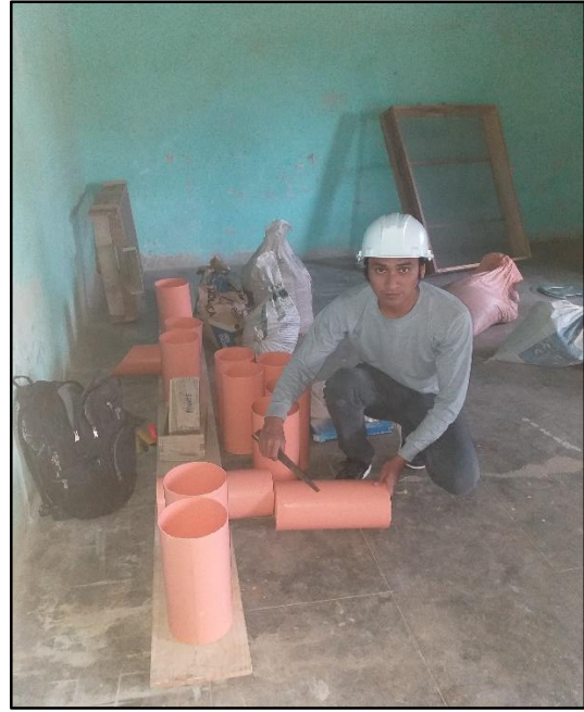
Corte de tubería de 6'' para la fabricación de moldes de cilindros de 6'' x 12'' para aplicar el ensayo de Ensayo De Resistencia A La Tracción Indirecta Por Compresión Diametral basado en la Norma E.080 DISEÑO Y CONSTRUCCIÓN CON TIERRA REFORZADA (2017).
