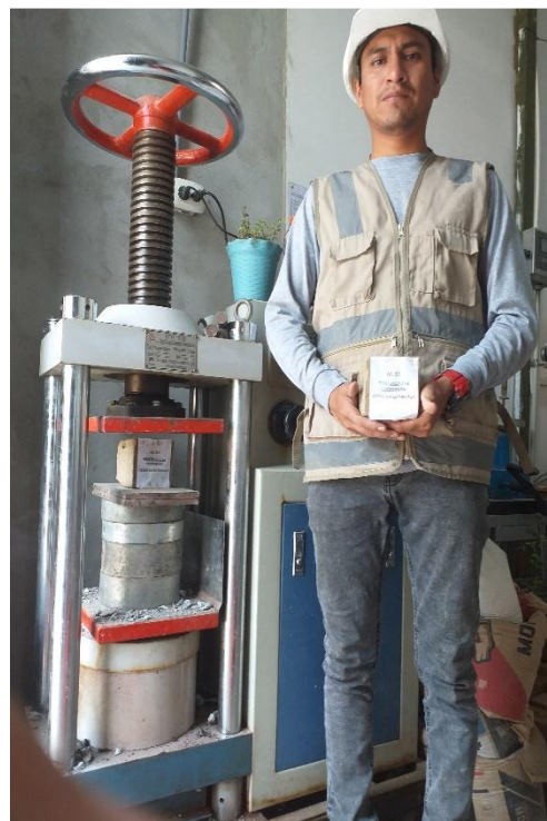
Con una muestra para el ensayo de Compresión al cubo de 10 x 10 x 10 cm.
