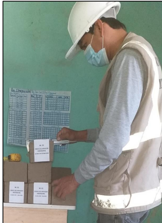
Aplicando el Ensayo de Variación Dimensional, tomando las medidas Correspondientes a los Adobes de la Muestra -N° 02 – Valladolid.
