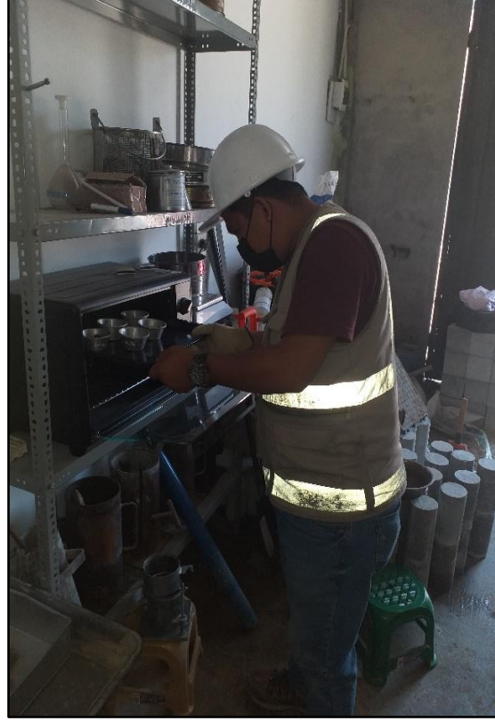
Secado de las pruebas para proceder a tomar sus pesos para el ensayo de Limite Liquido.
