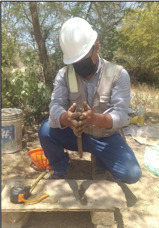
Prueba de Plasticidad / Prueba de rollo.
