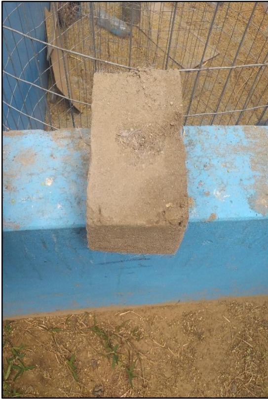
Muestra obtenida con mejor resultado De 0.55% de fibras y 15% RCD.
