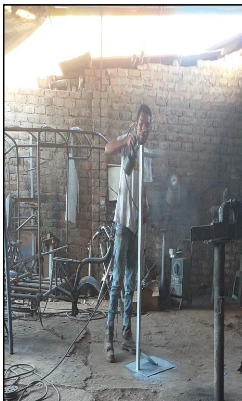
Pintado de la estructura de la máquina.
