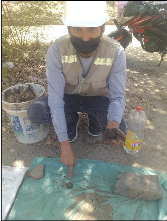
Prueba de presencia de arcilla o resistencia Seca.
