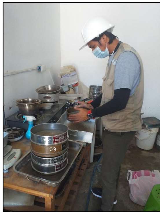
Ensayo de Granulometría por Tamizado.
