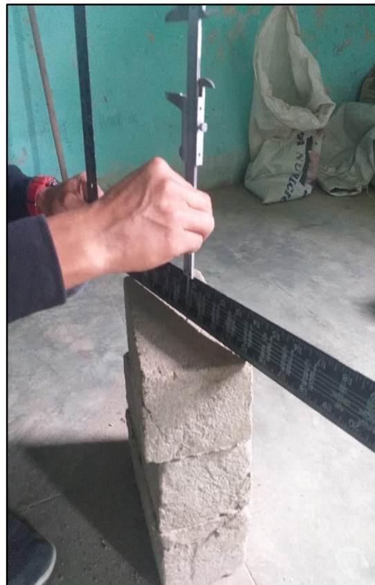
Toma de medidas para el ensayo de Alabeo de las unidades del Adobe para ambas muestras de tipo de Suelo M N° 01 y M N° 02.
