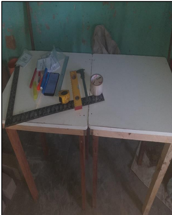
Herramientas, equipos: Wincha, regla, Nivel para tomar las medidas de las dimensiones de las Unidades de Adobe.
