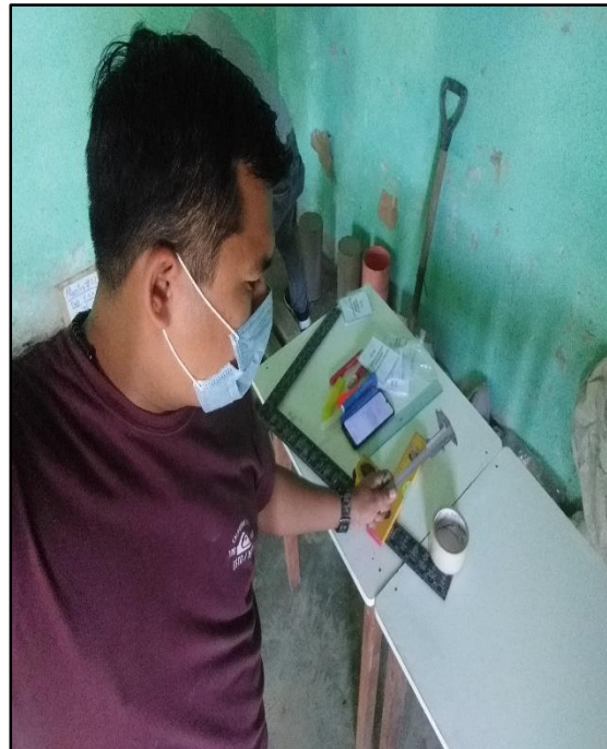
Herramientas, equipos: Wincha, regla, Nivel para tomar las medidas de las dimensiones de las Unidades de Adobe.
