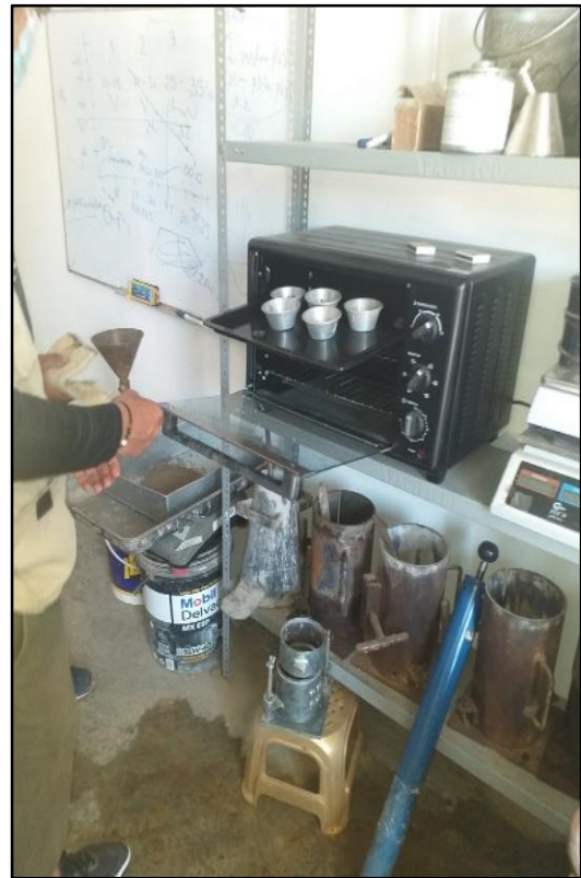
Ensayo de Limite Liquido – se procede a secar en el horno para sacar el valor del límite líquido.
