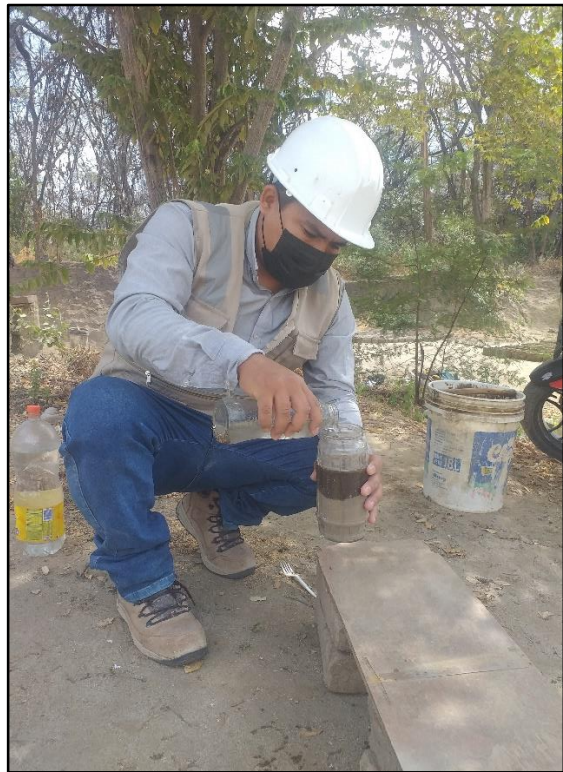
Llenado de los componentes en la botella para la prueba de Granulometría en campo.
