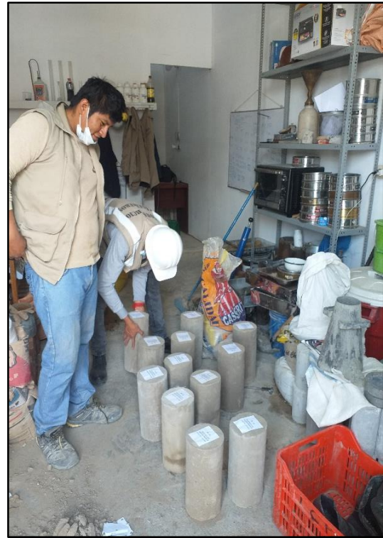
Seleccionado las muestras para el ensayo de Resistencia de Tracción Indirecta por Compresión Diametral a las muestras en Forma de cilindro.
