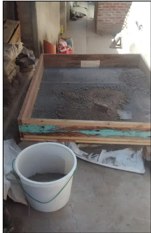
Tamizado del suelo por el tamiz de N° 4 mm para la elaboración de los especímenes.
