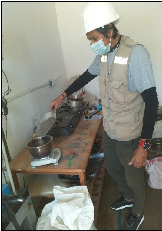
Pesado de muestras para el ensayo de contenido de humedad.
