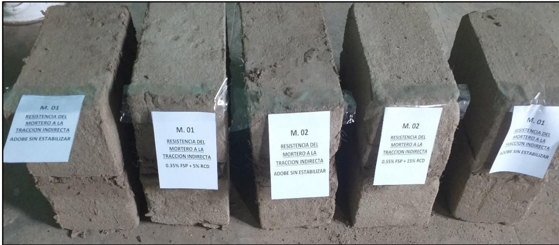
Muestras con su etiqueta cada una, para el Ensayo de Resistencia al Mortero a la Tracción Indirecta para la muestra N° 01 – García y Muestras N°02 – Valladolid.
