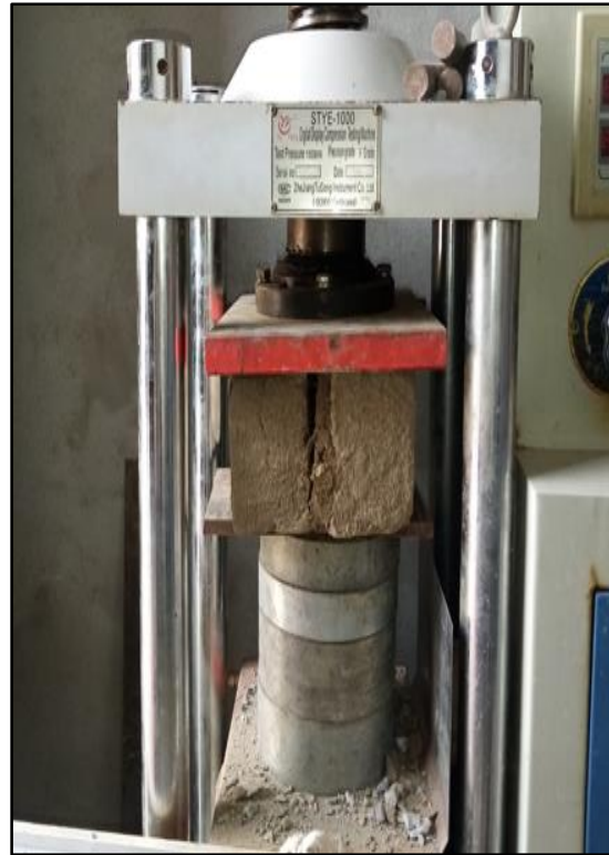
Se observa en el momento que la muestra llega a su máxima Resistencia del Mortero a la Tracción Indirecta.
