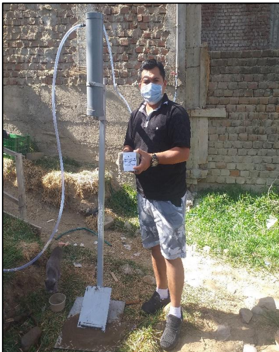
Listos para el ensayo de Erosión Acelerada Junto a la máquina que se hizo para aplicar este ensayo.
