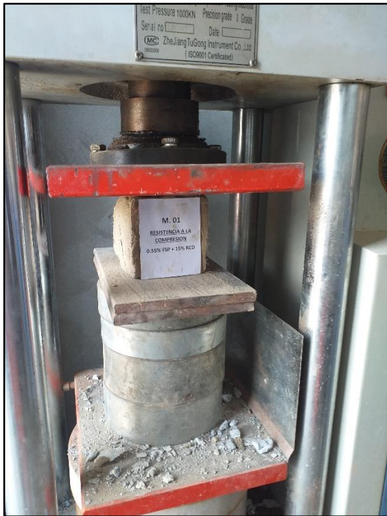
Se observa al cubo aplicándole la fuerza De Compresión para establecer su Resistencia.
