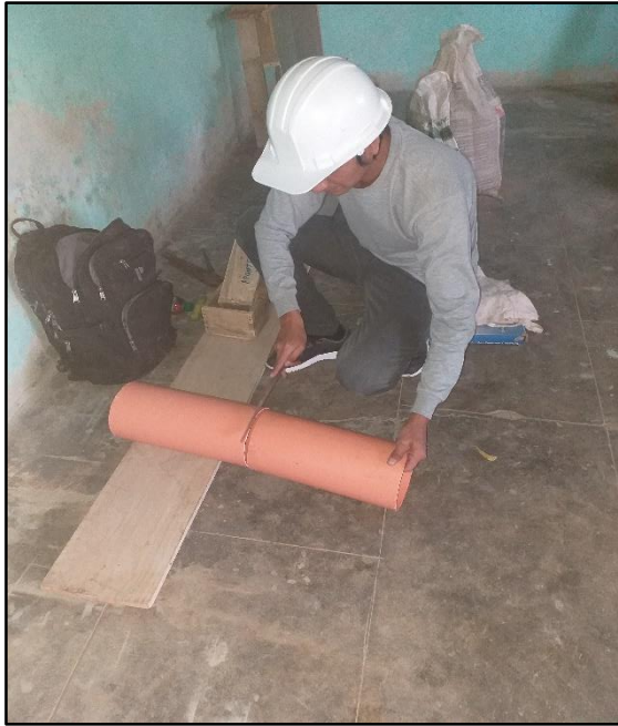
Corte de tubería de 6'' para la fabricación de moldes de cilindros de 6'' x 12'' para aplicar el ensayo de Ensayo De Resistencia A La Tracción Indirecta Por Compresión Diametral basado en la Norma E.080 DISEÑO Y CONSTRUCCIÓN CON TIERRA REFORZADA (2017).
