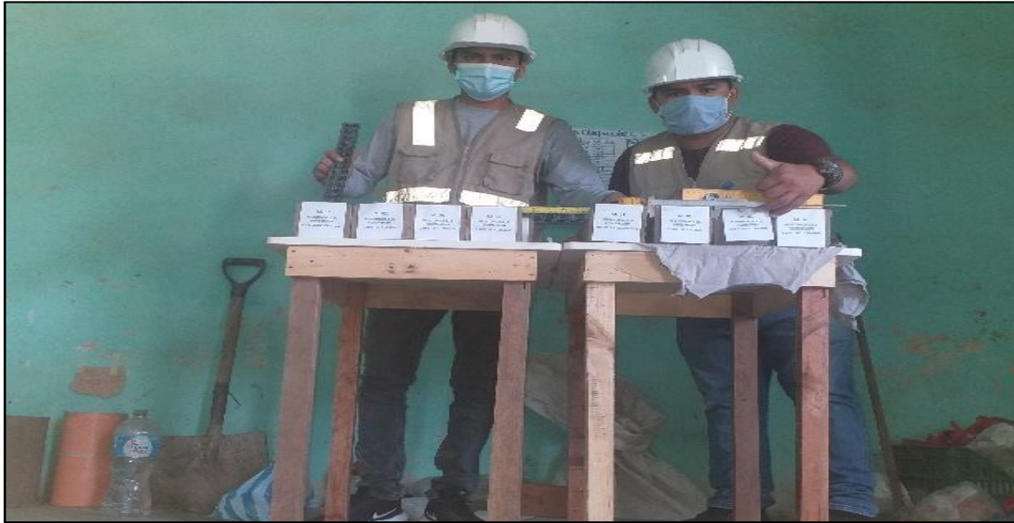
Tomando medidas de las dimensiones de los Cubos de: 10 x 10 x 10 cm; para su ensayo previo de Resistencia a la Compresión en el Laboratorio ITLO-PIURA.
