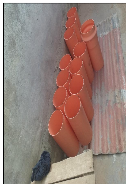
Molde de PVC para cilindros de 6'' x 12'' o 15.24 cm x 30.48 cm de diámetro y largo.
