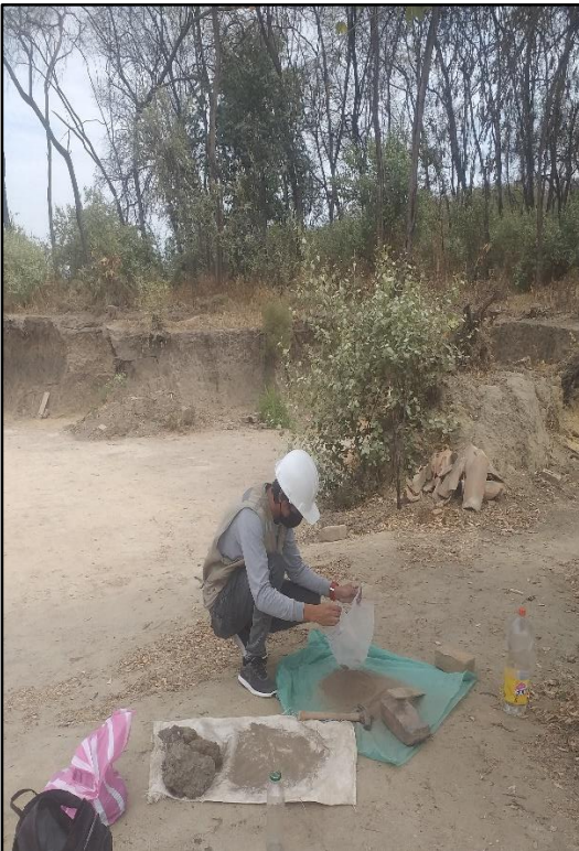
Tamizado del Suelo por malla N° 04mm.
