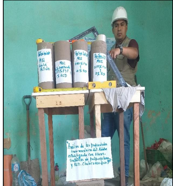
Toma de datos de las dimensiones de los especímenes (Cilindro = de 6'' x 15'') para el ensayo de Resistencia a la Compresión Indirecta por Compresión Diametral de ambas muestras.
