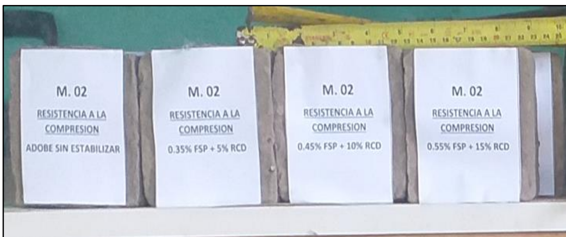
Muestra N° 02 – Valladolid – Chulucanas con sus etiquetas correspondientes para que lleven un orden estricto y separados por dosificación para previo ensayo de compresión.
