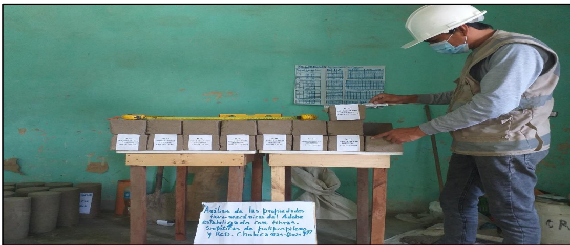
Toma de medidas y etiquetado de las muestras para su ensayo de Variación Dimensional a las unidades de Adobe tanto a la M-N°01 y M-N°02.
