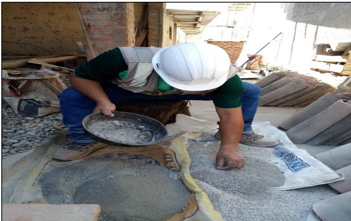
RCD ya tamizado se procede a ser pesado por cada dosificación que se pretende dar en el proyecto.
