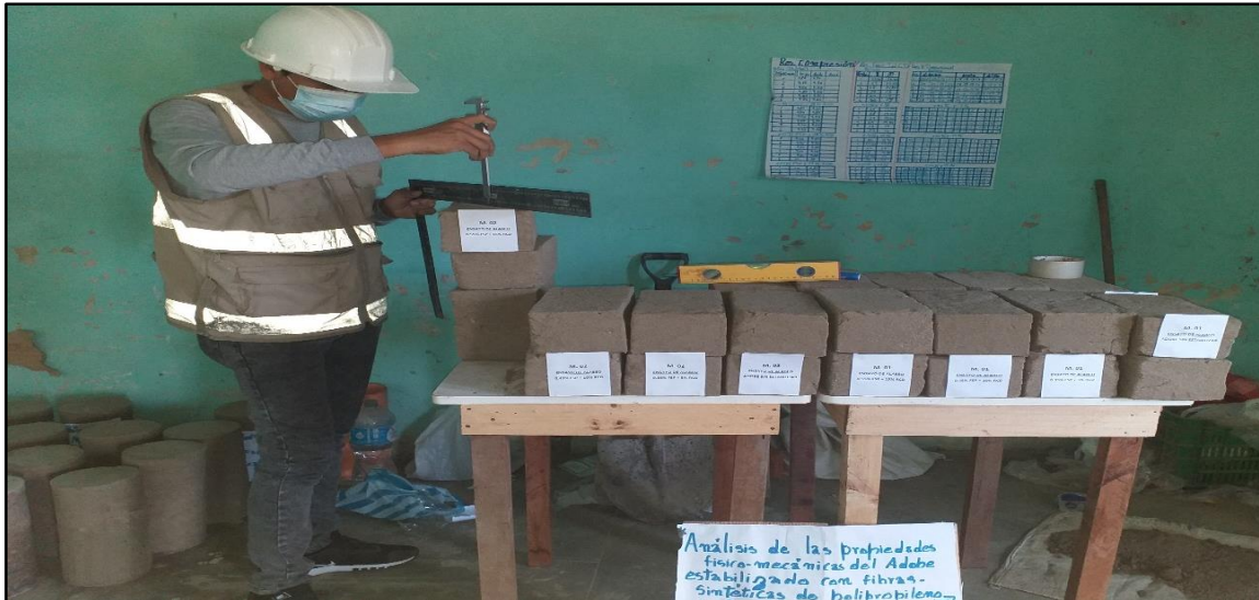
Toma de medidas de Alabeo a las dos muestras con su respectivo etiquetado para llevar un orden a la hora de hacerle su ensayo y clasificarlas por su dosificación.
