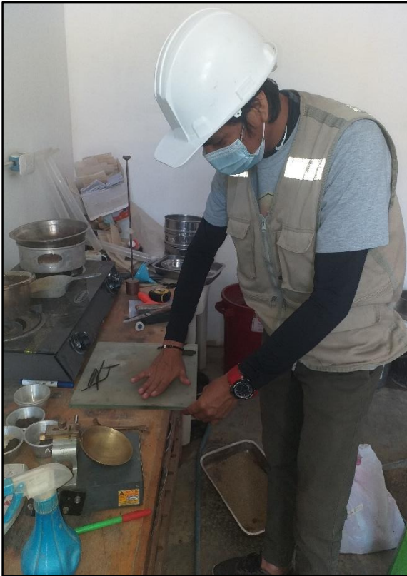
Ensayo de Limite Plástico(LP) elaboración de pequeñas esferas con la palma de la mano.
