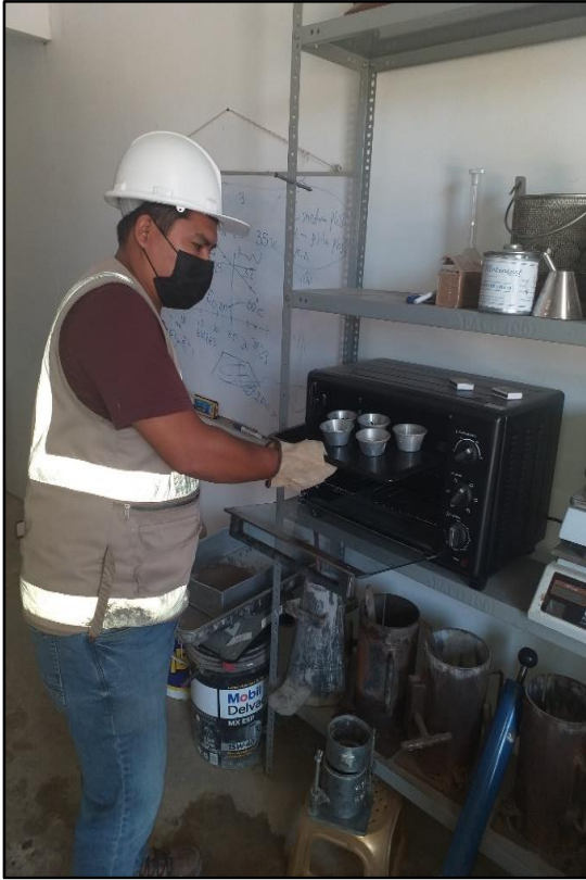
Secado de las pruebas para proceder a tomar sus pesos para el ensayo de Limite Liquido.
