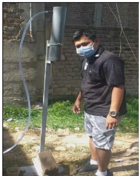
Una muestra del Adobe ya en posición inclinada a los 27° grados cayéndole el Chorro de agua como indica la norma Española 4141- AENOR.
