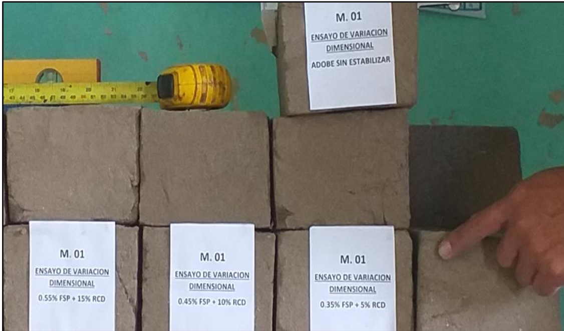
Especímenes de la M Nº 01 – García. para su ensayo de Variación Dimensional.
