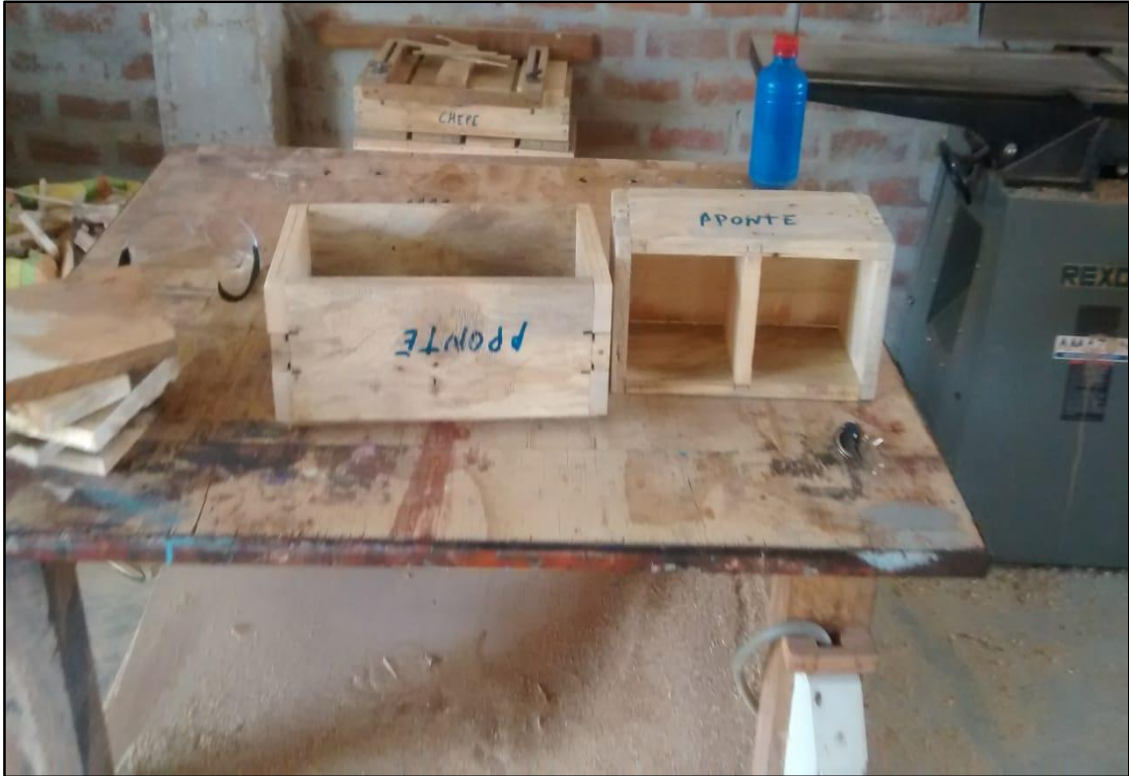
Gabera de 0.10 x 0.13 x 0.26 cm para fabricación de los especímenes normales. Gabera de 0.10 x 0.10 x 0.10 cm (cubos) fabricados para el ensayo de compresión.
