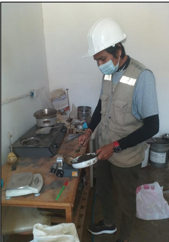
Preparado de pasta del suelo para el ensayo de Limite Liquido (LL)
