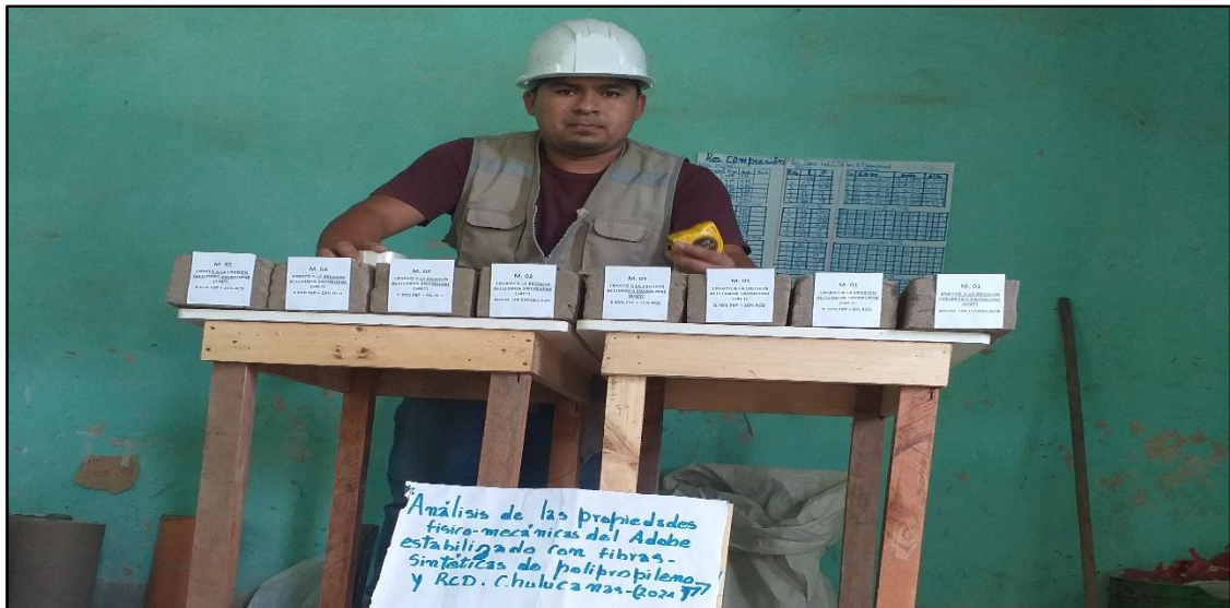
Muestras con su etiqueta correcta previa antes de llevar a realizarse el ensayo de Erosión Acelerada en base a la Norma Española 41410 AENOR.
