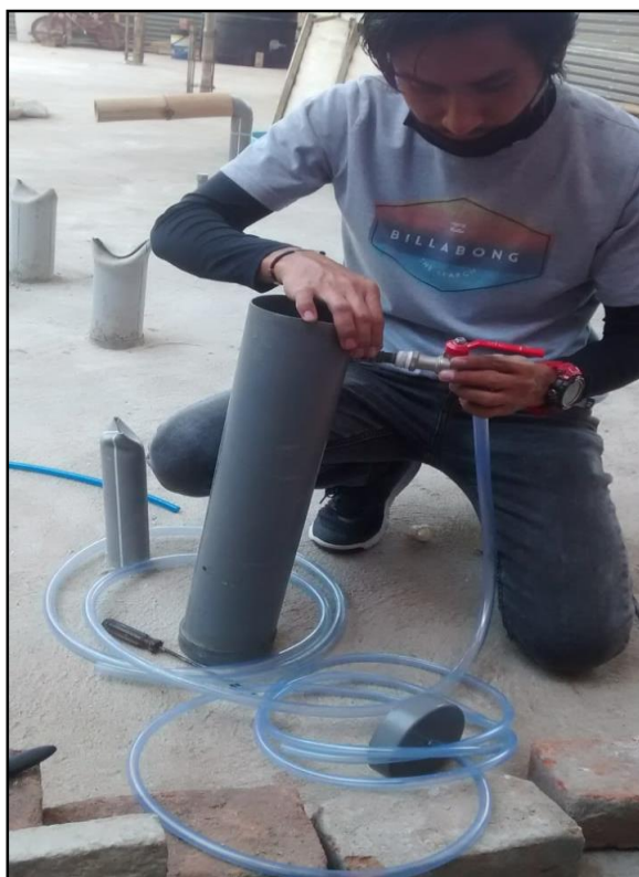
Instalación de la alimentación de agua para el cilindro y de salida para el chorro que caerá a al Adobe.
