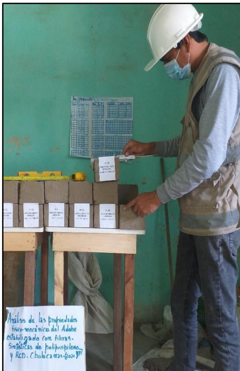
Aplicando el Ensayo de Variación Dimensional, tomando las medidas Correspondientes a los Adobes de La Muestra -N° 01 – García.
