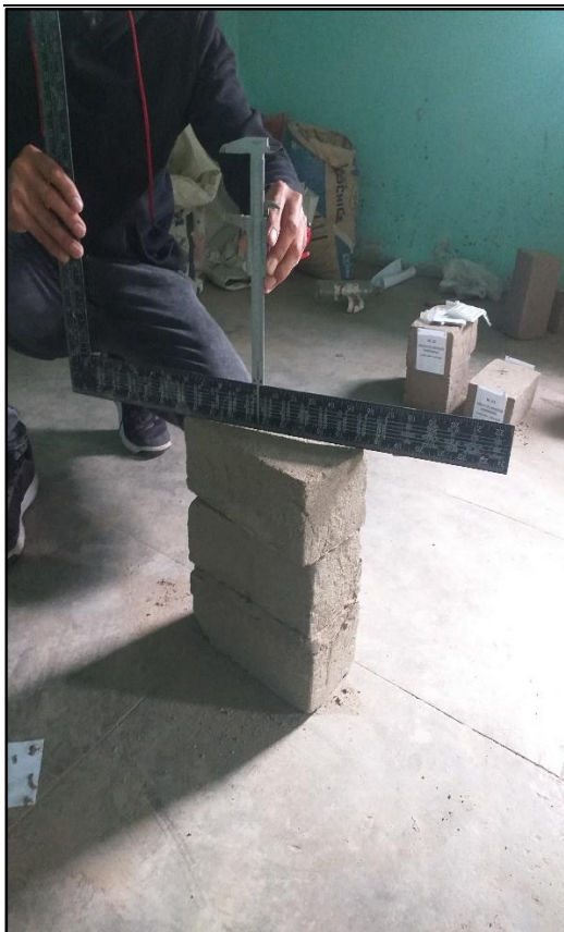
Toma de medidas para el ensayo de Alabeo de las unidades del Adobe para ambas muestras de tipo de Suelo M N° 01 y M N° 02.
