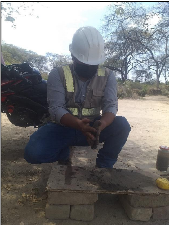
Trabajando el suelo para el ensayo de prueba de cinta de barro.
