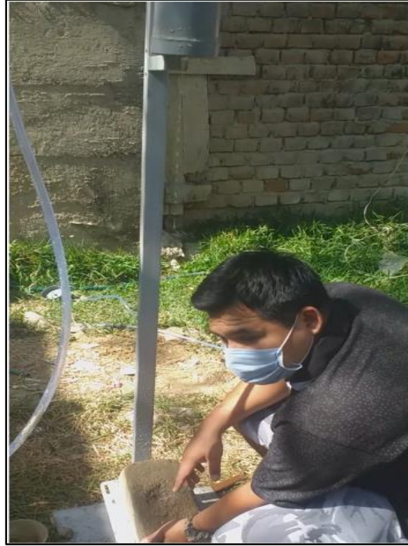
Mostrando a detalle la oquedad en el momento que el chorro impacta con el Adobe
