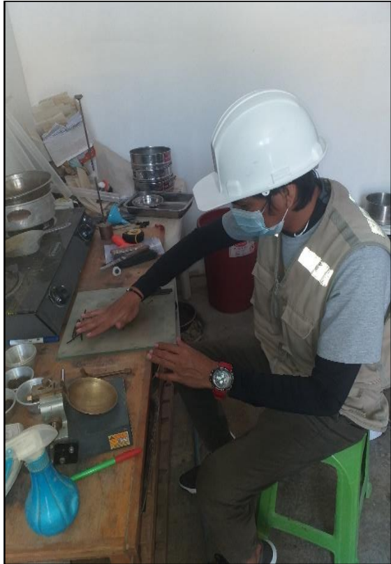
Ensayo de Limite Liquido – se procede a secar en el horno para sacar el valor del límite líquido.
