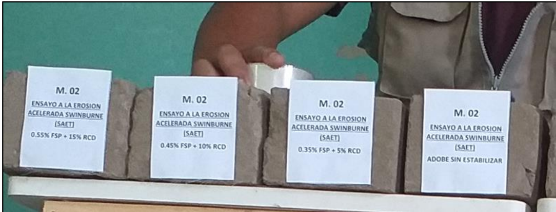
Etiquetas de M-N° 02-Valladolid, con sus dosificaciones correspondientes dese la muestra patrón para aplicarles el ensayo de Erosión Acelerada.
