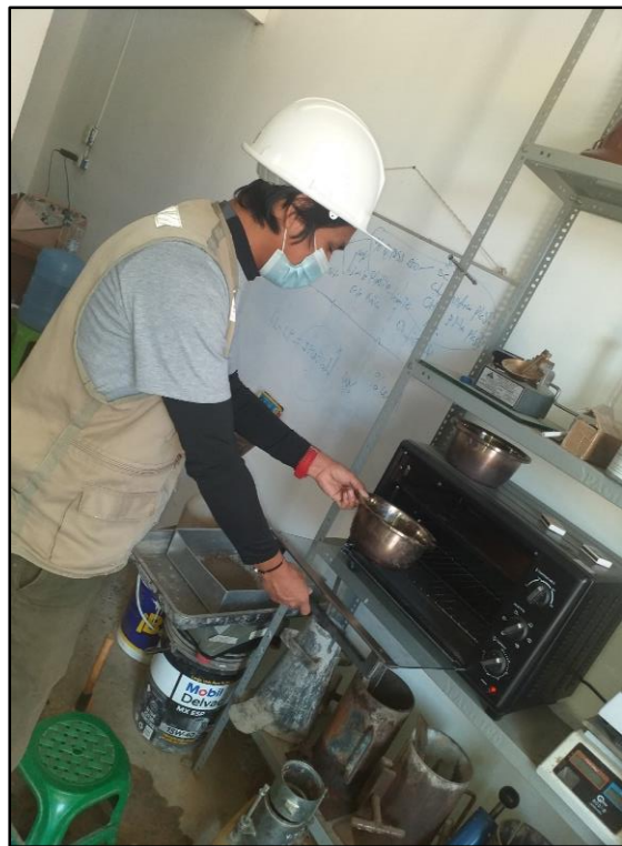
Especímenes en el proceso de secado para el ensayo de Contenido de humedad.
