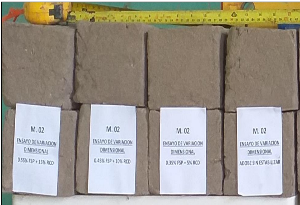
Especímenes de la M Nº 02 – Valladolid - para su ensayo de Variación Dimensional.
