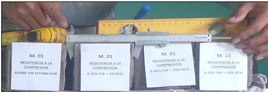
Muestra N° 01 – García –Chulucanas; con sus etiquetas después de tomar sus medidas para que se les aplique la Prueba de Resistencia a la Compresión.
