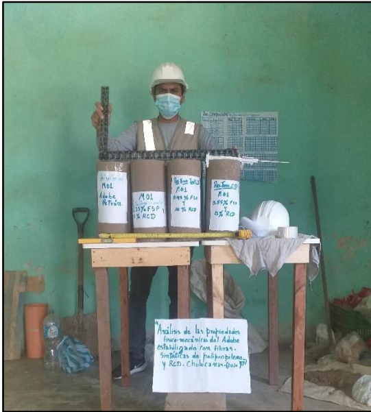
Toma de datos de las dimensiones de los especímenes (Cilindro = de 6'' x 15'') para el ensayo de Resistencia a la Compresión Indirecta por Compresión Diametral de ambas muestras.
