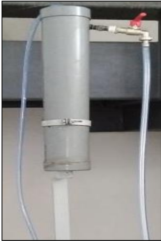
Se muestra la entrada de agua, la de rebose y la de salida que cae al Adobe.
