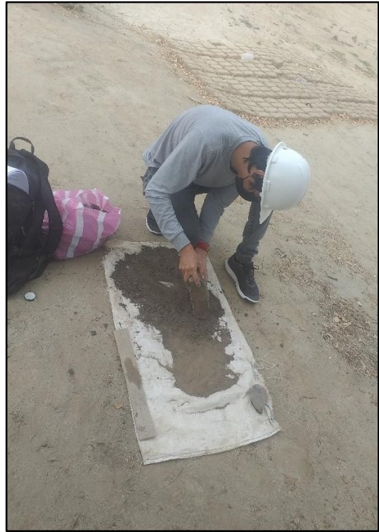
Trituración del Suelo para tamizado y realizar Prueba de Granulometría empírica.
