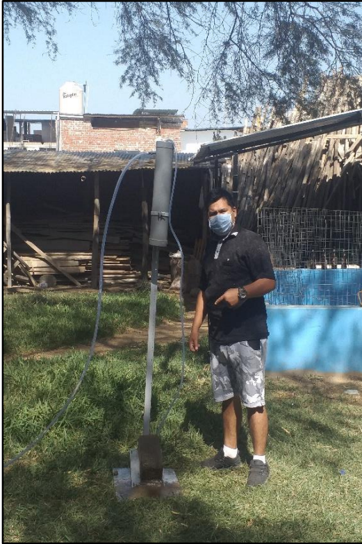
Mostrando otra muestra que aplicándole El Ensayo de Erosión Acelerada.
