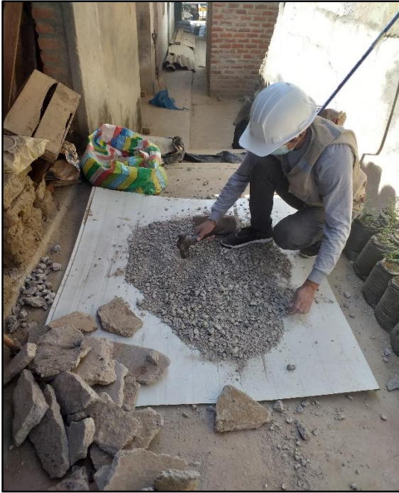
Debajo de los RCD se usó una plancha de Latón para que no tengan contacto directo con M.O.
