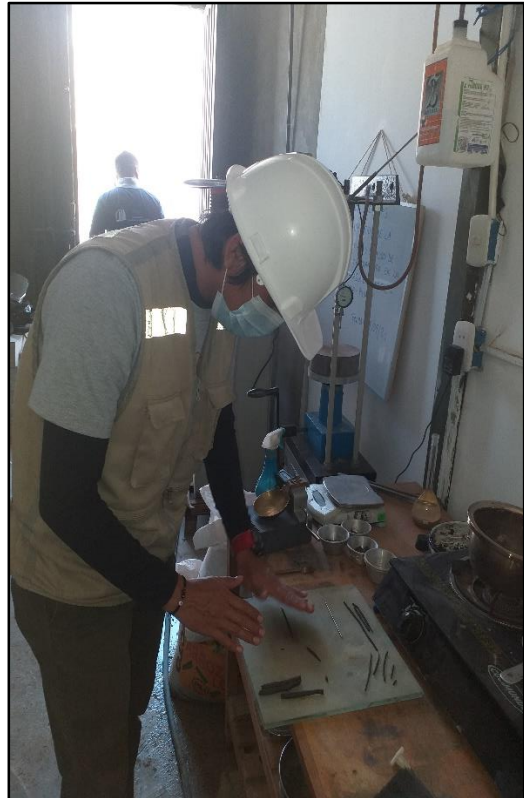
Elaboración de cilindros sobre un vidrio Esmerilado.
