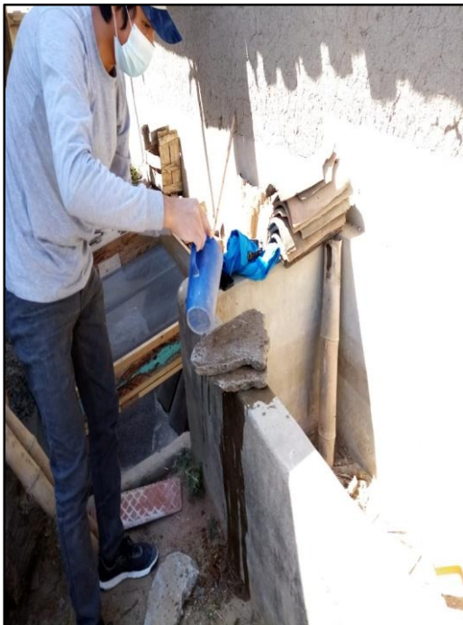
Lavado y limpieza de los RCD, para que este libre de materia orgánica y siga al proceso de secado
