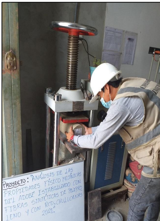
Acomodando el espécimen para la muestra de Resistencia de Tracción Indirecta por Compresión Diametral
