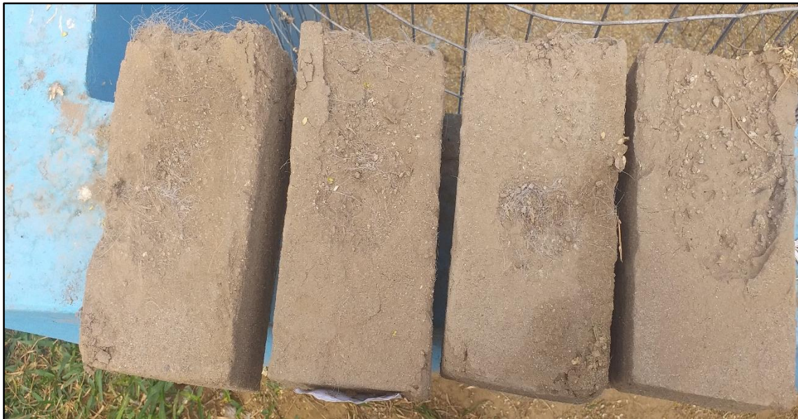
Mostrando las muestras después de haberles aplicado su ensayo de Erosión Acelerada de Swimburne en el orden de la derecha hacia la izquierda: Desde la muestra Patrón, muestra de 0.35% de fibras y 5% RCD; 0.45% de fibras y 10% de RCD; 0.55% de fibras y 15% RCD.
