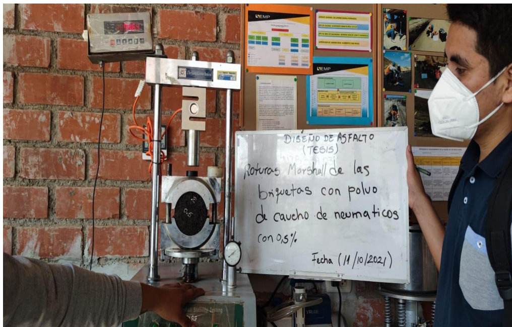
FOTOGRAFÍA 07: Ruptura de Marshall de las briquetas.
