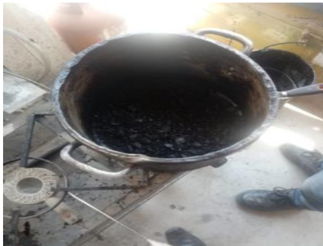
Figura 12. Mezcla del caucho, agregado y asfalto
