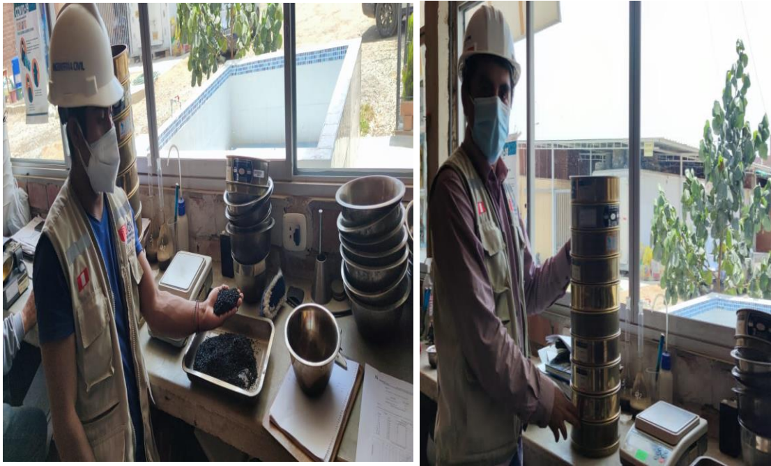
FOTOGRAFÍA 08: Granulometría del polvo de caucho.
