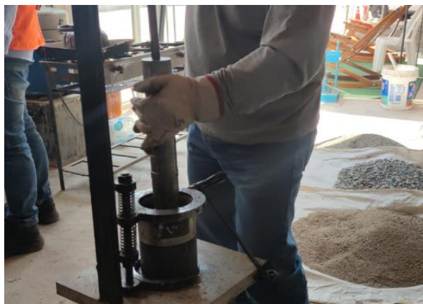
Figura 13. Compactado de briquetas.
