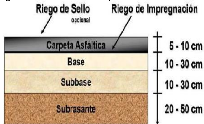
Figura 1. Estructura de un pavimento flexible.
