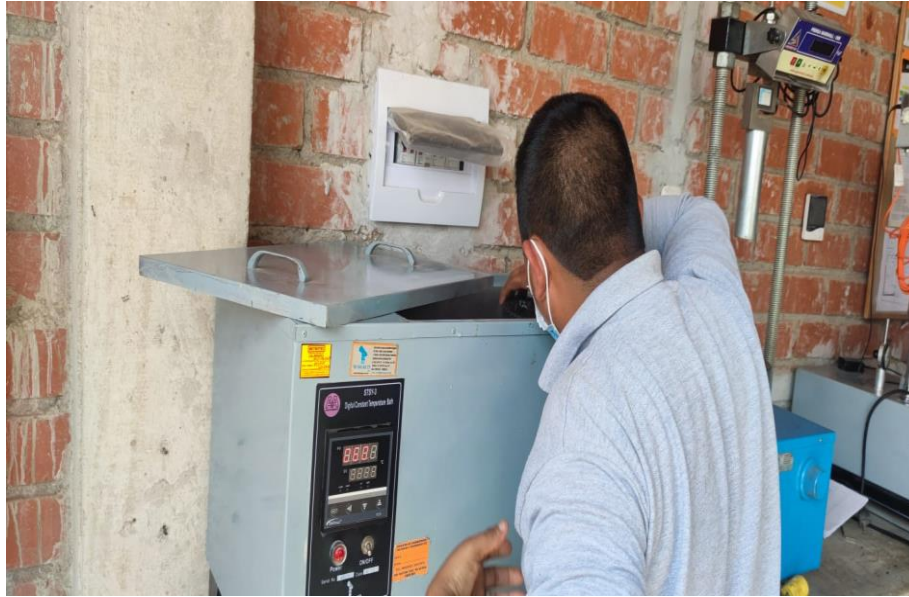
FOTOGRAFÍA 07: Baño María de las briquetas
