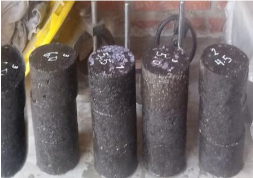
FOTOGRAFÍA 05: Briquetas de mezcla asfáltica convencional.
