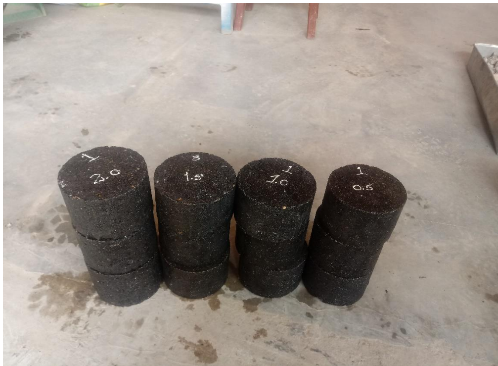
FOTOGRAFÍA 06: Briquetas de mezcla asfáltica con polvo de caucho en proporciones de 0.5%, 1.0%, 1.5% y 2.0%
