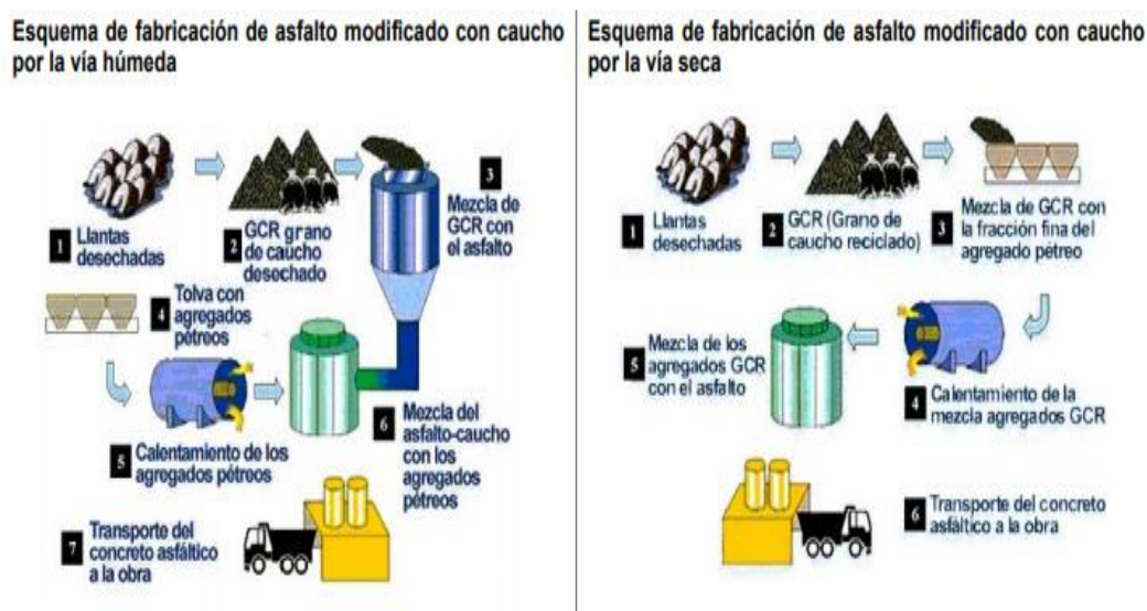
Figura 3. proceso de fabricación de asfalto modificado.
