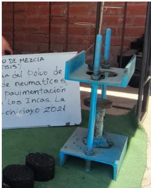
FOTOGRAFÍA 04: Prensa hidráulica para desmoldar las briquetas.
