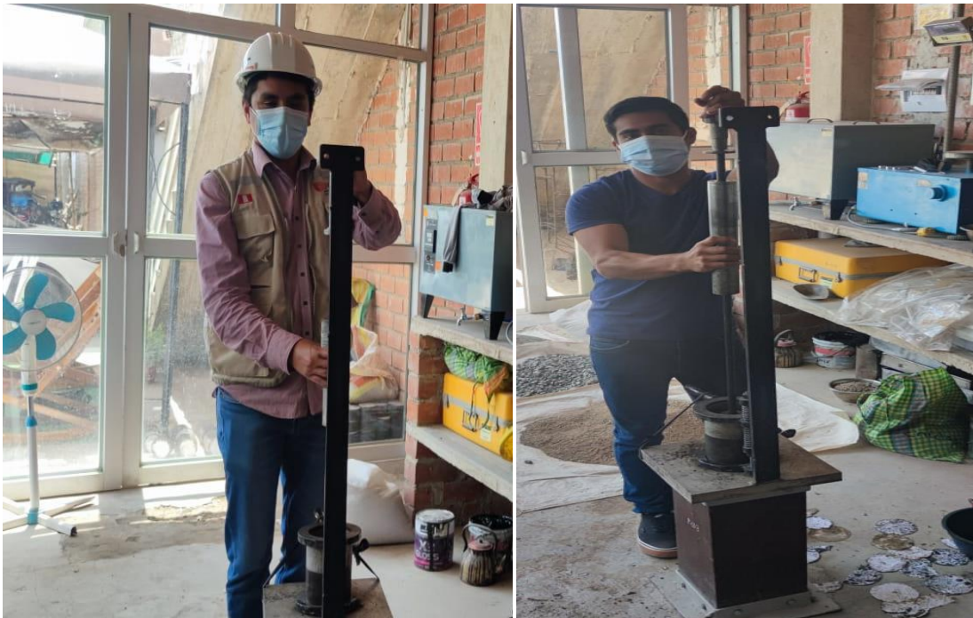
FOTOGRAFÍA 03: Compactado de briquetas con el martillo de Marshall
