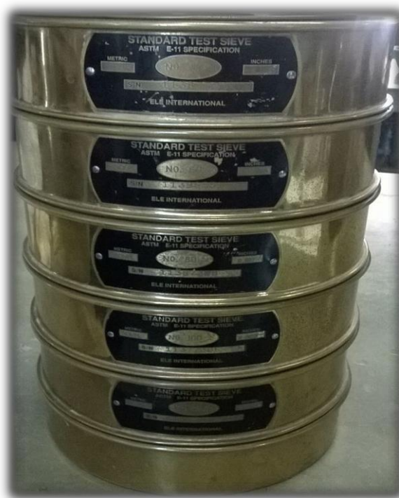
Figura 17. Determinación de granulometría de harina de algarroba con los tamices N° 40, 60, 80, 100 y 200 Nor Astm E-11/95.
