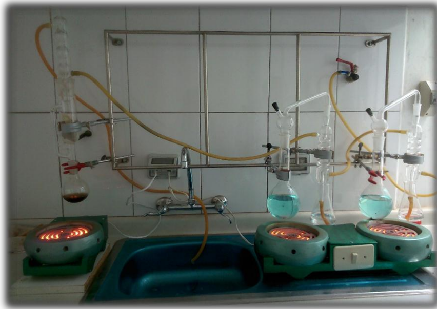
Figura 22. Determinación de proteínas para las galletas con 0%, 4%, 8% y 12% de harina de algarroba con el Método kjeldhal.
