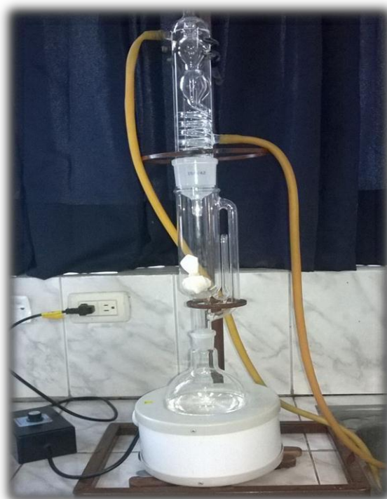
Figura 21. Determinación de grasas para las galletas con 0%, 4%, 8% y 12% de harina de algarroba con el Método Soxhlet.
