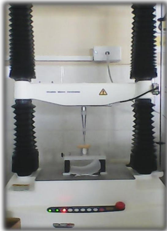
Figura 18. Determinación de textura para las galletas con tratamientos 0%, 4%,8% y 12% de harina de algarroba con el texturometro TA-HD plus, serie 6002.
