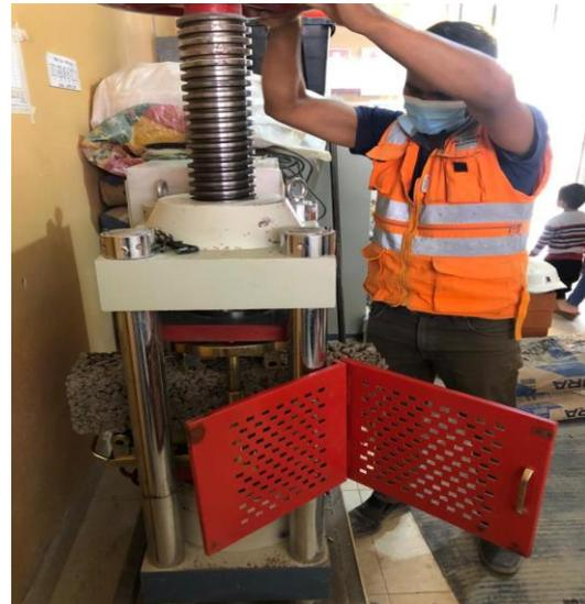
Figura 19. Momento de la rotura de la viga de concreto.
