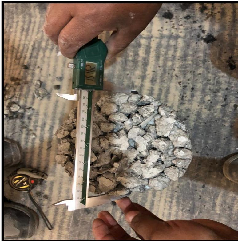
Medidas del testigo para someter a la resistencia a compresión
