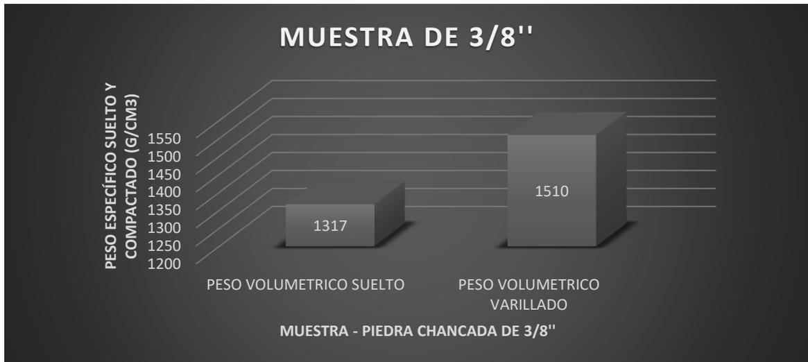
Figura 13. Gráfico de Peso Volumétrico Suelto y Peso Volumétrico Compactado para muestra de 3/8".
