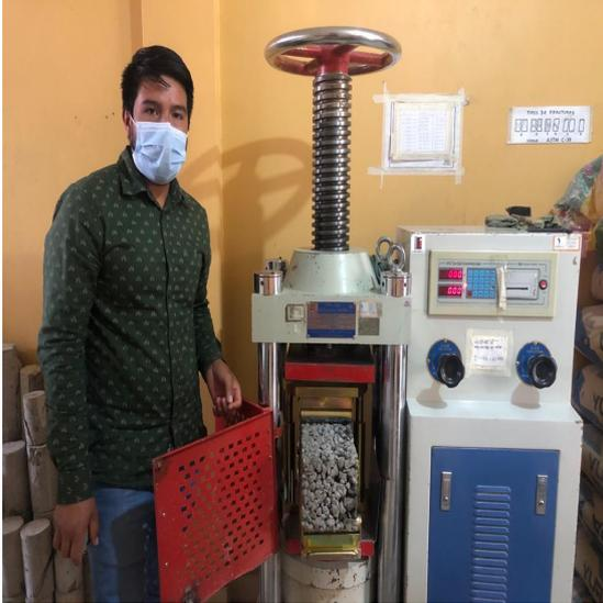
Figura 18. Colocado de la viga de concreto para rotura.
