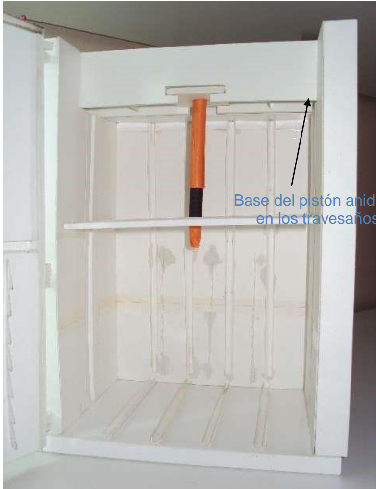
Fotografía N°26: Vista frontal interior de la prensa hidráulica y de la base del pistón anidada en los travesaños.
