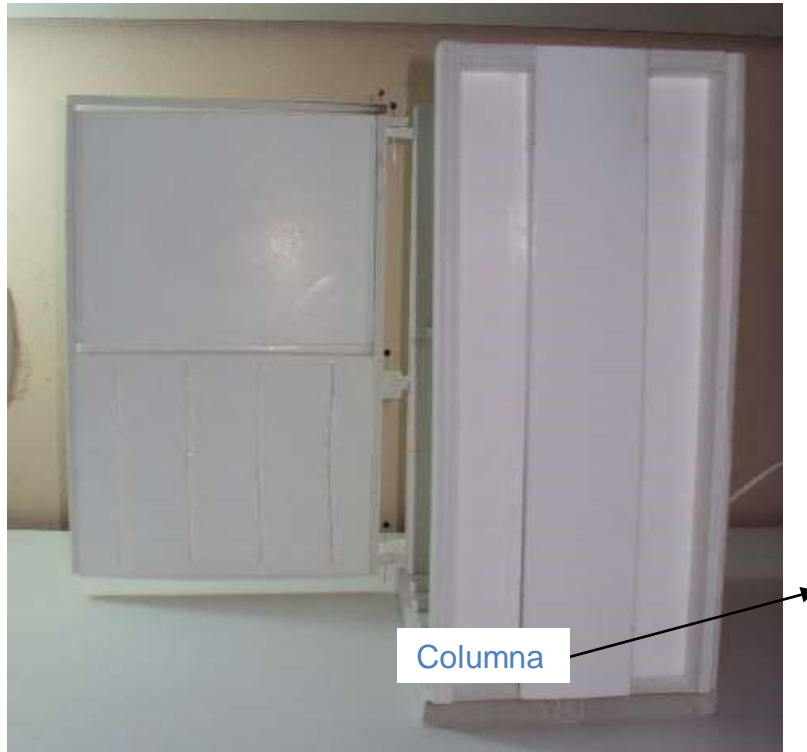
Fotografía N° 23: Vista lateral de la prensa hidráulica y de la columna lateral derecha. Las puertas de alimentación abiertas.
