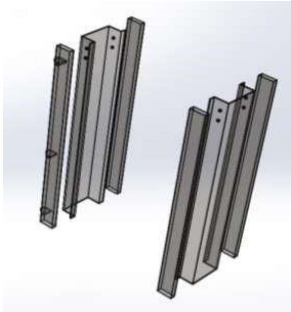
Figura N° 33: Vista Isométrica de las Columnas 01 y 02
