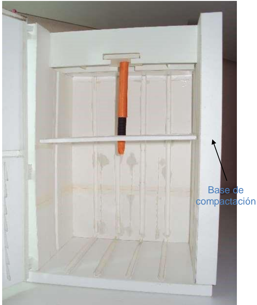
Fotografía N°29: Vista frontal de la base de compactación para la formación de las pacas de cartón.
