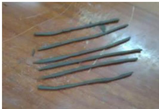
Figura 2. Barras cilíndricas para el cálculo del límite plástico
