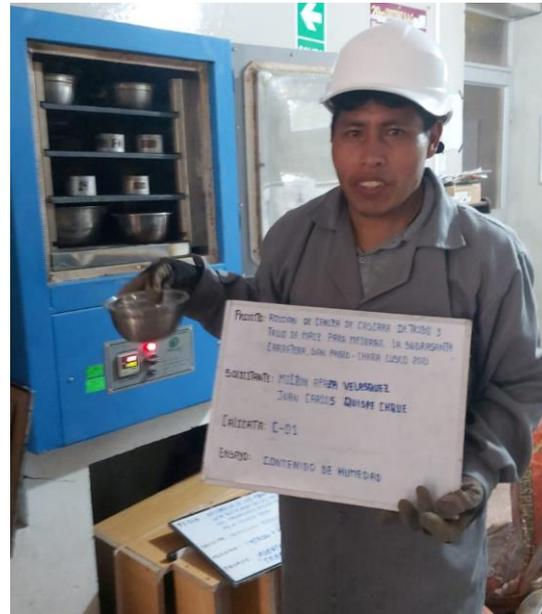
Figura 18. Se pone la muestra al horno.
