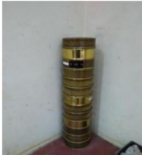
Figura 3. Tamices para los ensayos granulométricos
