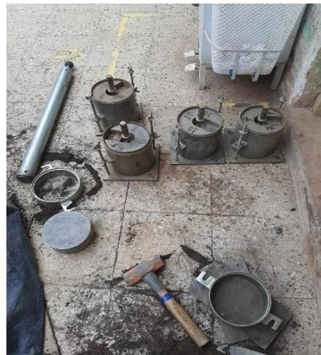
Figura 25. Proctor modificado con ceniza.
