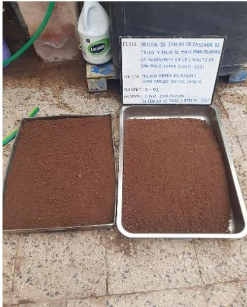
Figura 17. El secado del material para su respectivo cuarteo.
