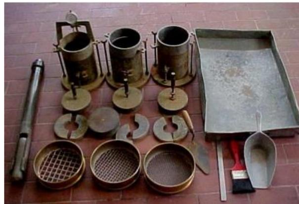
Figura 6. Equipo para el ensayo CBR
