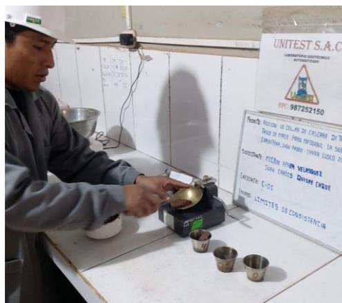
Figura 15. Ensayo en copa de casagrande.
