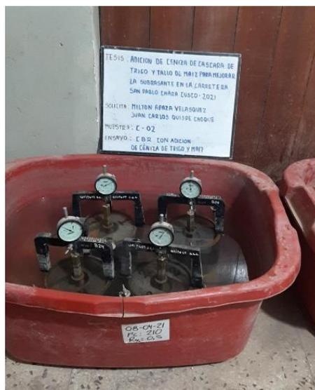
Figura 22. Muestra sumergida para cálculo de % de absorción.
