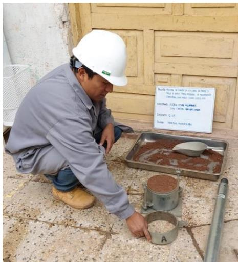
Figura 24. Proctor modificado por capas.
