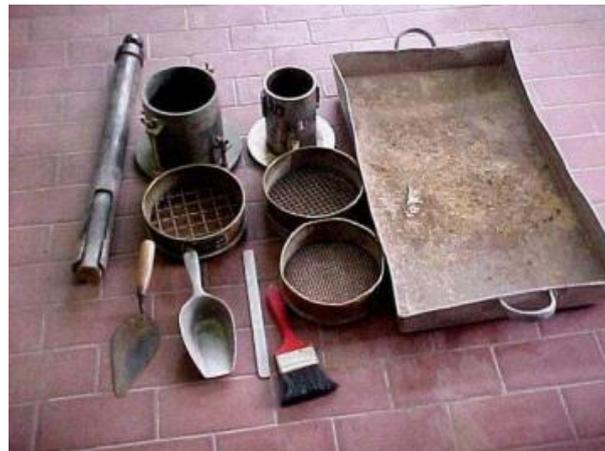
Figura 4. Equipo para el ensayo proctor modificado
