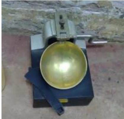
Figura 1. Equipo para el cálculo del límite líquido
