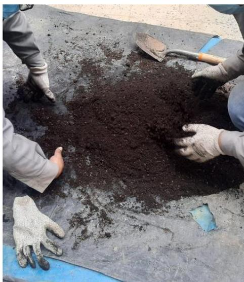
Figura 21. Mezclado de suelo con ceniza.
