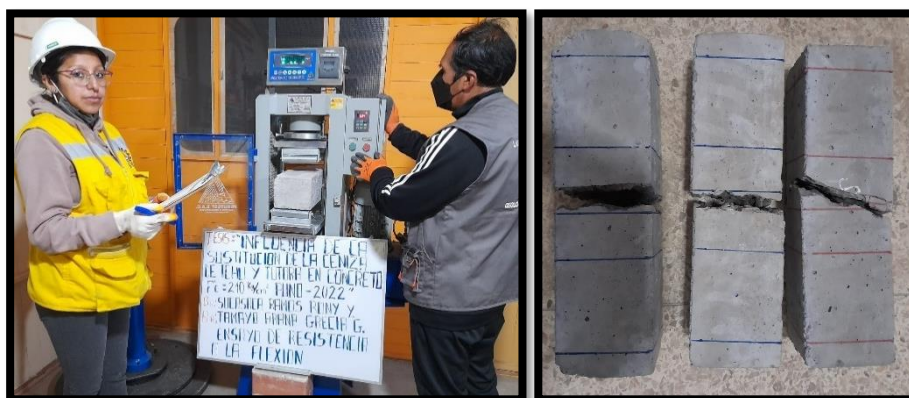
Figura N°47: Ensayo de resistencia a flexión en vigas de concreto.
