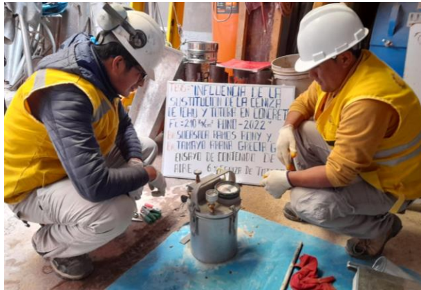
Foto 33: Ensayo de contenido de aire atrapado.
