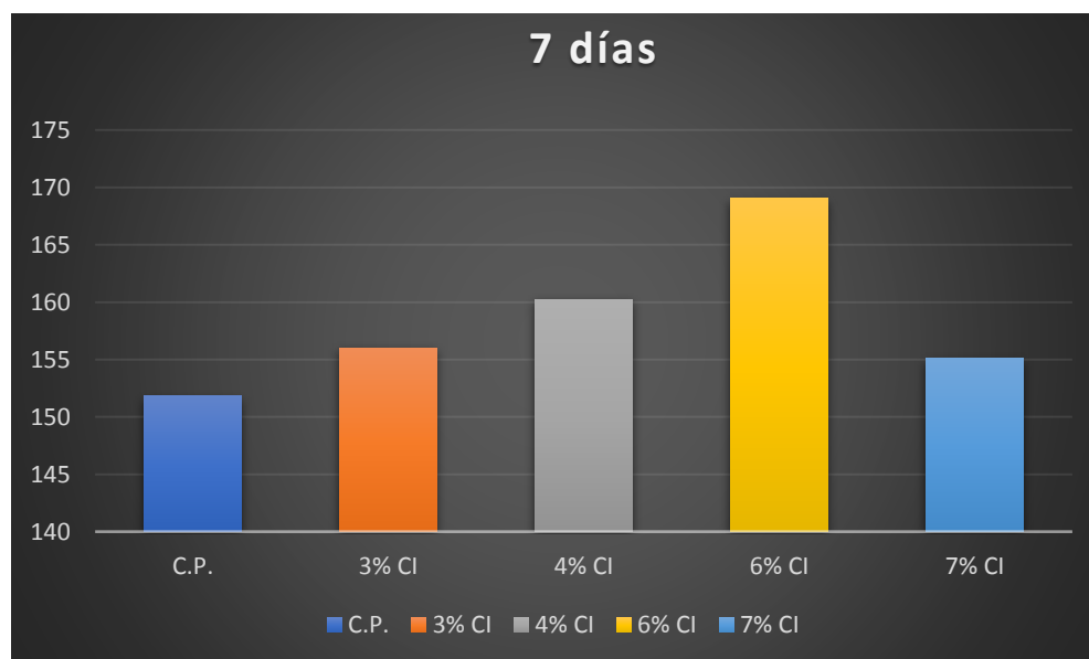
Figura N°32. Grafica de resistencia promedio a compresión a los 7 días con ceniza de ichu.
