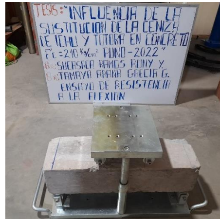
Foto 46: equipo para realizar el ensayo de flexión.
