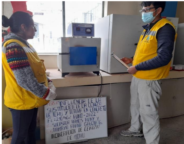
Foto 13: Calcinación en horno mufla.
