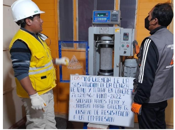
Foto 42: Ensayo a la compresión de probetas cilíndricas de concreto.
