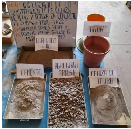
Foto 25: Materiales para mezcla de concreto
