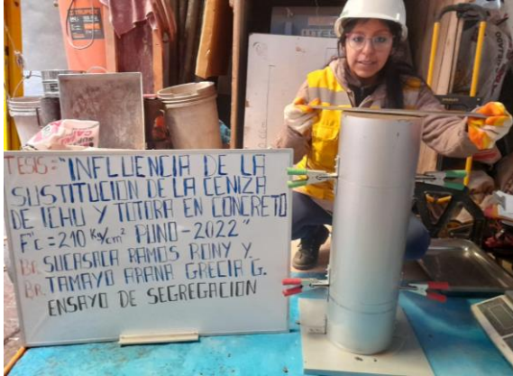
Foto 37: Ensayo de segregación del concreto.
