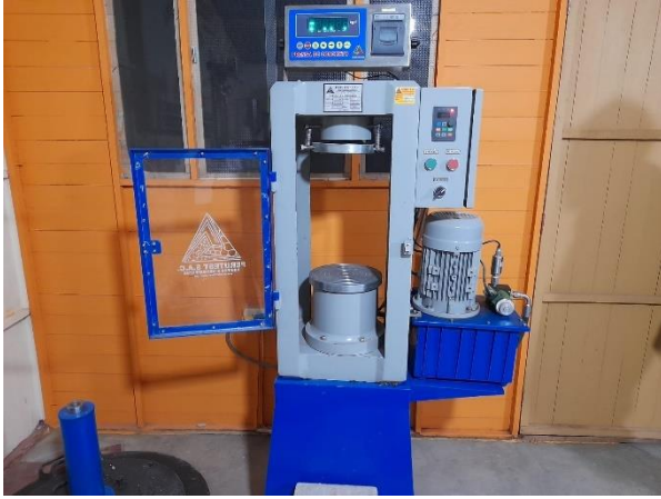
Foto 41: Prensa hidráulica para compresión de testigos de concreto.
