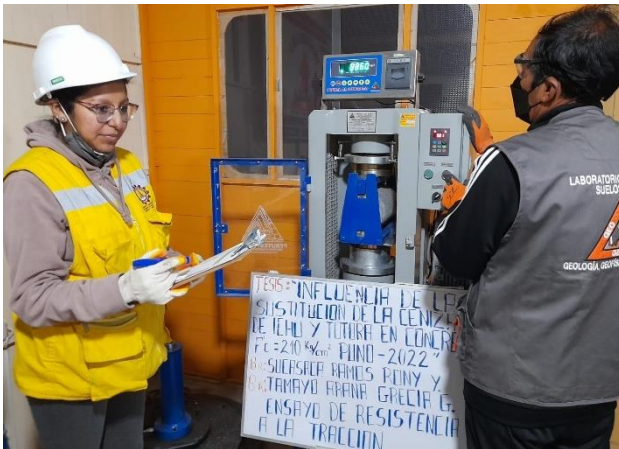
Foto 41: Prensa hidráulica para compresión de testigos de concreto.
