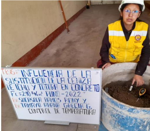
Foto 29: Ensayo de medición de temperatura del concreto.
