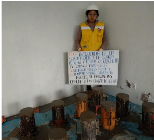
Foto 27: Moldeo de testigos cilíndricos de concreto.
