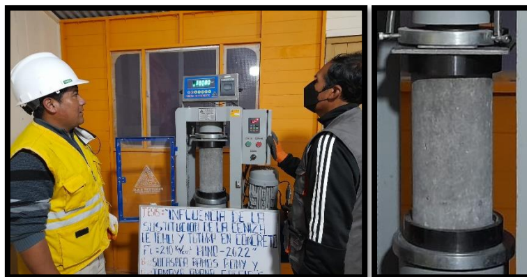
Figura N°31: Ensayo de esfuerzo a compresión.
