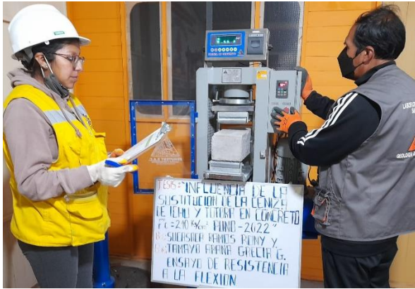
Foto 45: Ensayo de resistencia a flexión en vigas de concreto.
