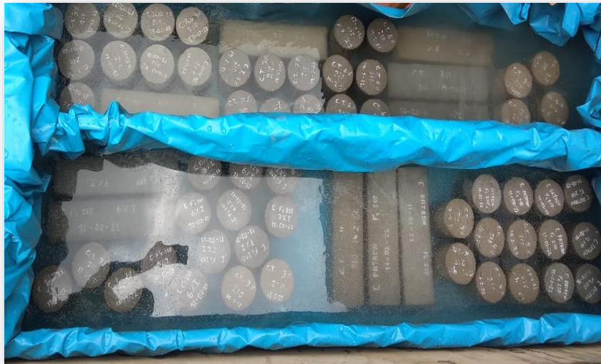
Figura N°17: Curado de testigos de concreto.
