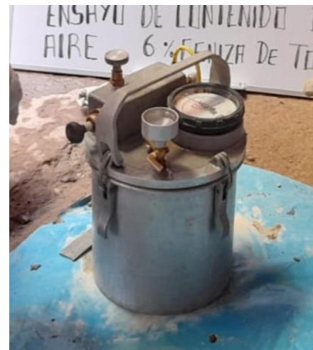
Foto 34: Equipo para medición de contenido de aire.
