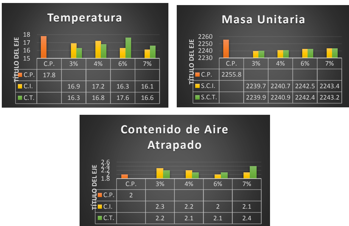
Figura N°66. Gráfico de resultados de temperatura, masa unitaria y contenido de aire atrapado con sustitución ceniza de ichu y totora.
