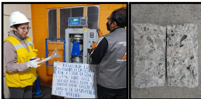
Figura N°39: Ensayo de esfuerzo a la tracción.
