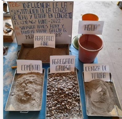
Figura N°50: Dosificación del concreto.
