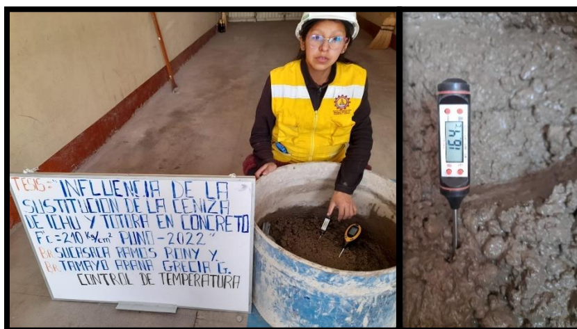
Figura 19: Ensayo de medición de temperatura del concreto.
