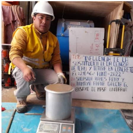
Foto 35: Ensayo de masa unitaria del concreto.
