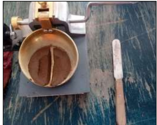
Figura 26: Ensayo de Casagrande Fuente: Elaboración propia
