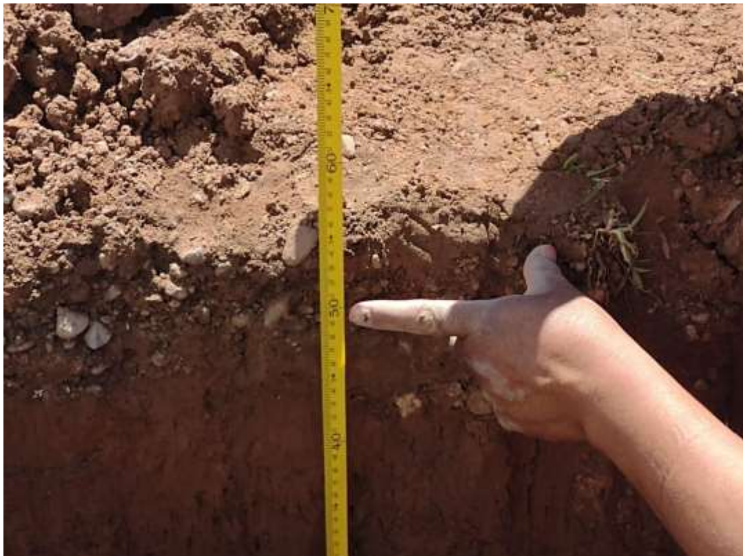
Fotografía 02. Apertura de calicatas a 1.50 m
