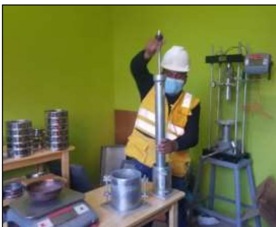
Figura 22: Ensayo de Proctor Modificado Fuente: Elaboración propia
