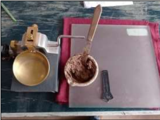
Figura 25: Ensayo de Casagrande Fuente: Elaboración propia
