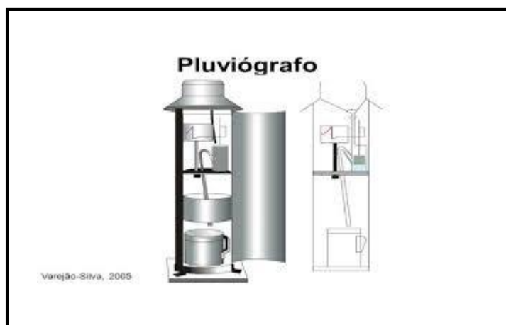
Figura N° 01 Pluviografo fuente Hidrologiaaplicada.com
