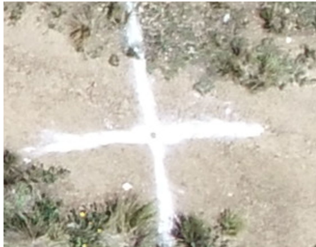
Figura 58. Vista de punto de foto control al inicio de vuelo altura 40 m.
