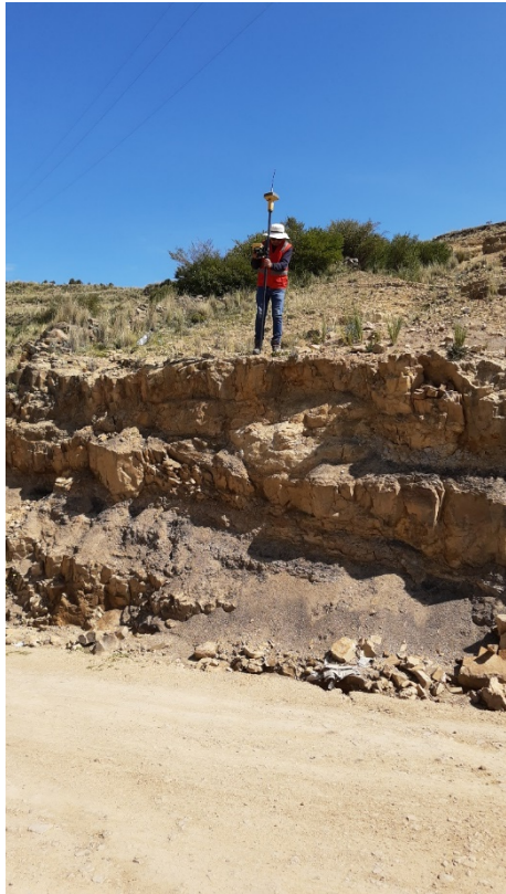
Figura 21. Obtención de datos modo RTK margen derecho
