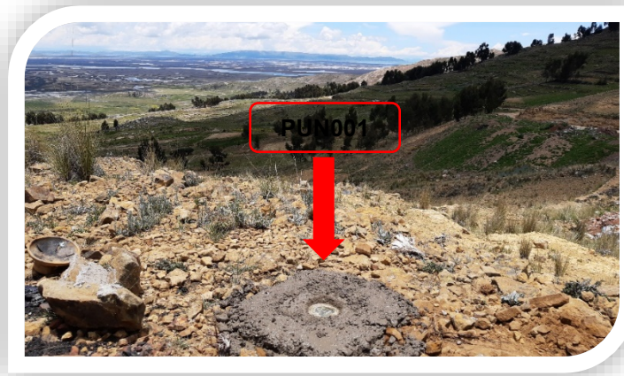
Figura 11, Monumentación de Punto Geodésico PUN001
