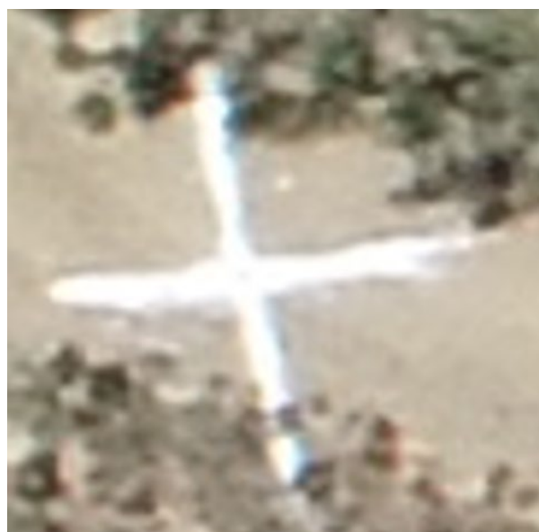
Figura 59. Vista de punto de foto control al inicio de vuelo. Altura 120 m.
