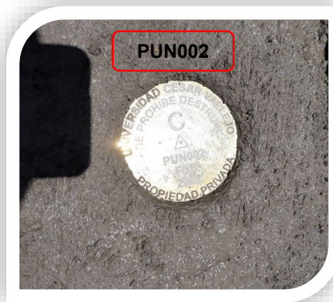
Figura 12, Monumentación de Punto Geodésico PUN002
