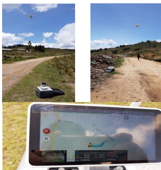
Figura 39. Vuelos fotogramétricos a diferentes alturas.
