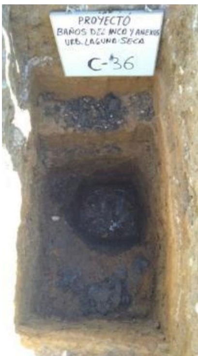
Foto 3: Calicata a 3m de profundidad.
