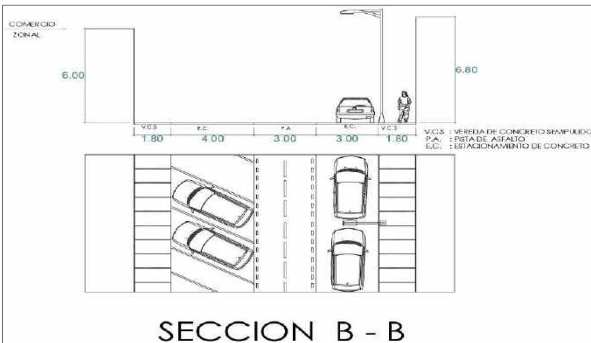
figura 49.Corte vial, Jirón del Álamo y mercado Edén de Monterrico. fuente propia. (2019).
