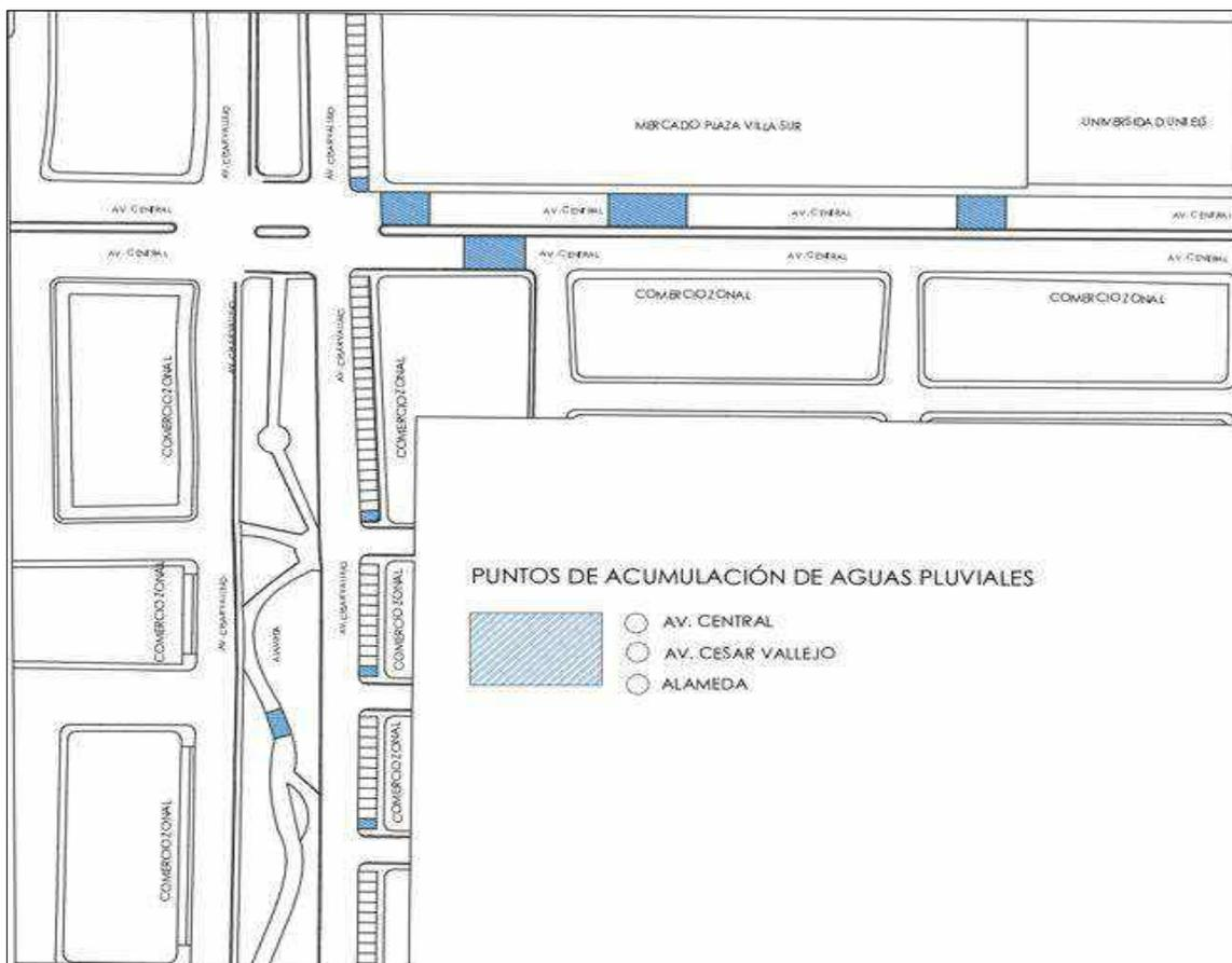
figura 44. Plano de puntos de acumulación de aguas pluviales. Fuente propia. (2019).
