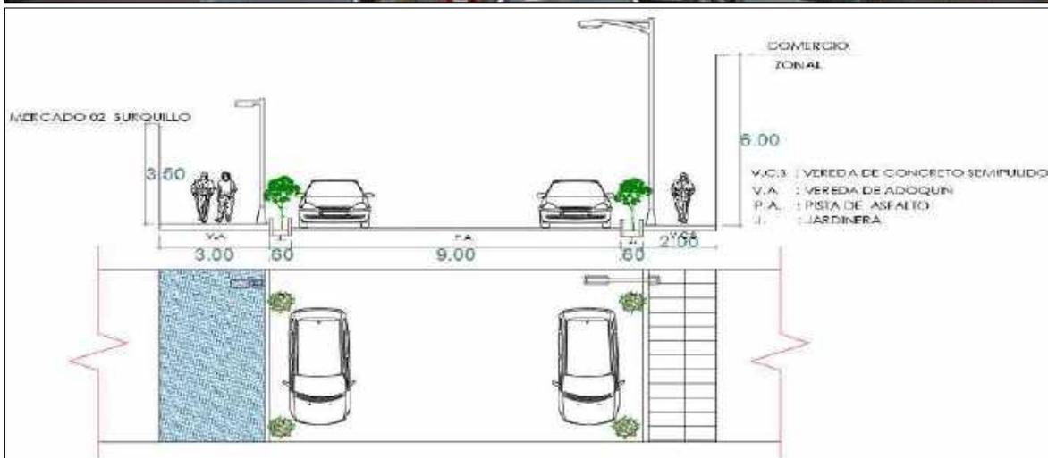
figura 60. Corte vial de Jirón Dante, fuente propia. (2019).
