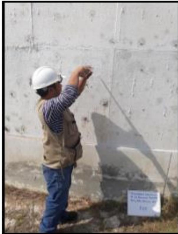
**Imagen N°11: Ensayo de esclerometría a cargo del Ing. Wilson Zelaya del laboratorio Corporación Geotecnia SAC**
