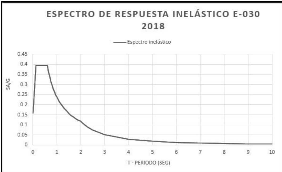
Figura N° 27: Espectro de respuesta inelástico E-030 2018
