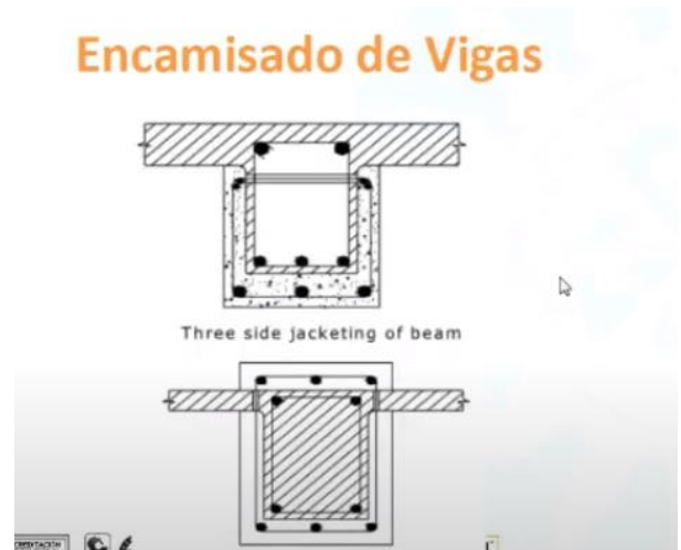
Figura 39. Detalle de encamisado en Vigas.
