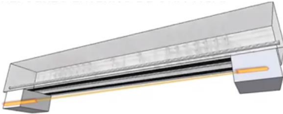
Figura 12. Refuerzo por flexión
