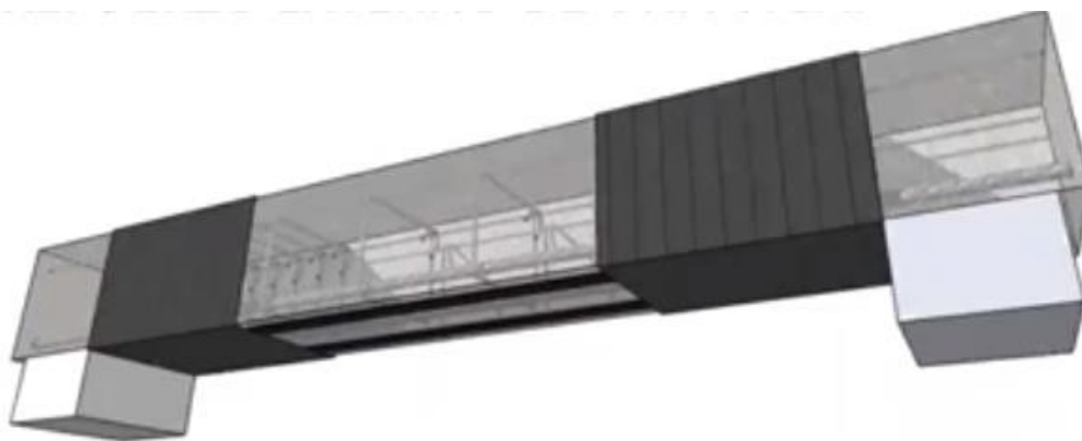
Figura 13. Refuerzo por Cortante
