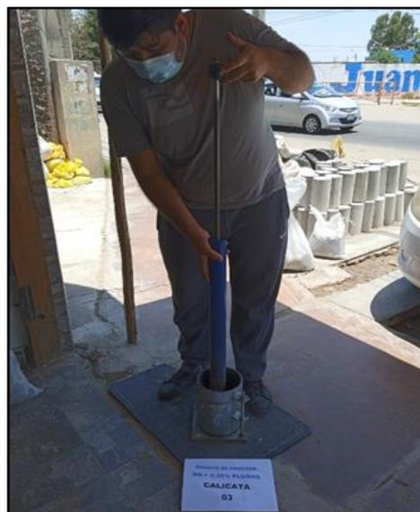
**Figura 13.** Ensayo Proctor Modificado
