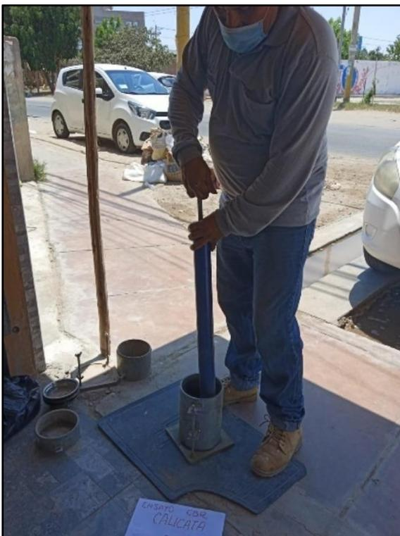
6.3 Ensayo de Proctor C1
