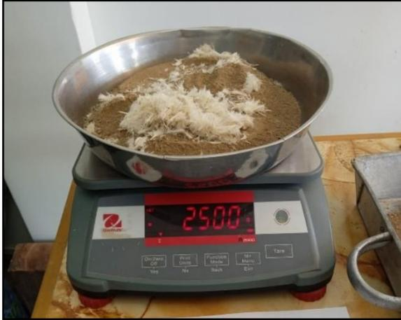
**Figura 15.** Peso del material para el ensayo de CBR
