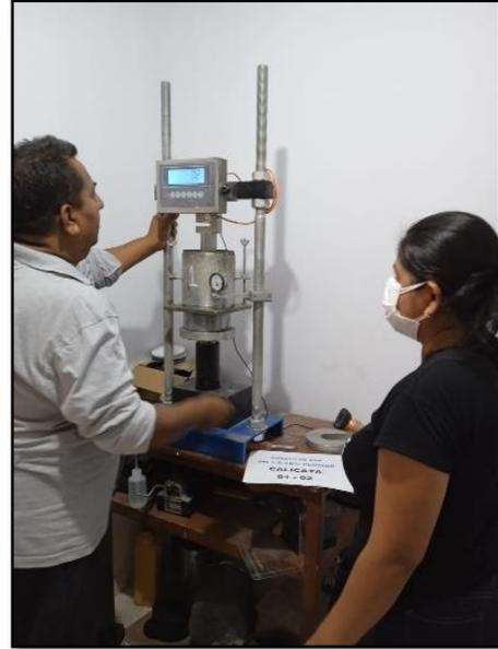
**Figura 16.** Aplicación de la carga sobre pistón de penetración
