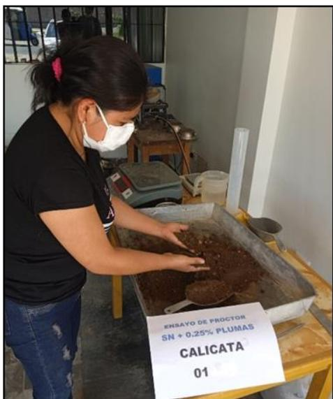
**Figura 12.** Agregado de agua al suelo natural
