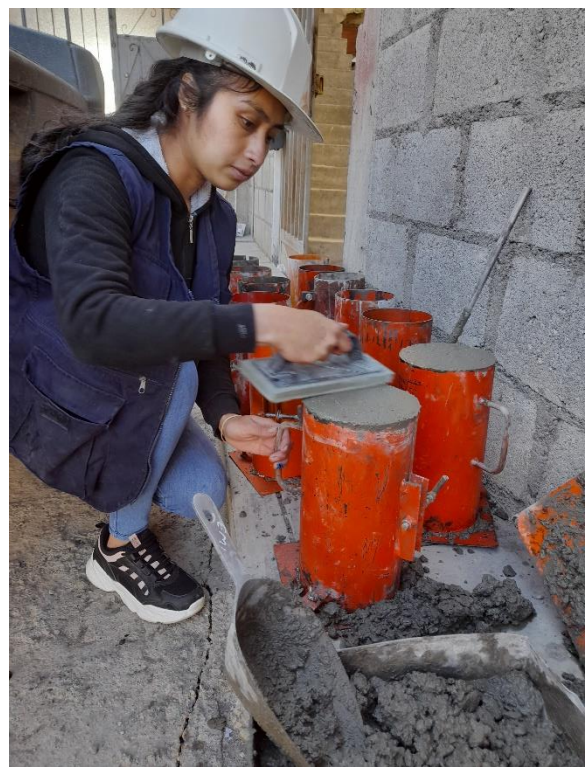
Figura 32. Pulido del concreto para obtener una superficie lisa y plana
