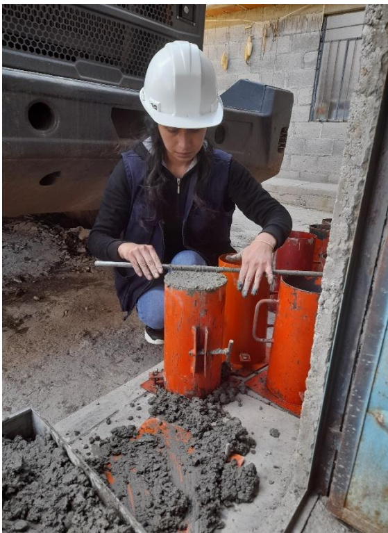
Figura 31. Enrasado del exceso de mezcla.
