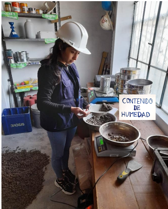
Figura 13. Muestra para ensayo de contenido de humedad.
