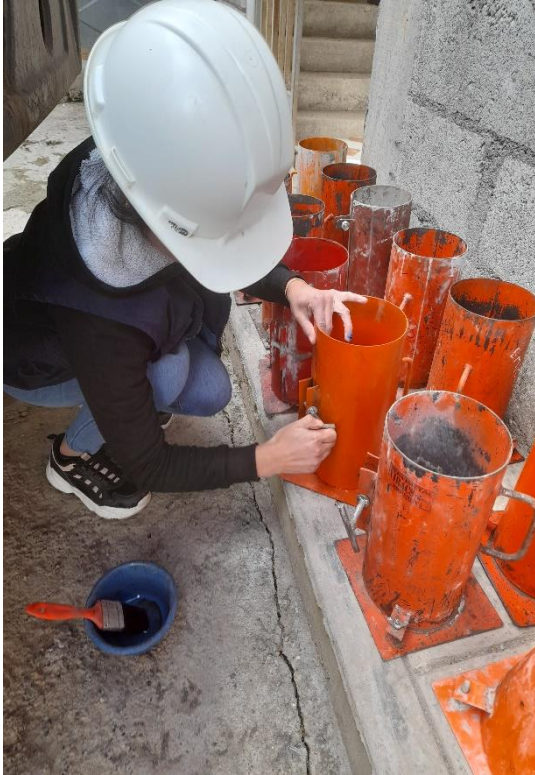
Figura 25. Ajuste de los pernos del molde cilíndrico.
