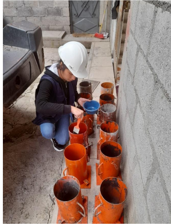
Figura 26. Engrase de la superficie interior de los moldes.
