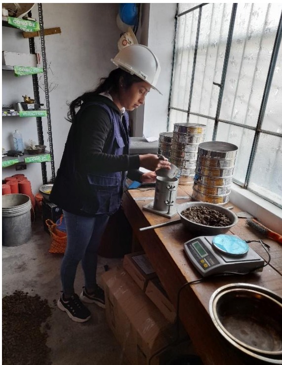
Figura 15. Ensayo del peso unitario compactado.
