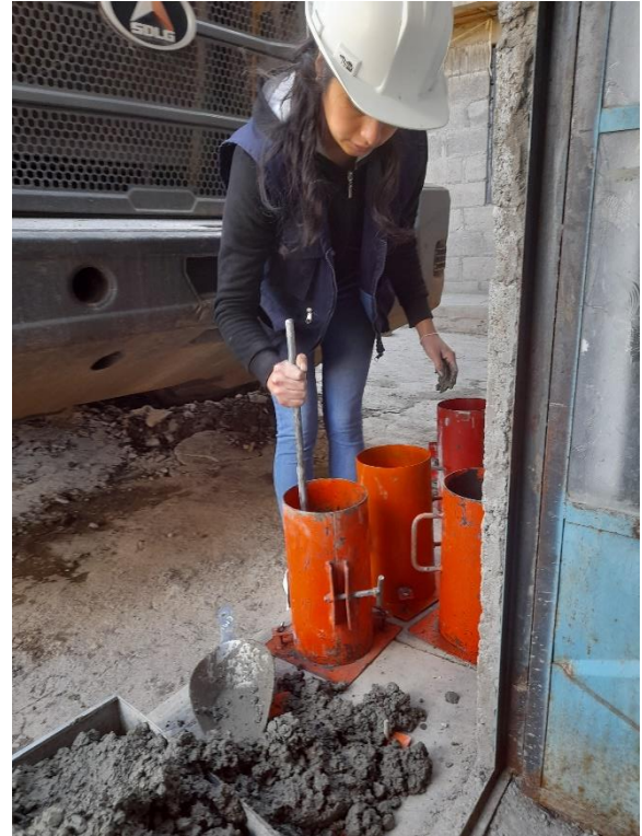
Figura 30. Chuzeado de la mezcla de concreto.
