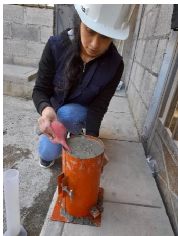
Figura 20. Muestra de concreto para ensayo de exudación.
