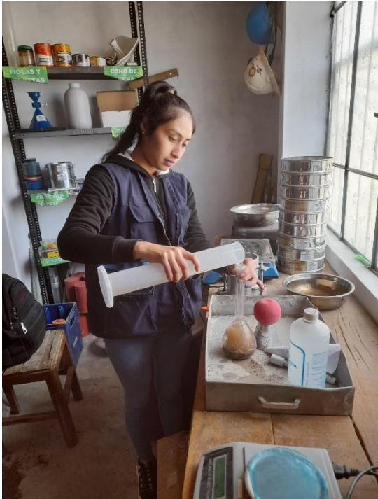
Figura 21. Vaciamos el agua a la fiola, y mezclamos con la muestra seca.
