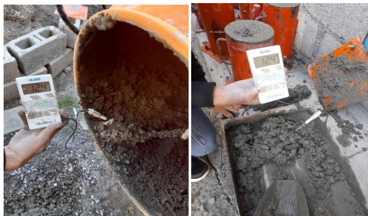
Figura 25. Ensayo de temperatura del concreto.
