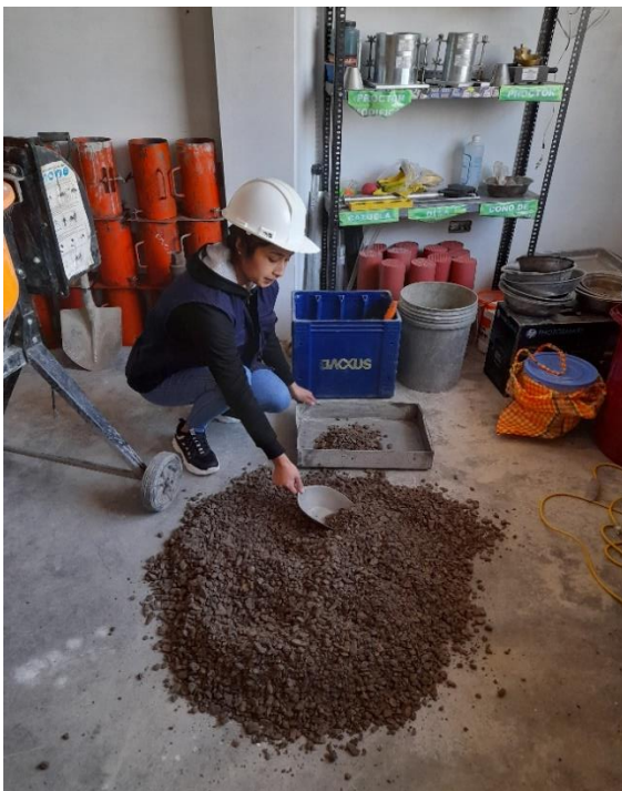
Figura 11. Toma de muestras del agregado para los ensayos.
