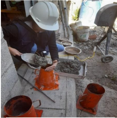
Figura 15. Muestra de concreto para el ensayo de slump.
