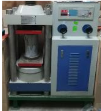
Figura 28. Rotura de las probetas a compresión.
