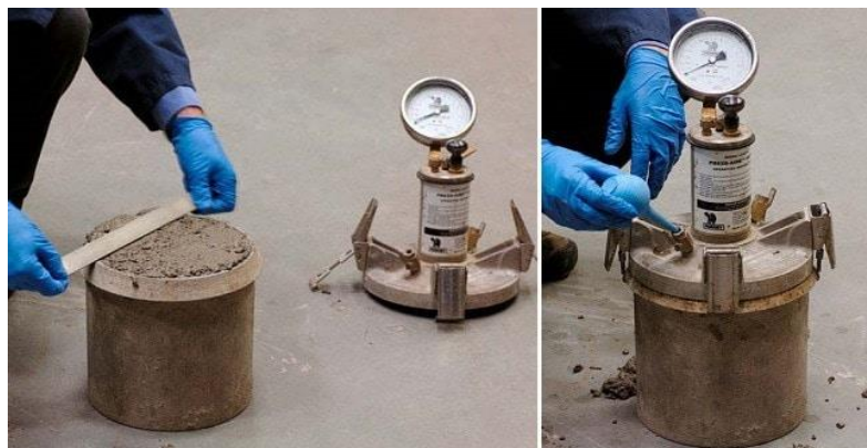
Figura 4. Prueba de contenido de aire en el concreto. Fuente: Cotecno.
