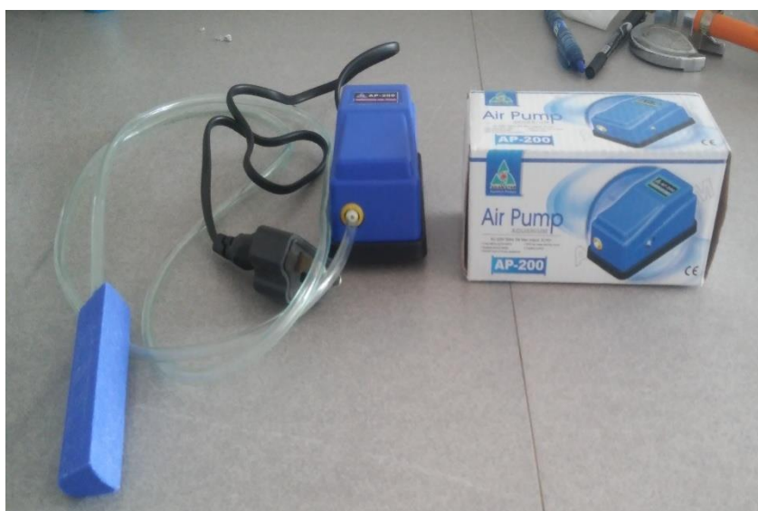
Fuente: Foto tomada por el investigador. Figura 19 - Bomba de Aire.
