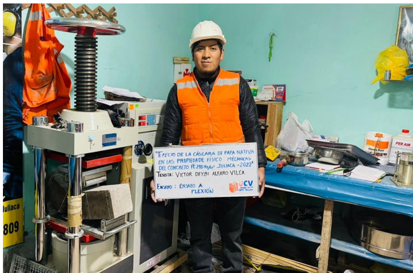
Figura 39: Ensayos de flexión en vigas a los 28 días
