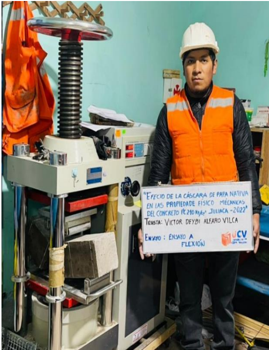
Se aprecia el proceso de ensayo a flexión de las viguetas prismáticas.
