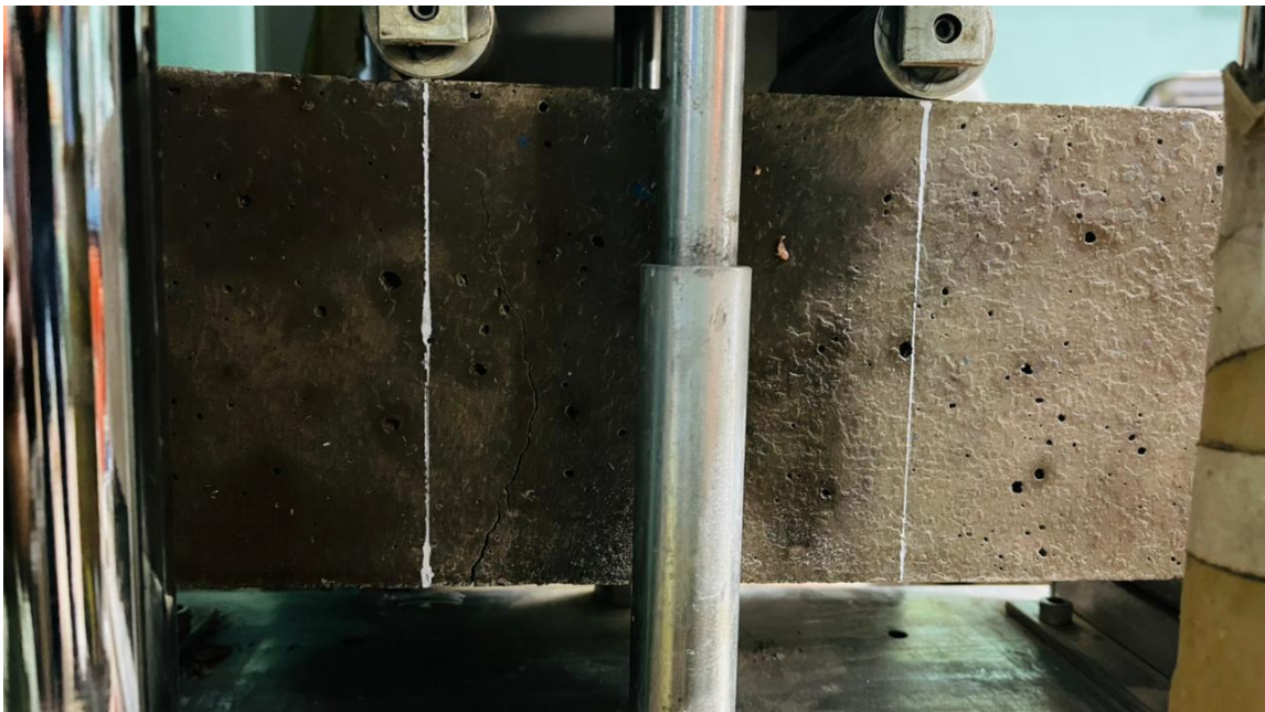
Se aprecia el proceso de ensayo a flexión de las viguetas prismáticas.
