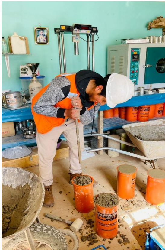
Figura 17: Preparación del concreto cumpliendo el diseño
