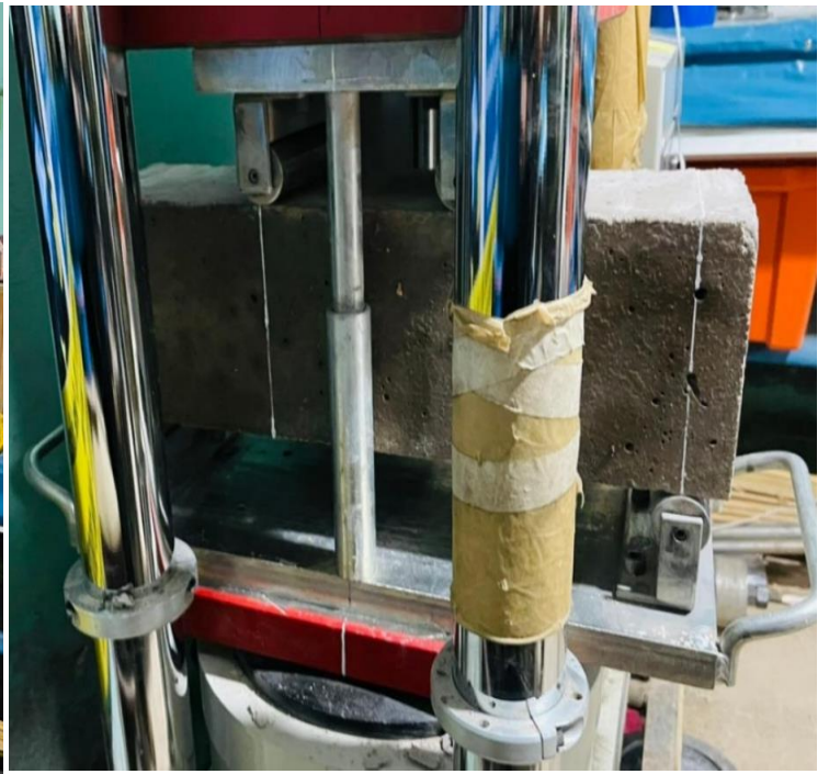
Se aprecia el proceso de ensayo a flexión de las viguetas prismáticas.
