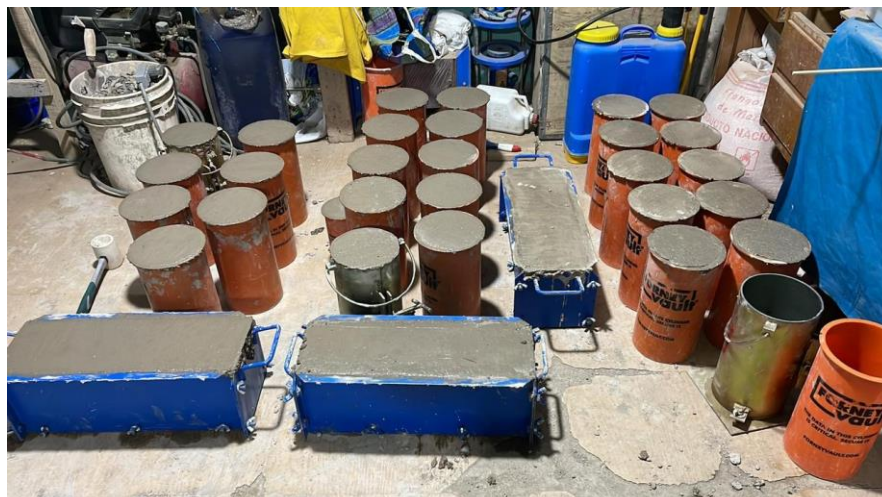
Figura 18: Preparación de briquetas en los moldes de 4"x 8" y vigas prismáticas
