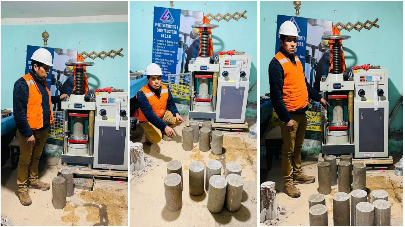
Se aprecia el proceso de ensayo a compresión de los testigos.
