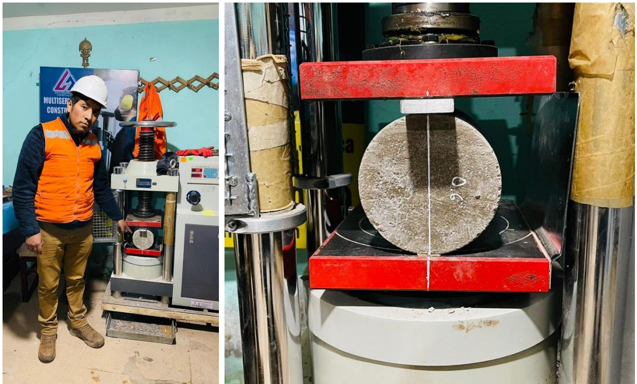
Se aprecia el proceso de ensayo a compresión de los testigos.
