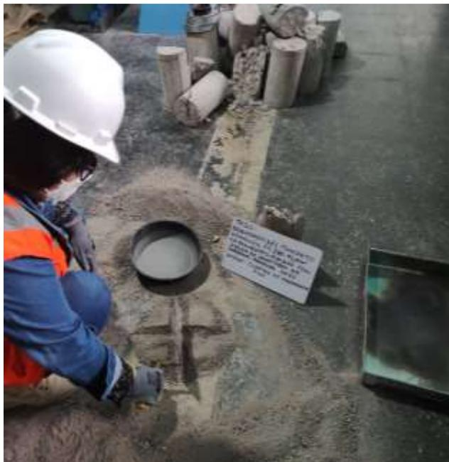
*Figura 6.* Cuarteo de Agregado Fino
