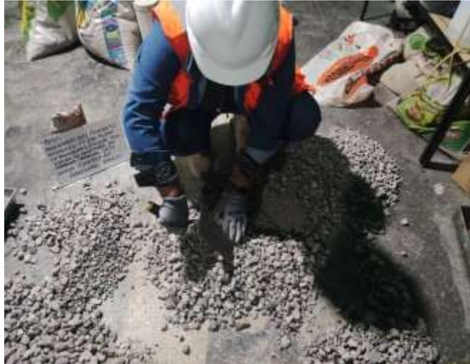
*Figura 7. Cuarteo de Agregado Grueso*
