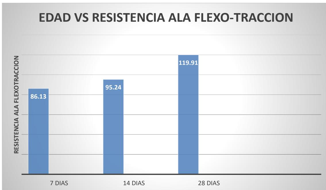
Figura 28. Resistencia a la flexo-tracción por edades al 10%
