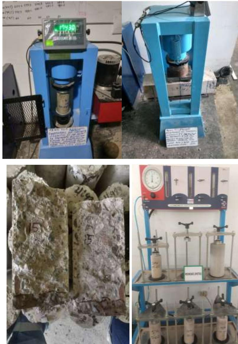
*Figura 21. Ensayos a la Resistencia a la Compresión, flexo-tracción, permeabilidad y abrasión*
