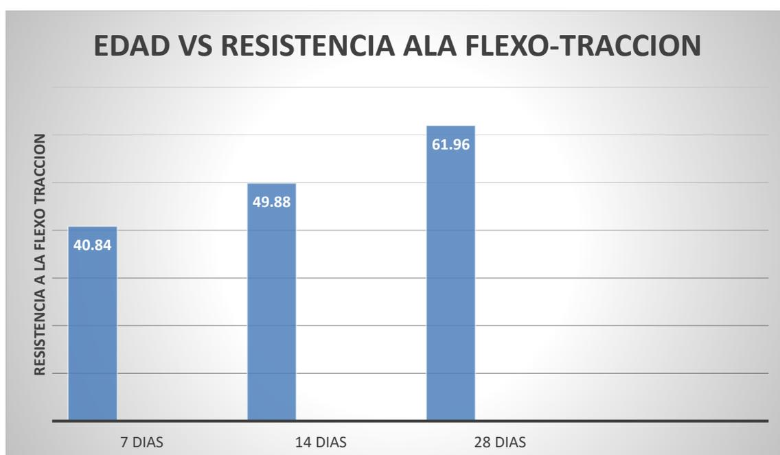
Figura 26. Resistencia a la flexo-tracción por edades al 0%
