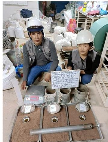
*Imagen 34. Ensayo de CBR suelo natural con aditivo terrasil + CHE.*
