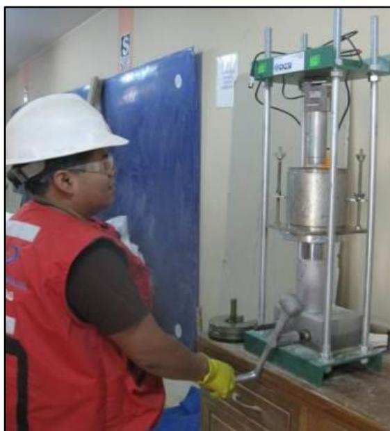
Figura 17. Ensayo de CBR en laboratorio.
