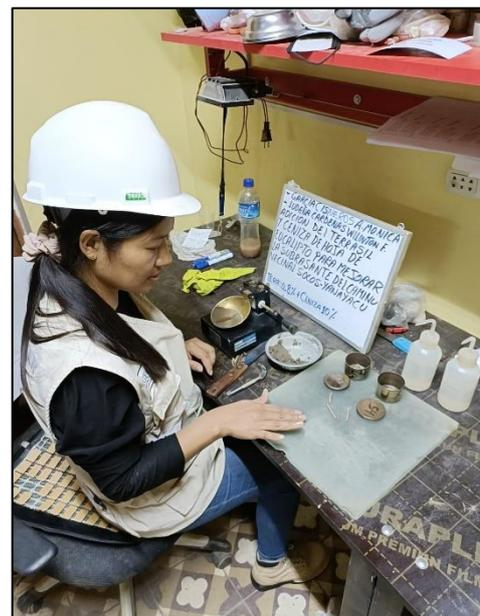
Figura 33. Ensayo de plasticidad con adición de terrasil y ceniza de hojas de eucalipto.
