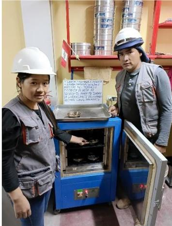
*Imagen 31. Secado en horno para cálculo del OCH.*
