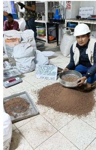
*Imagen 16. Preparación de la muestra para el ensayo de Proctor.*
