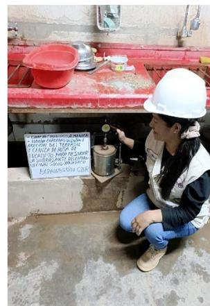
*Imagen 48. Medición de expansión del molde de CBR.*
