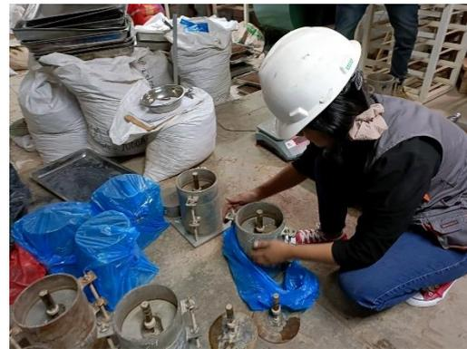
*Imagen 46. Proceso de aislamiento de los moldes de CBR.*
