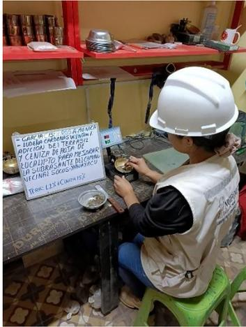
Imagen 19. Ensayo de limite líquido.
