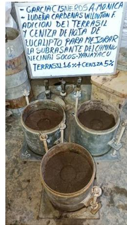
*Imagen 44. Muestra después del ensayo de CBR.*
