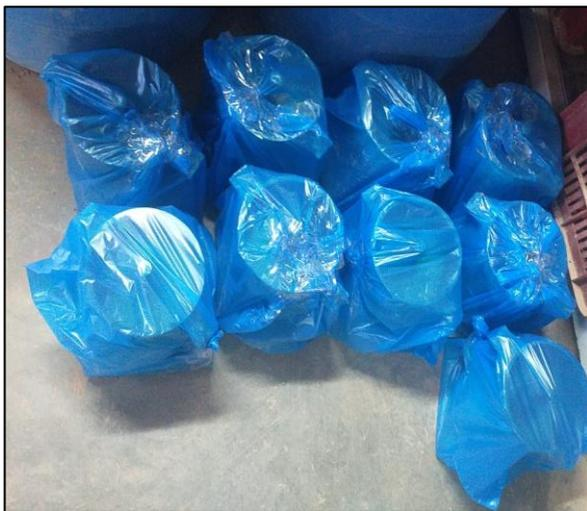
Figura 47. Curado de muestras con adición de terrasil (0.8 lt/m<sup>3</sup>, 1.2 lt/m<sup>3</sup> y 1.6 lt/m<sup>3</sup>).
