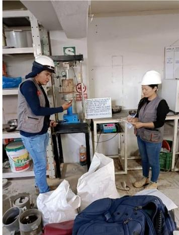
*Imagen 43. Ensayo de CBR en laboratorio.*
