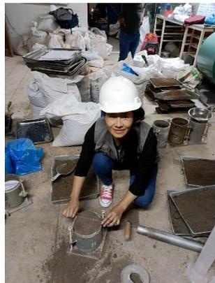
*Imagen 45. Ensayo de CBR en laboratorio.*
