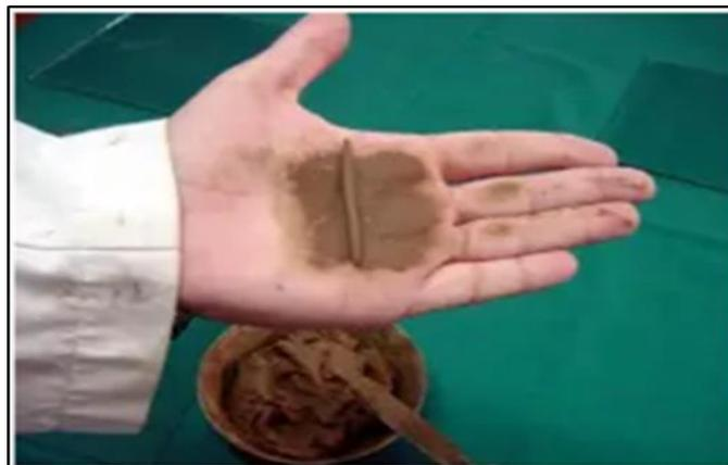
*Figura 12.* Prueba de limite plástico.
