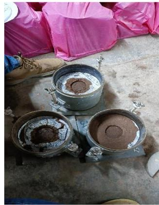
Imagen 40. Muestra después del ensayo de CBR.
