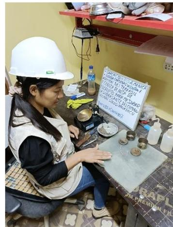
*Imagen 18. Ensayo de límite plástico*
