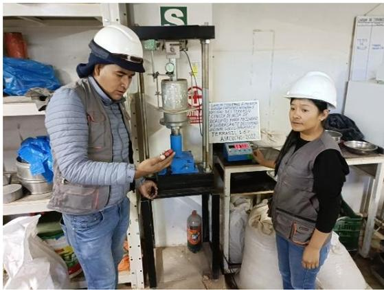
Imagen 39. Ensayo de CBR en laboratorio.
