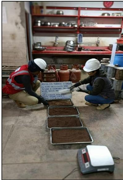
*Figura 35. Preparación de muestras para el ensayo de Proctor modificado.*
