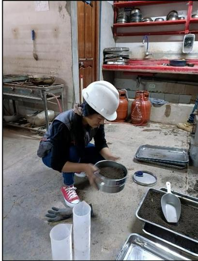
Figura 30. Preparación de muestras para el ensayo de plasticidad.
