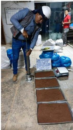
*Imagen 15. Ensayo de Proctor modificado en laboratorio.*
