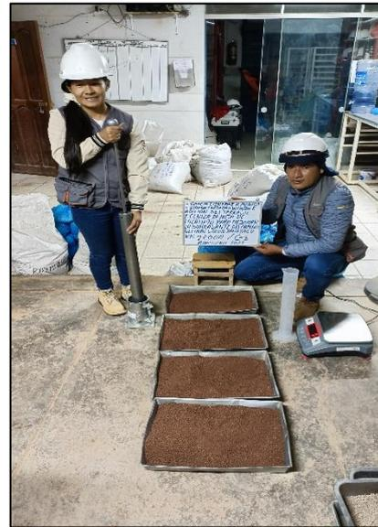
*Figura 36. Ensayo de Proctor modificado del suelo natural.*
