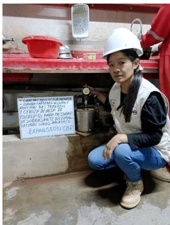
*Imagen 47. Medición de expansión del molde de CBR.*
