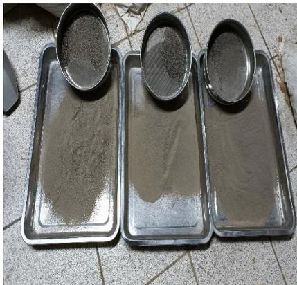
Imagen 23. Tamizado de la ceniza de hojas de eucalipto.
