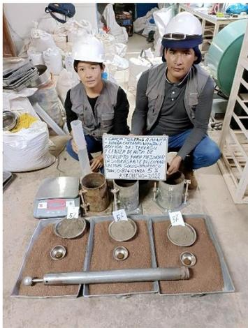
*Imagen 33. Ensayo de CBR suelo natural con aditivo terrasil + CHE.*
