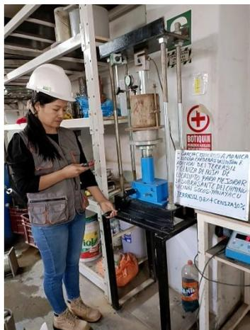
Imagen 41. Ensayo de CBR en laboratorio.
