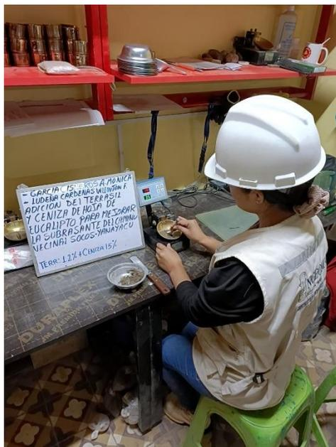
Figura 32. Ensayo de plasticidad con adición de terrasil (0.8 lt/m<sup>3</sup>, 1.2 lt/m<sup>3</sup> y 1.6 lt/m<sup>3</sup>).
