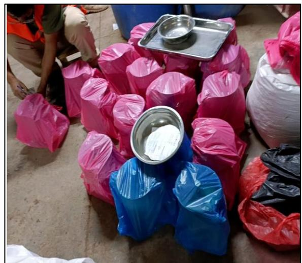
Figura 48. Curado con adición de terrasil y ceniza de hojas de eucalipto.
