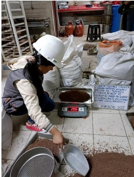
*Figura 40. Preparación de muestras para el ensayo de Proctor modificado.*
