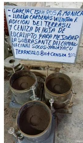
Imagen 42. Muestra después del ensayo de CBR.
