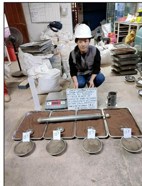
*Figura 38. Obtención del OCH con adición de terrasil y ceniza de hojas de eucalipto.*
