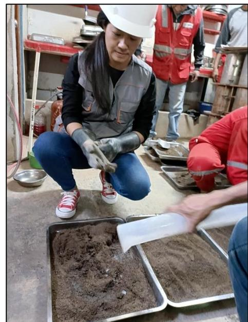
*Figura 43. Obtención de la MDS con adición de terrasil y ceniza de hojas de eucalipto.*
