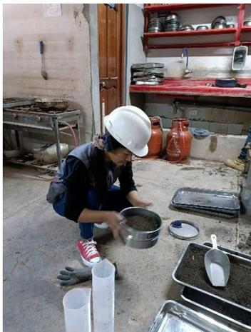
*Imagen 17. Obtención de muestra para el ensayo de plasticidad.*
