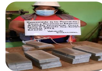
18. Prueba de variación dimensional.
