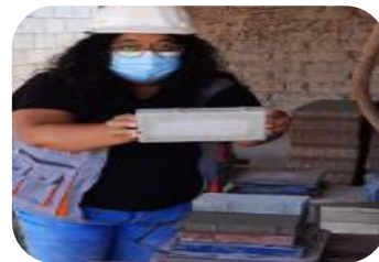
16. Desencofrado de adoquines
