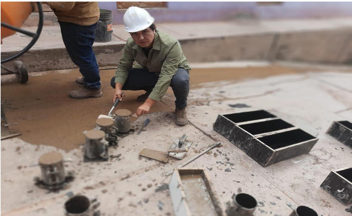
Figura 8. Elaboración de las probetas cilíndricas para los ensayos de absorción y compresión.
