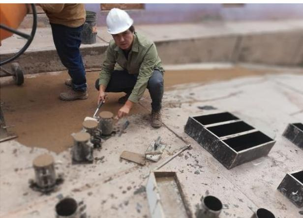
Figura 15. Extracción de probetas.
