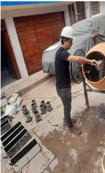
*Figura 08. Preparado de mezcla de concreto.*
