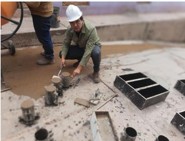
*Figura 19.* Extracción de probetas cilíndricas para el ensayo a compresión.
