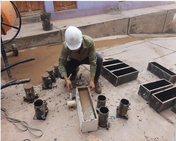
Figura 17. Extracción de vigas de concreto para el ensayo de flexión.
