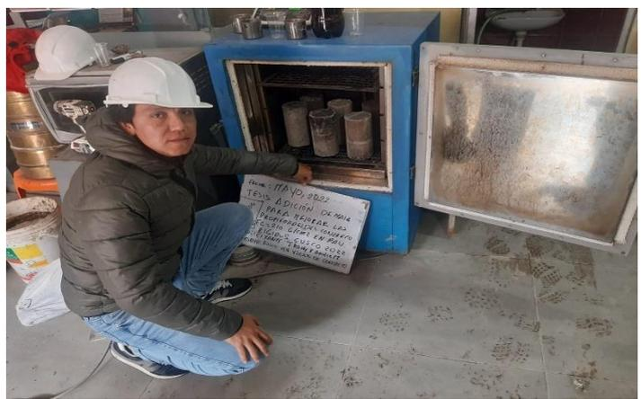
Figura 16. Colocado de probetas en el horno.
