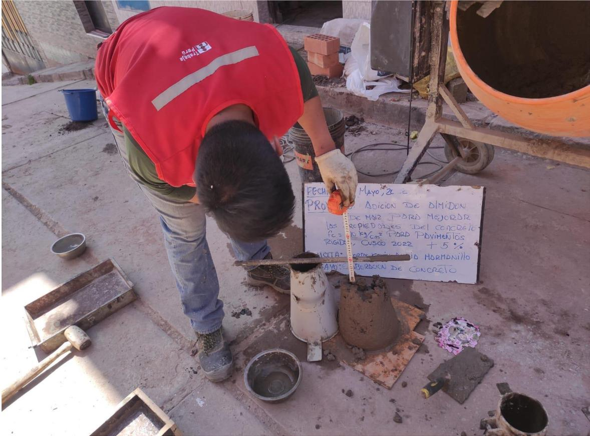
Figura 7. Prueba de slump.
