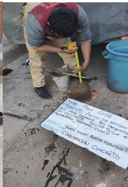
*Figura 10. Prueba de slump.*
