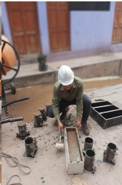
*Figura 09. Extracción de probetas de concreto.*
