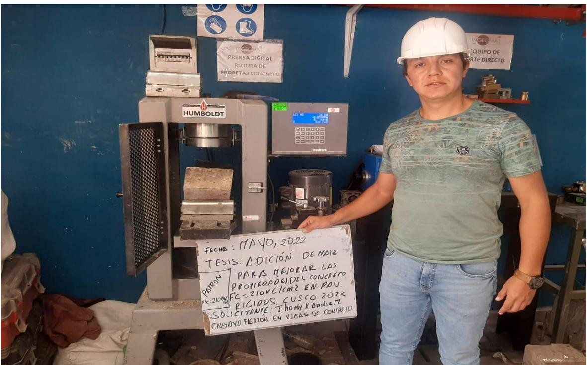
Figura 10. Rotura de viga prismática para obtención de la resistencia a flexión del concreto.
