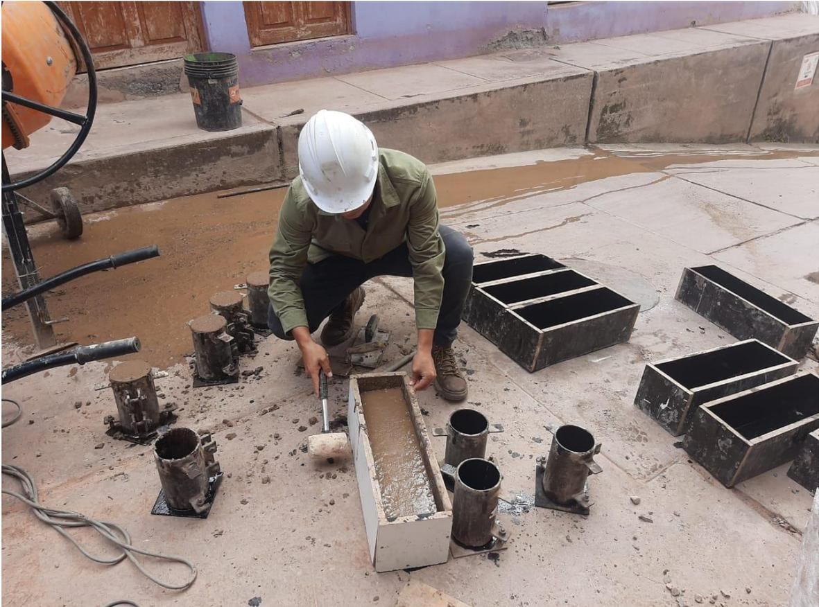
Figura 9. Elaboración de vigas de concreto para el ensayo de flexión.
