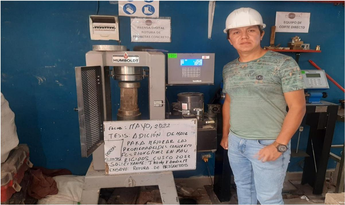
Figura 11. Rotura de probeta cilíndrica para obtención de la resistencia a compresión del concreto.
