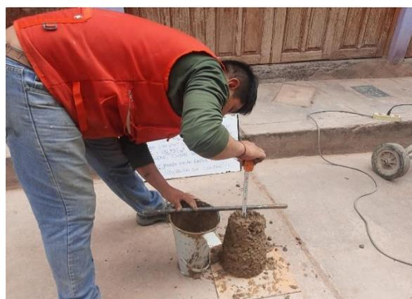
Figura 14. Medición del asentamiento del concreto.
