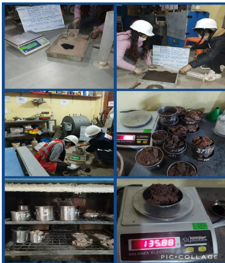
Figura 37. Procedimiento de secado y pesado de muestras con Biosólido.
