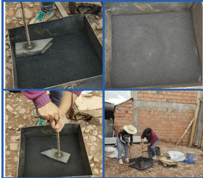
Figura 17. Trituración del Biosólido calcinado
