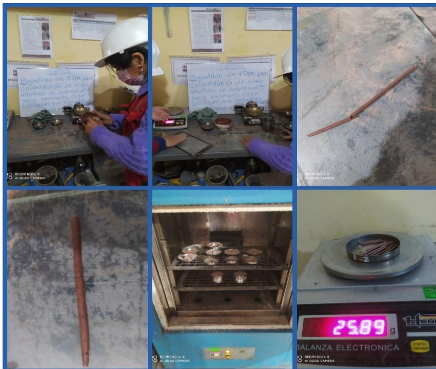
Figura 27. Limite Plástico - suelo natural
