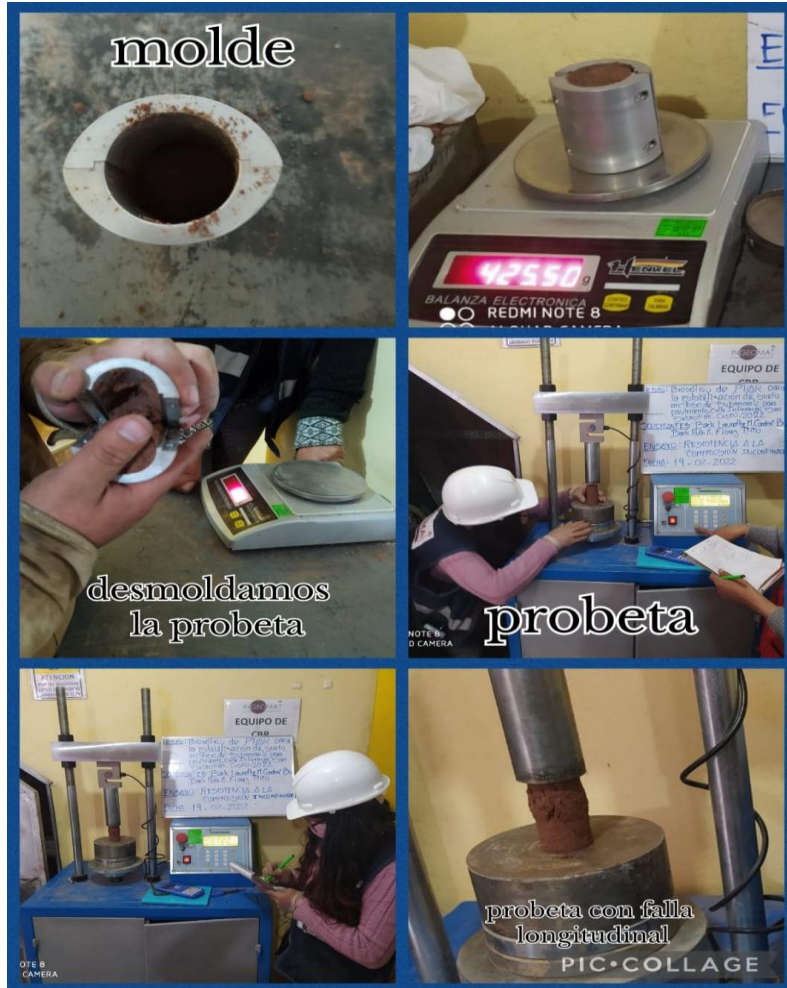
Figura 31. Resistencia a la compresión no confinada- suelo natural
