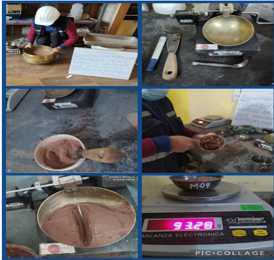
Figura 26. Limite liquido - suelo natural
