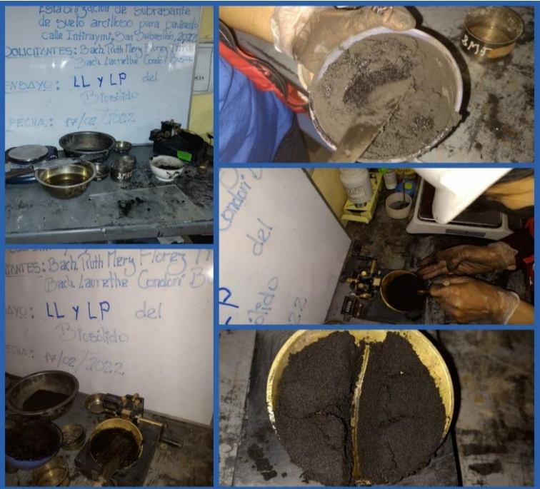
Figura 19. Limite Liquido del Biosólido.
