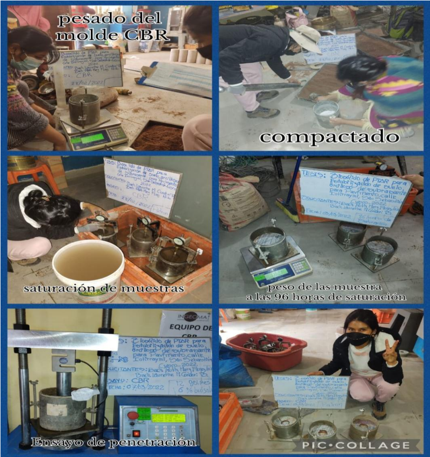
Figura 33. Procedimientos para ensayo de CBR- suelo natural
