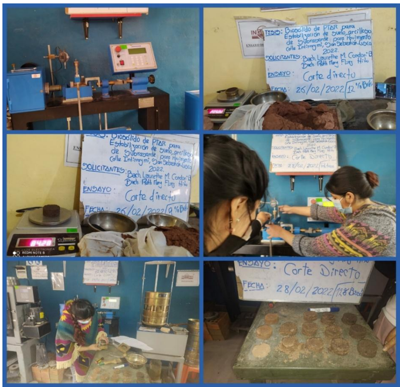
Figura 46. Ensayo de corte directo
