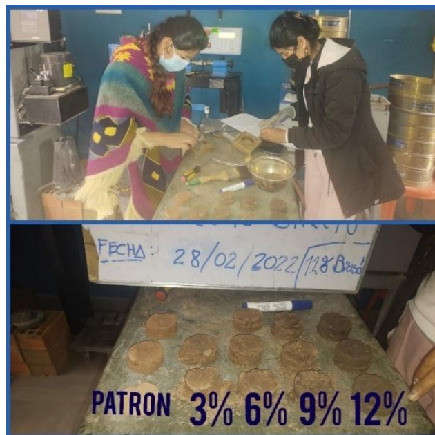
Figura 40. Cohesión con 3,6,9,12 % de Biosólido
