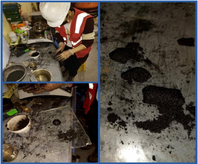
Figura 20. Limite Plastico del Biosólido.
