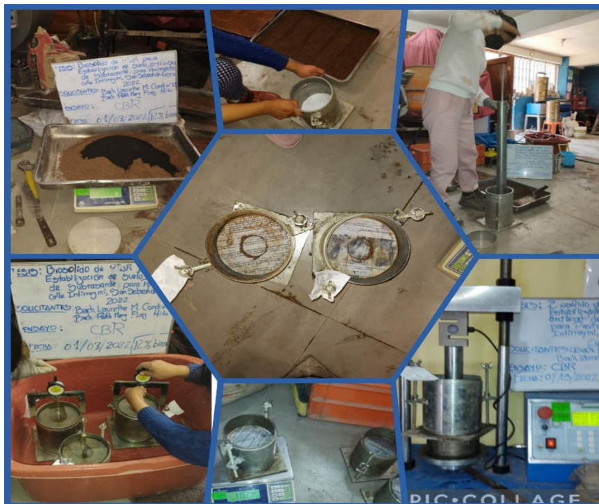
Figura 43. Procedimiento del Ensayo CBR con 3,6,9,12 % de Biosólido
