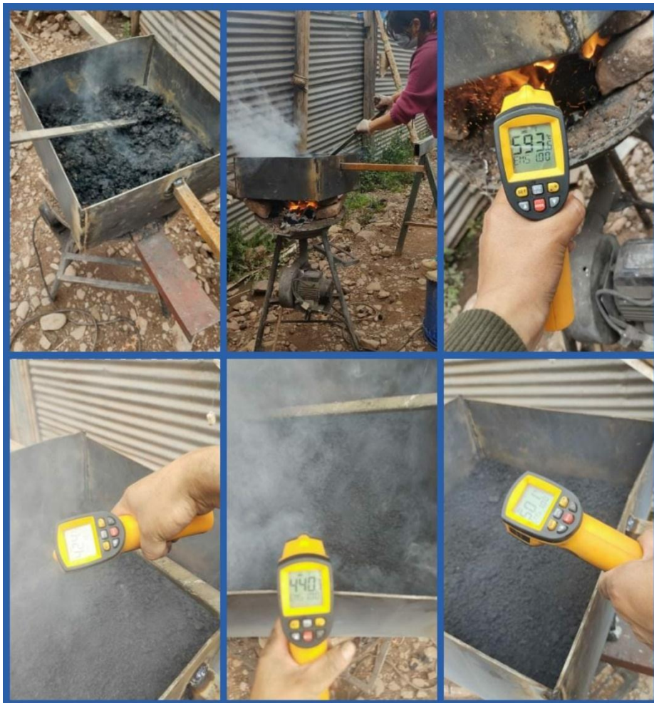
Figura 16. Calcinado del biosolido
