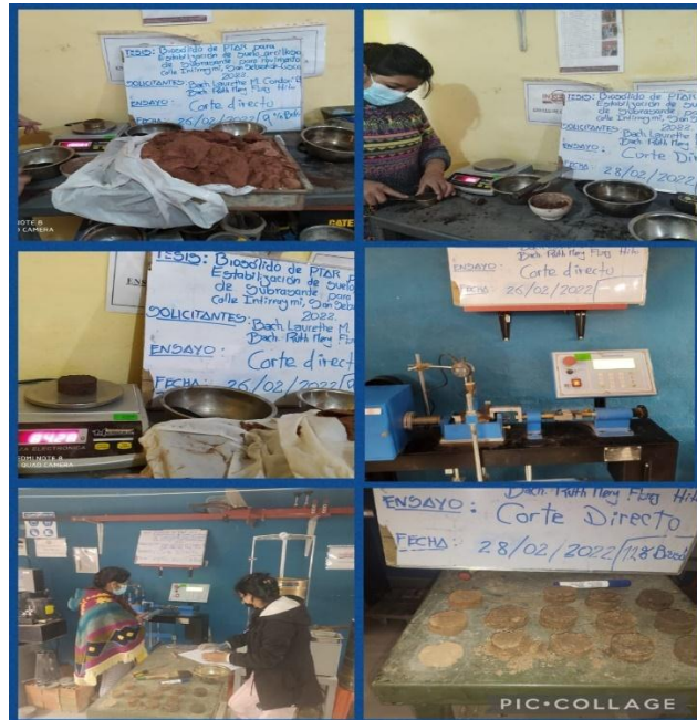
Figura 39. Muestras para la Cohesión con 3,6,9,12 % de Biosólido
