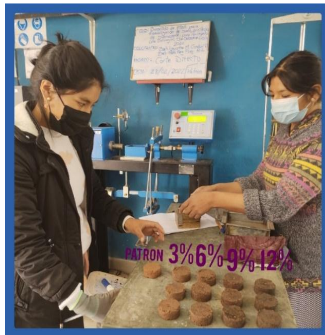
Figura 45. Moldes antes de realizar el ensayo de Corte Directo con 3, 6, 9 y 12% de Biosólido
