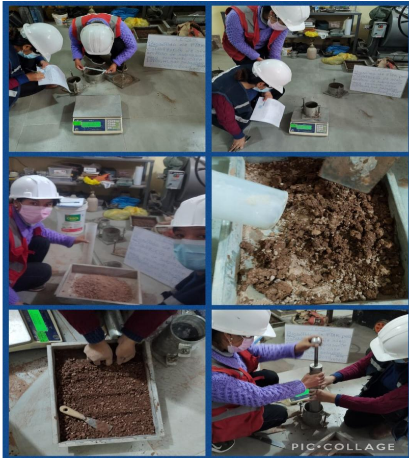
Figura 29. Proctor Estandar- preparacion de la muestra- suelo natural
