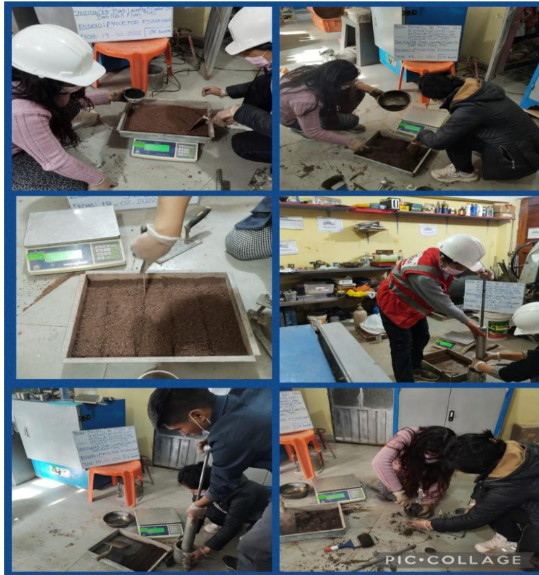
Figura 36. Procedimiento de Proctor estándar con 3,6,9,12 % de Biosólido
