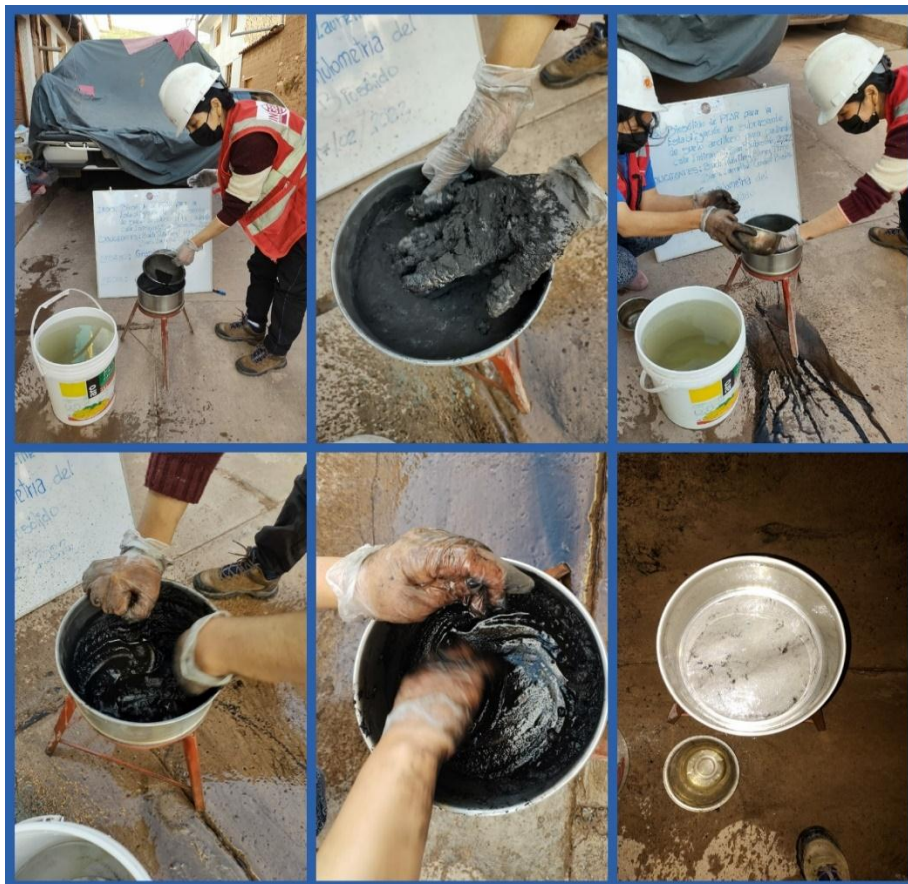
Figura 18. Tamizado del biosólido por la malla N°40.
