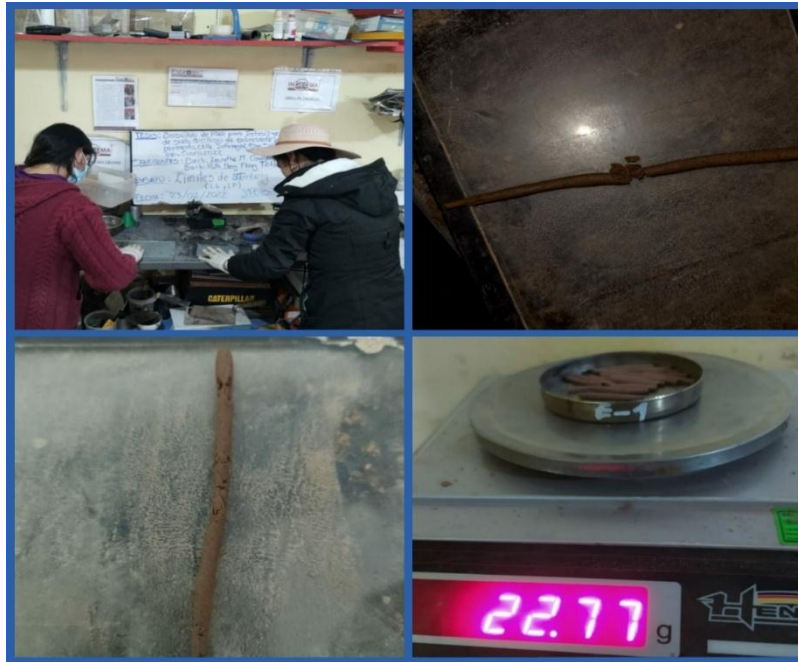
Figura 42. Limite plástico con 3,6,9,12 % de Biosólido
