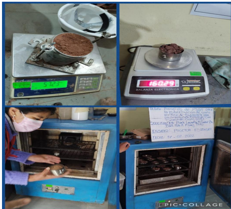
Figura 30. Proctor estándar compactado, pasado y llevado al horno.
