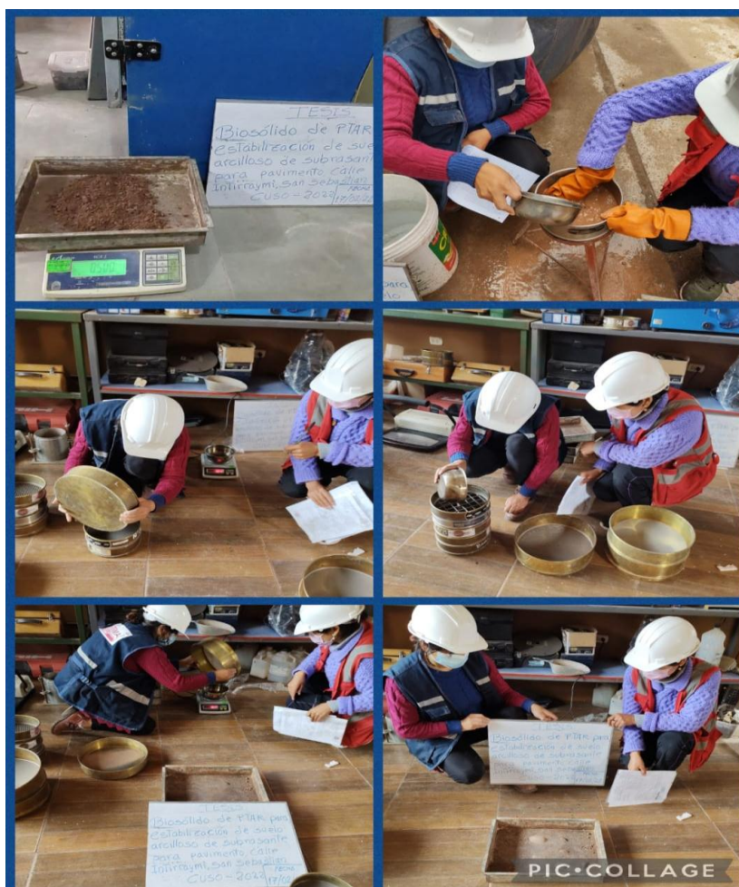
Figura 24. Analisis granulometrico - suelo natural.
