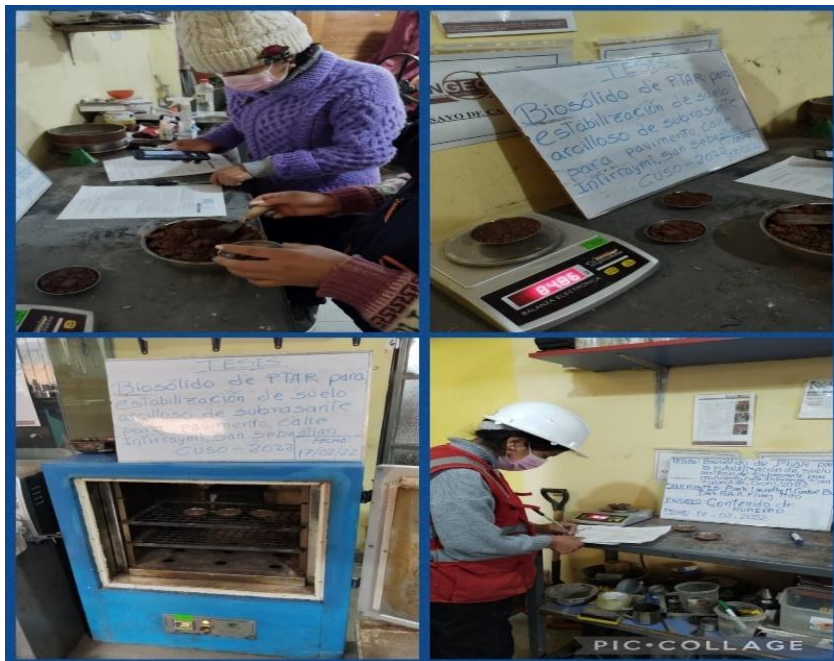
Figura 25. Contenido de humedad - suelo natural
