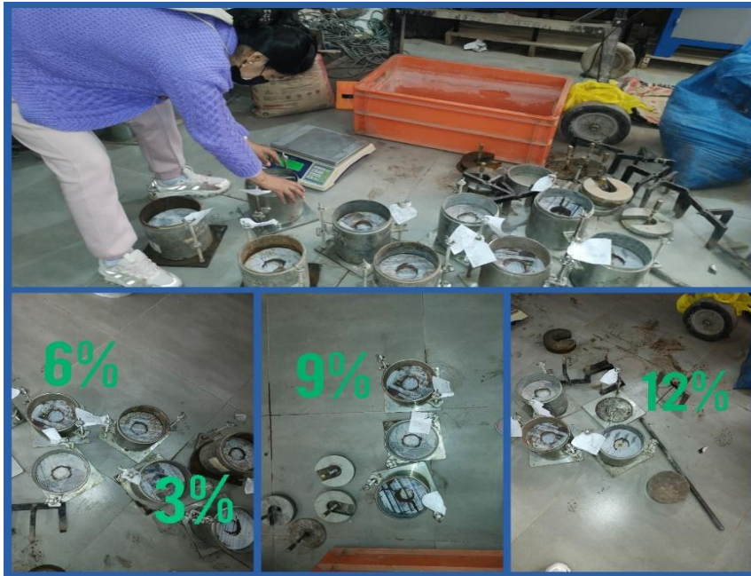
Figura 44. Moldes después de realizar el ensayo de penetración
